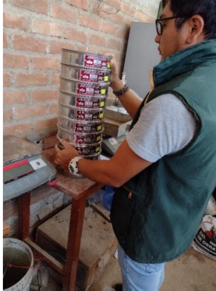
Figura 6 Tamizado de las muestras
