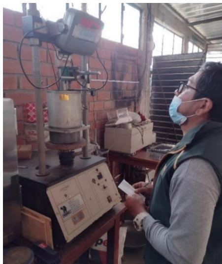
Figura 15 Lectura de carga con penetraciones
