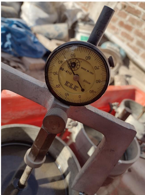
Figura 31 Tomando registro de deformímetro
