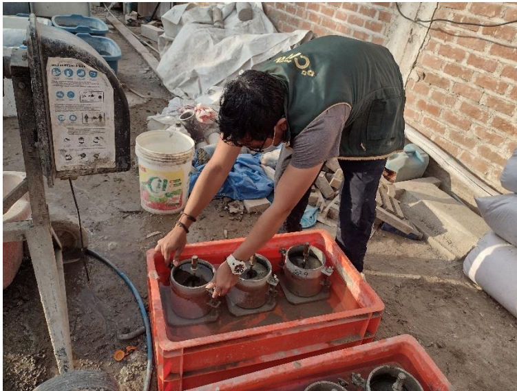
Figura 30 Sumergiendo los especímenes
