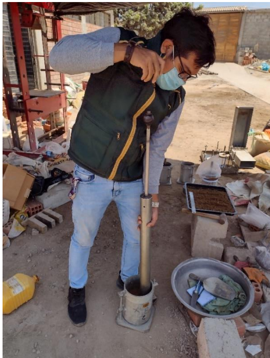
Figura 29 Ensayo de valor de soporte de California (CBR)
