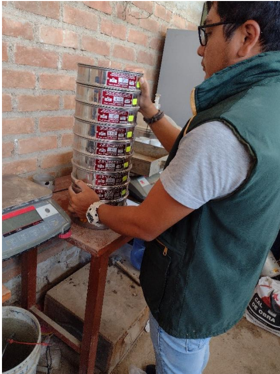
Figura 26 Ensayo de análisis granulométrico
