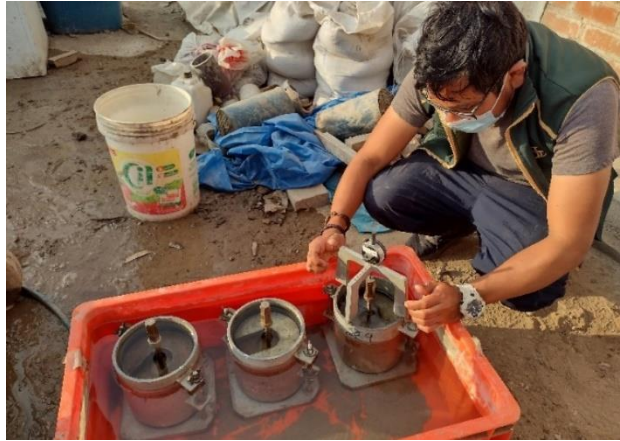
Figura 14 Lectura con el deformímetro
