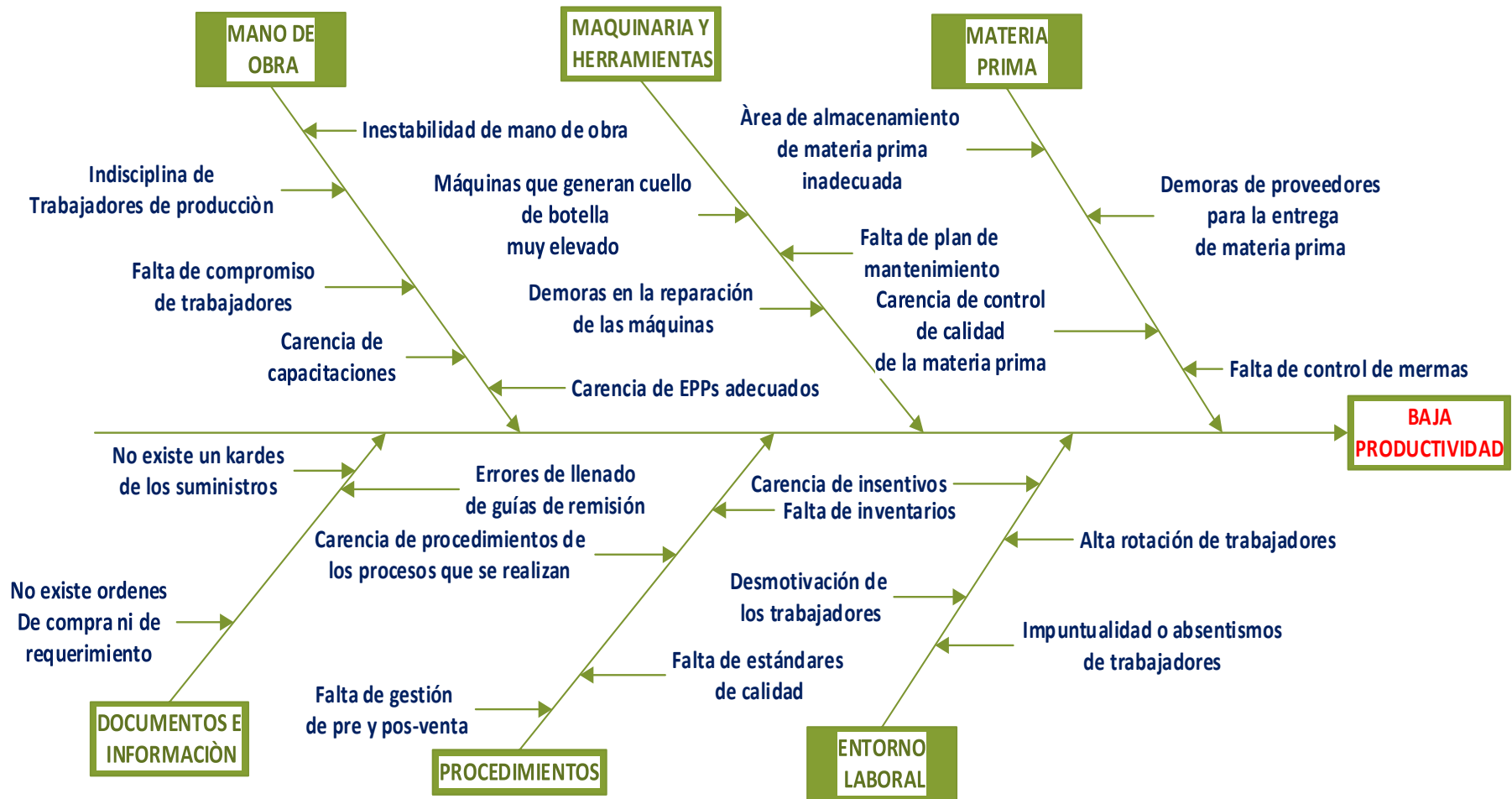
Figura 20. Problemáticas de la Empresa Planta Industrial Chemoto SAC
