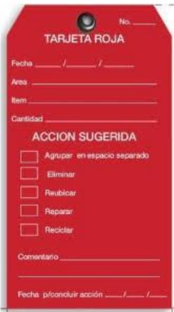
Figura 32: Tarjeta roja empleada en la clasificación
