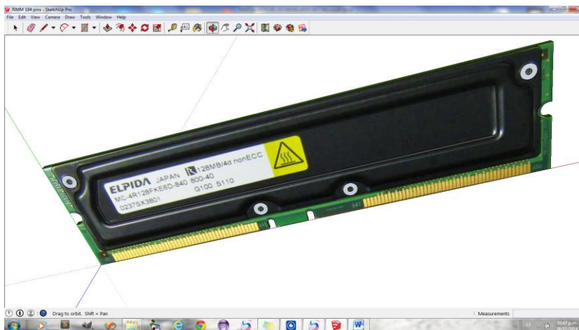
Figura 19 Memoria RAM RIMM Fuente: Elaboración propia
