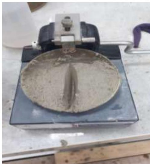
**Figura 12.**Ensayo en la copa de Casagrande
