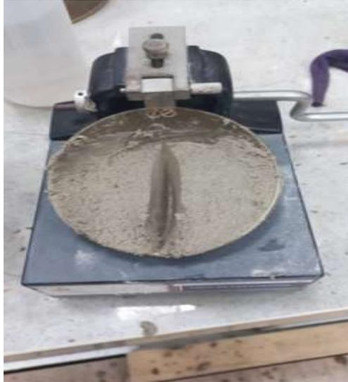
Elaboración del ensayo de límite líquido Copa Casagrande
