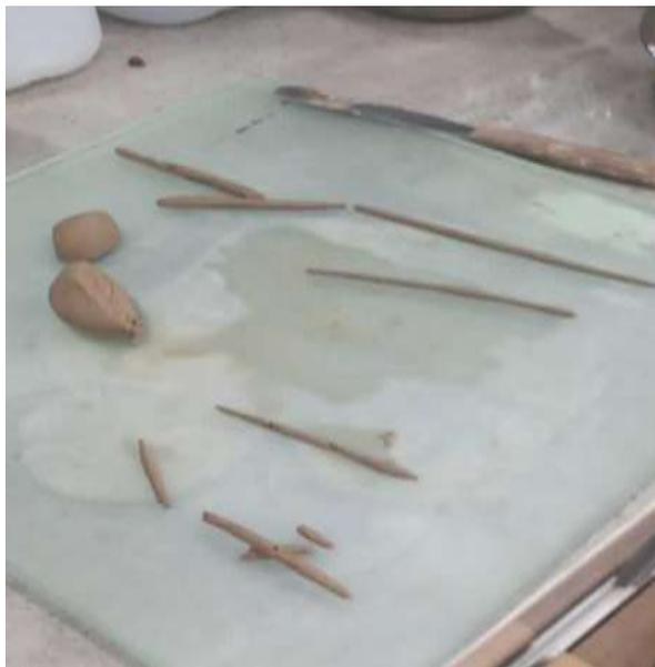
**Figura 13.** Realización de rollitos de la muestra natural tomada.
