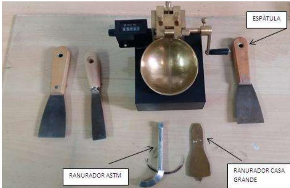
**Figura 6.** Equipo de laboratorio para el ensayo [27]
