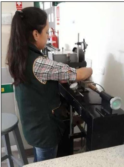
h. Mientras la máquina realizó el corte del suelo, se tomó lecturas del deformímetro de carga, desplazamiento de corte y desplazamientos verticales.
