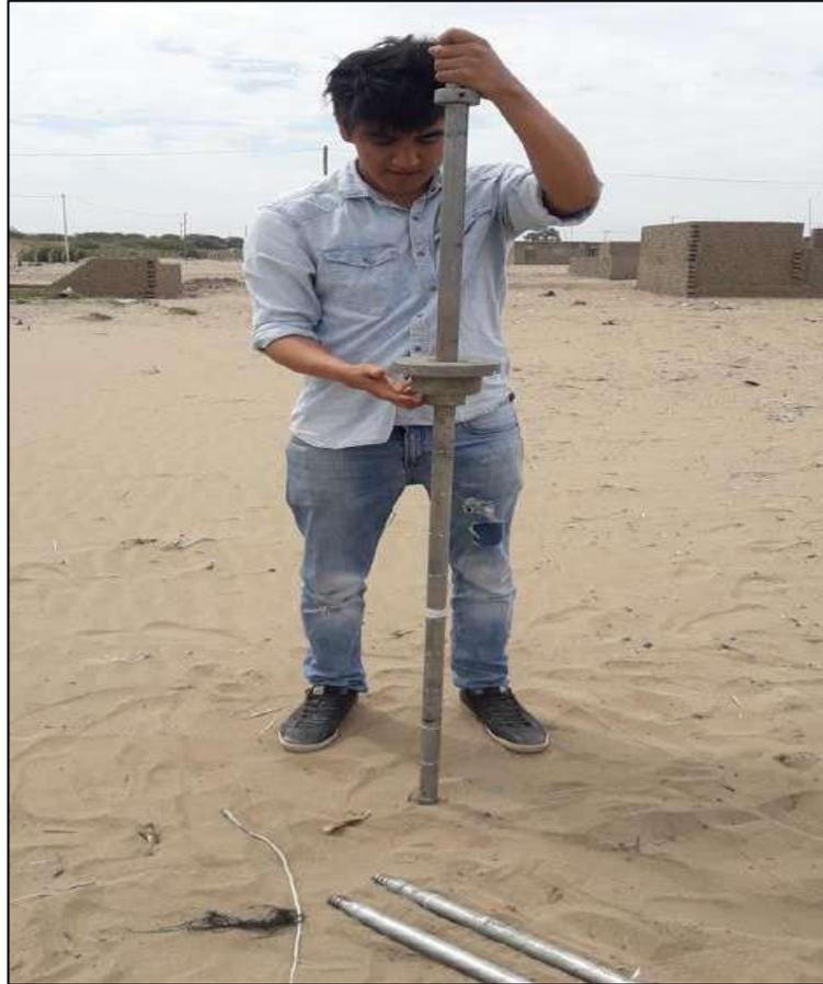
**Figura 46:** Preparación del equipo para ensayo PDC
