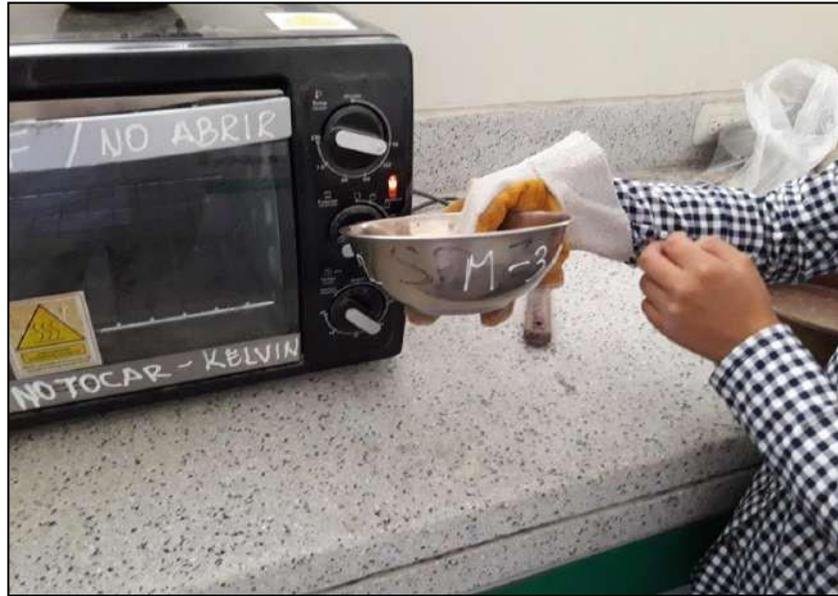
**Figura 42:** Ensayo de contenido de humedad
