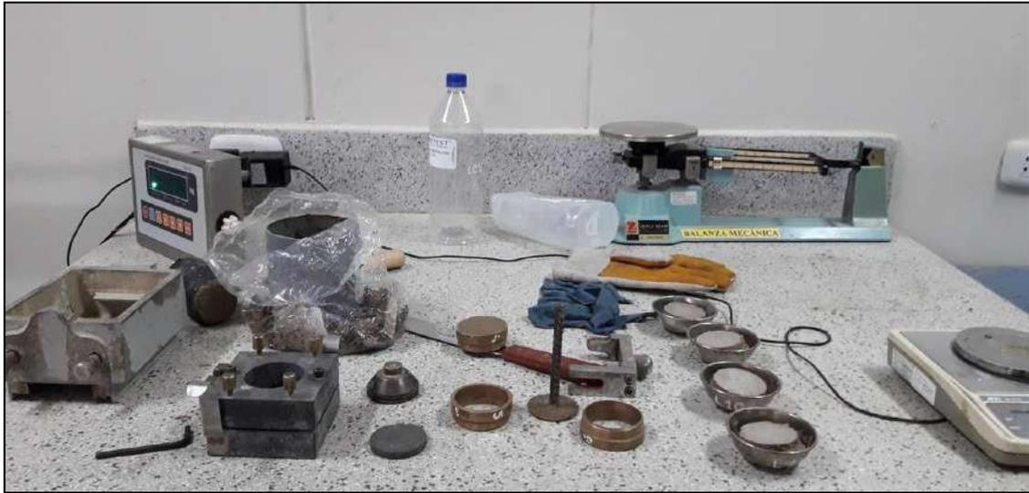
**Figura 44:** Preparación de muestra para ensayo de corte directo
