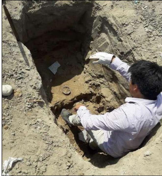
**Figura 40:** Extracción de muestra inalterada
