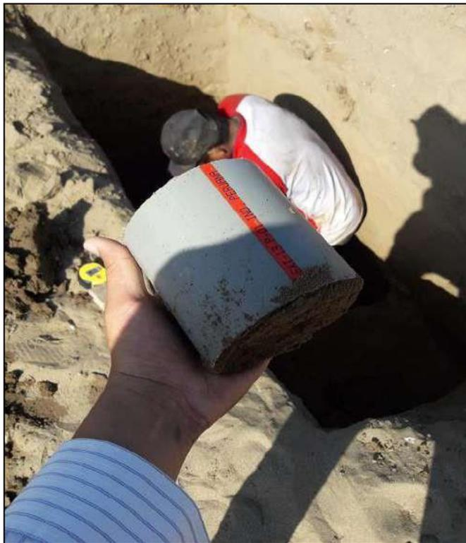
**Figura 41:** Muestra inalterada extraída
