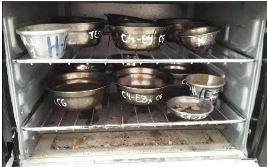
**Figura 43:** Ensayo de límite plástico
