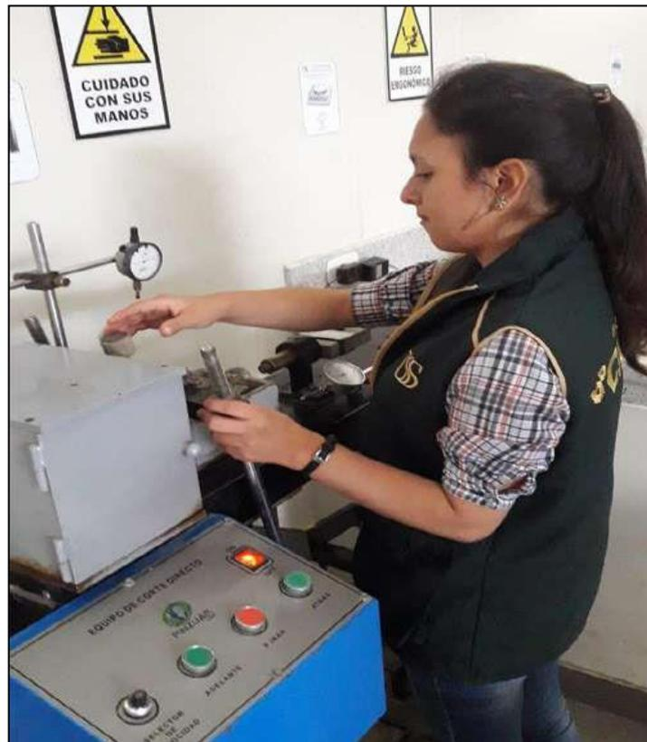
**Figura 45:** Ensayo de corte directo
