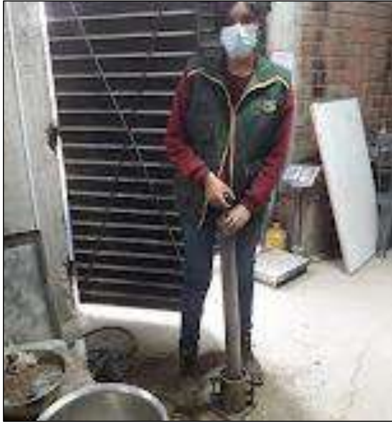
Figura 27. Ensayo de Proctor Modificado. Fuente: propia.
