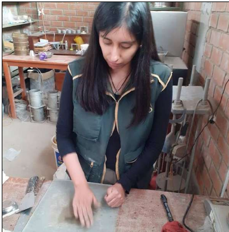
Figura 26. Ensayo de Límite Plástico. Fuente: propia.
