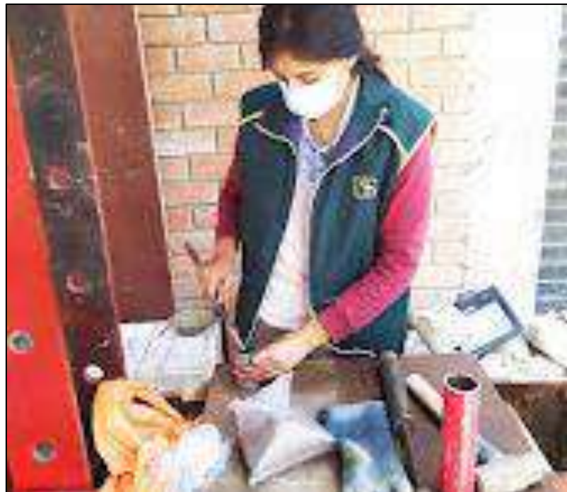
Figura 28. Preparación de probetas para el ensayo UCS. Fuente: propia.
