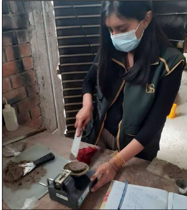
Figura 25. Ensayo de Límite Líquido. Fuente: propia.
