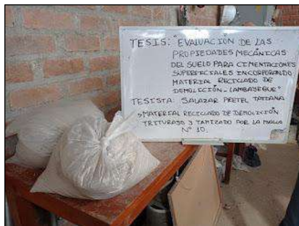
Figura 7. CRD triturado y tamizado por la malla N°10. Fuente: propia.
