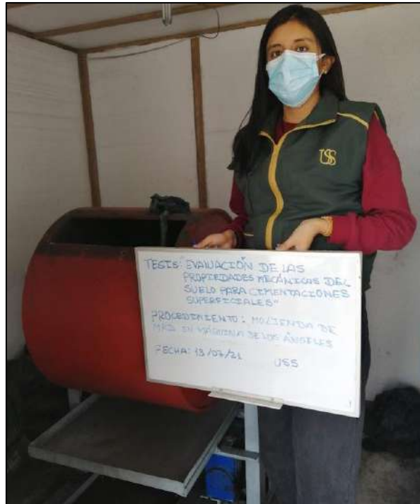
Figura 6. Molienda de CRD en Máquina de Abrasión Los Ángeles. Fuente: propia.
