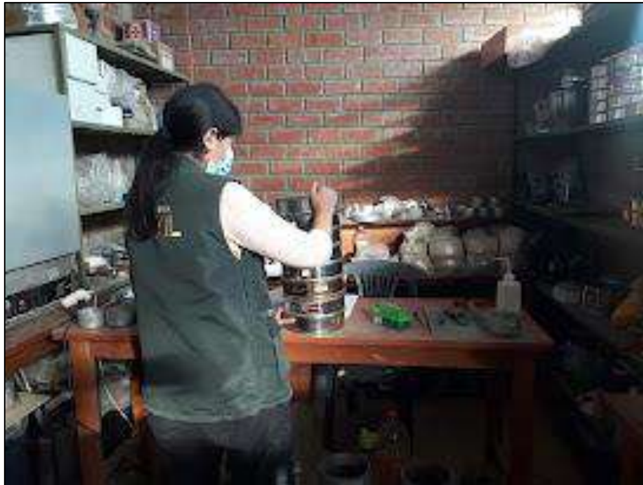
Figura 23. Ensayo de granulometría de suelo. Fuente: propia.
