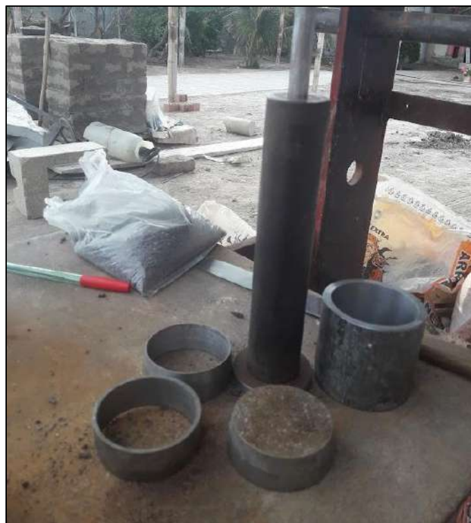
Figura 32. Elaboración de especímenes para ensayo de corte directo. Fuente: propia.
