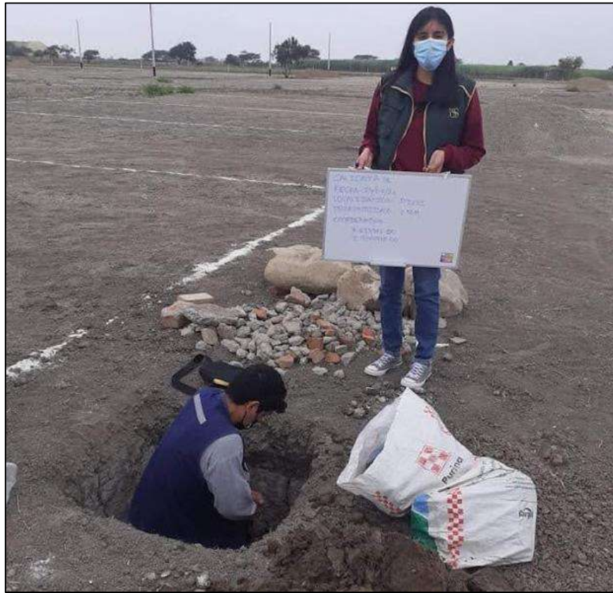
Figura 19. Toma de muestras de suelo (calicatas). Fuente: propia.
