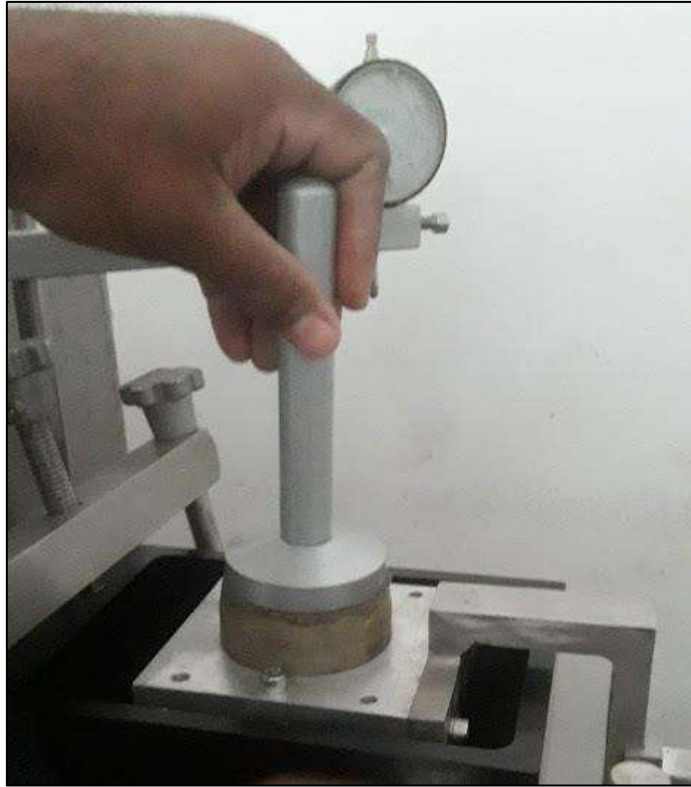
Figura 33. Colocación de muestra en caja de corte para ensayo de corte directo. Fuente: propia.
