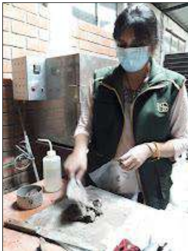
Figura 24. Preparación de muestra de suelo para el desarrollo de ensayo de Límites de Atterberg. Fuente: propia.
