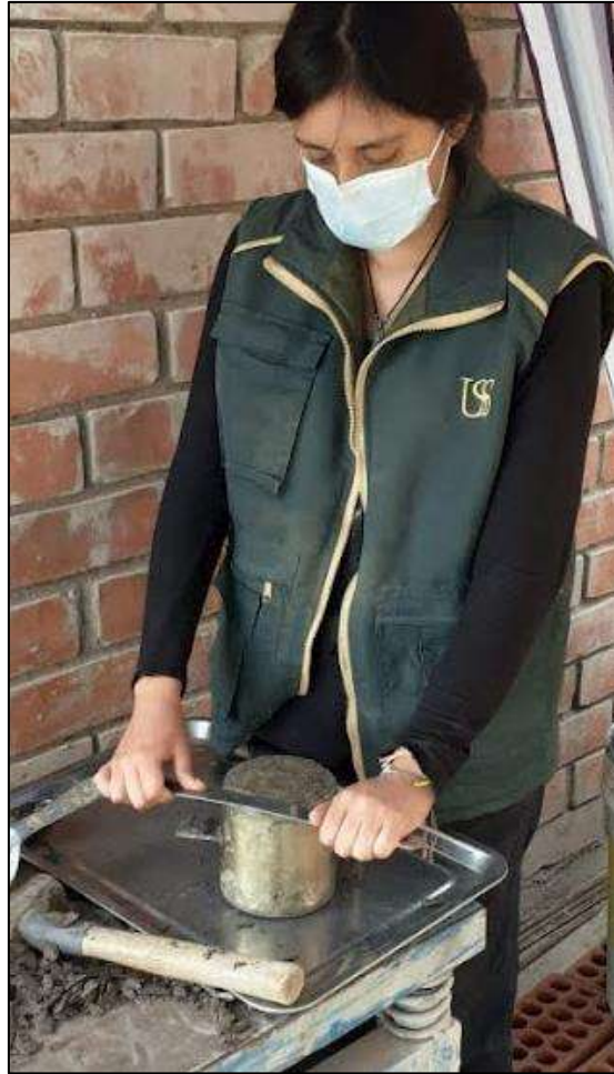
Figura 8. Ensayo de Proctor Modificado ASTM D 1557. Fuente: propia.
