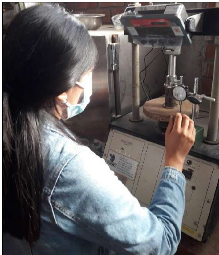
Figura 30. Ensayo UCS. Fuente: propia.
