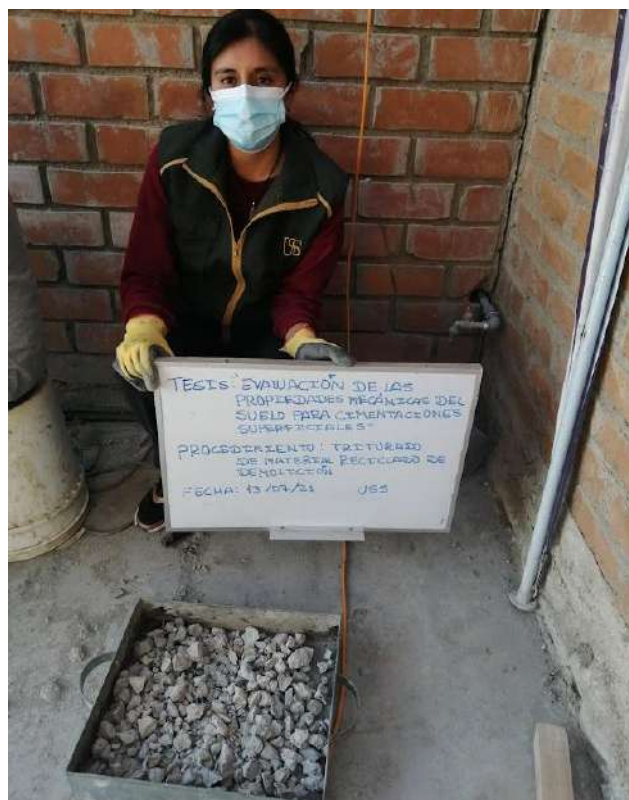
Figura 21. Triturado previo a la molienda en máquina de Abrasión de materiales de CRD. Fuente: propia.
