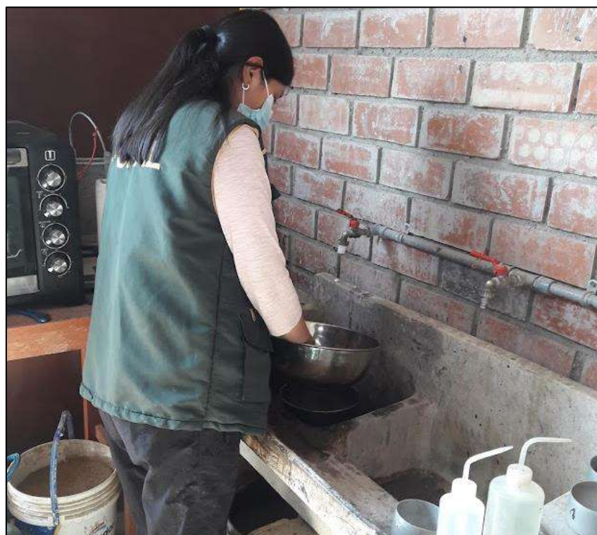
Figura 22. Lavado de suelo para ensayo de clasificación granulométrica. Fuente: propia.
