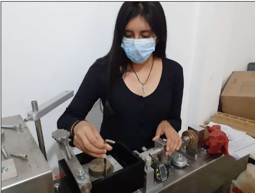
Figura 34. Ensayo de corte directo. Fuente: propia.
