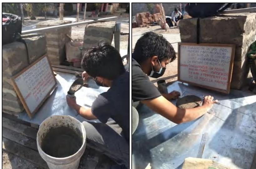
*Figura 27.* Ensayo de consistencia de flujo.
