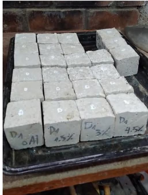
9. Ensayo de resistencia a la compresión: Rotura de los cubos de mortero y especímenes después de ser ensayados.
