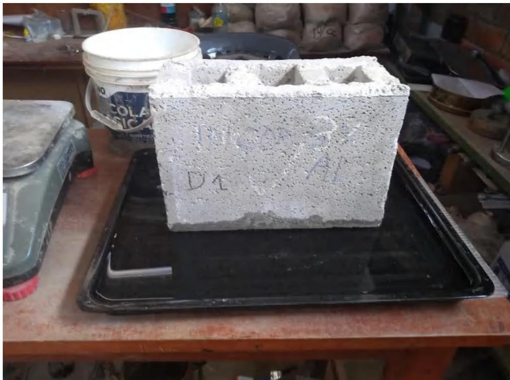
14. Ensayos mecánicos de los bloques de concreto ligero.
