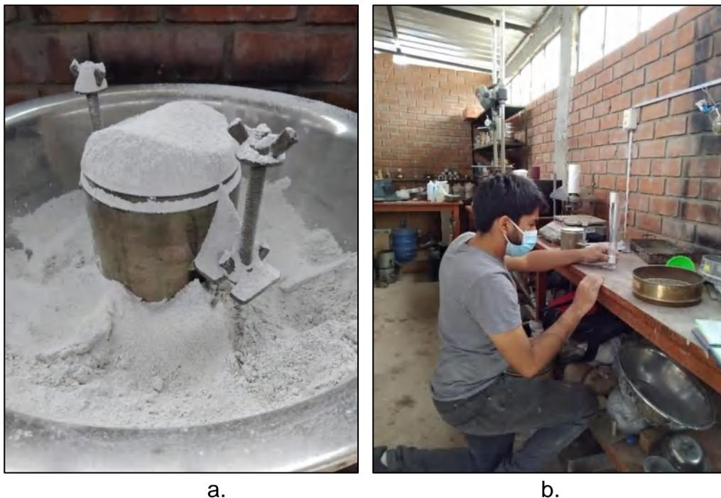
Figura 17. Ensayos de pesos unitarios de la cal. a) Suelto. b) Compactado.
