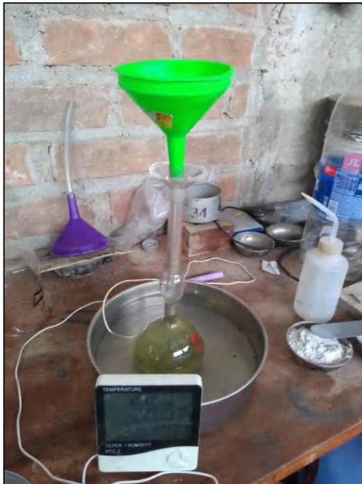
*Figura 18.* Ensayo de peso específico de la cal.
