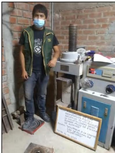
*Figura 35.* Ensayo de Resistencia a la compresión de prismas de albañilería.
