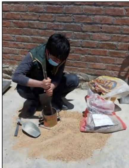
*Figura 13.* Compactación para el ensayo peso unitario compactado.
