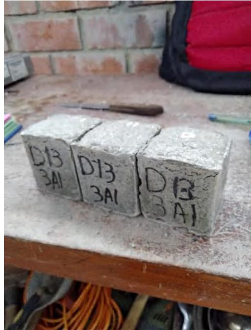
8. Ensayo de densidad de los cubos de mortero: Toma de peso sumergido, cubos saturados superficialmente seco y secado de los especímenes al horno.
