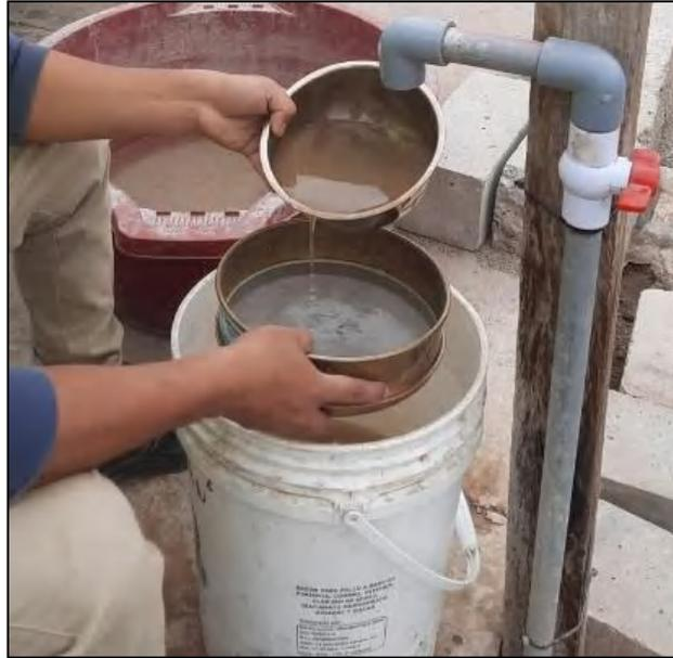
Figura 16. Lavado de la arena por el tamiz No 200.
