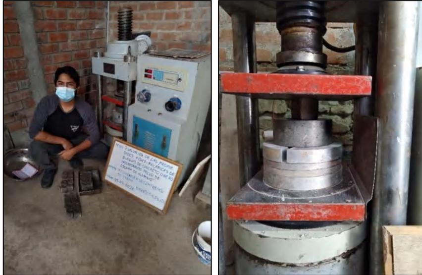
*Figura 22.* Resistencia a la compresión de cubos de mortero, diseños previos de concreto ligero.
