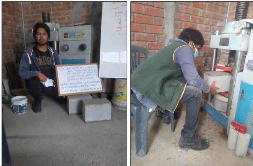
*Figura 33.* Ensayo de resistencia a la compresión de bloques de concreto.
