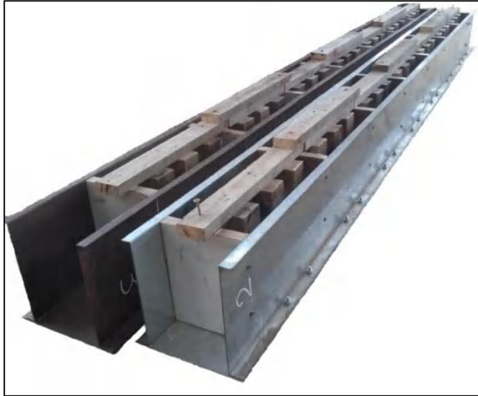
*Figura 25.* Moldes utilizados para la elaboración de los bloques de concreto ligero.
