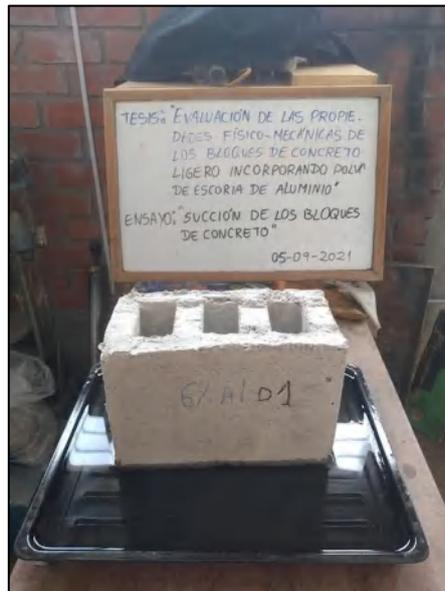
Figura 32. Ensayo de succión de los bloques de concreto.
