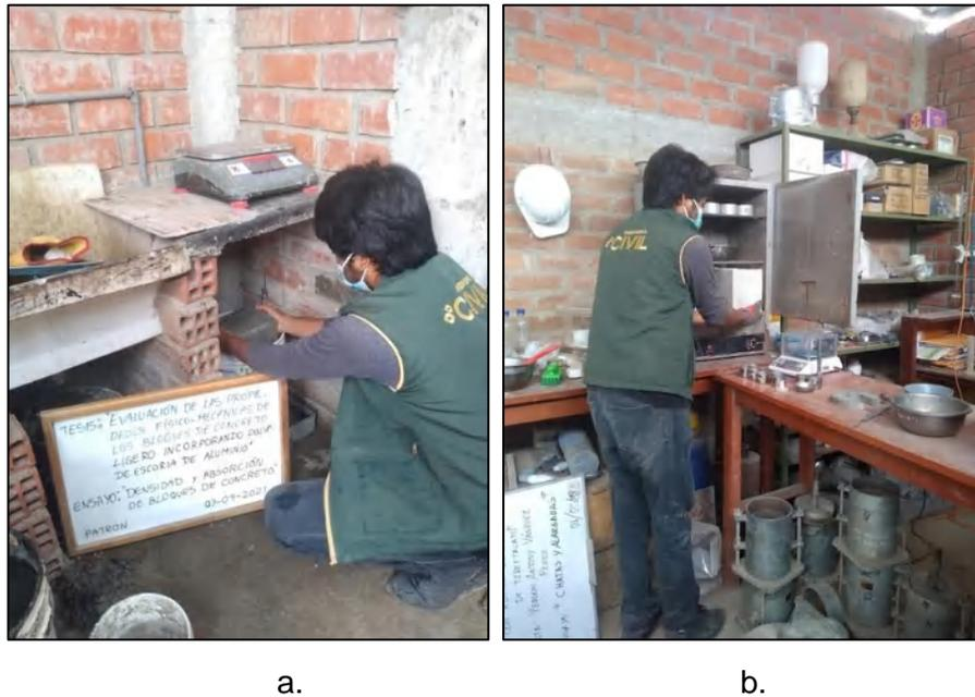
Figura 31. Procedimiento para determinar la densidad y absorción. a) Peso sumergido. b) Secado al horno.
