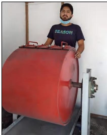
*Figura 11.* Pulverizado de la escoria de aluminio en la máquina de abrasión.
