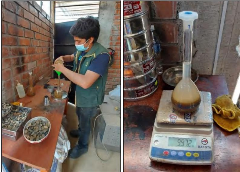
Figura 15. Ensayo peso de específico de la arena.
