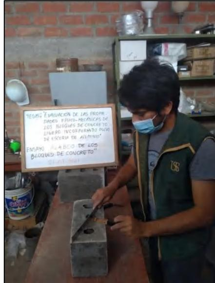
Figura 30. Ensayo de alabeo de los bloques de concreto ligero.
