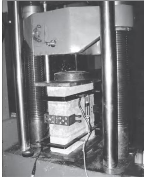
*Figura 5. Ensayo de compresión axial de prismas de albañilería. Fuente: (Navas Carro, 2007)*
