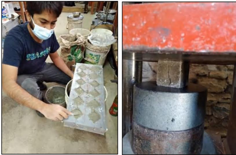
*Figura 34.* Cubos de mortero. a) Elaboración. b) Resistencia a la compresión.
