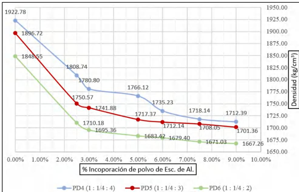
Figura 46. Densidad de los diseños PD4, PD5 y PD6 con incorporación de polvo de escoria de aluminio.
