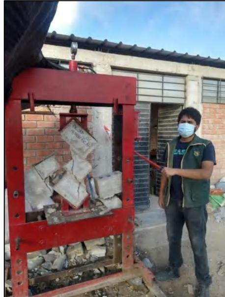
*Figura 36.* Ensayo de Resistencia a la compresión diagonal en muretes.
