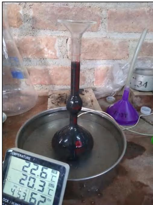
*Figura 21.* Ensayo de peso específico del polvo de escoria de aluminio.
