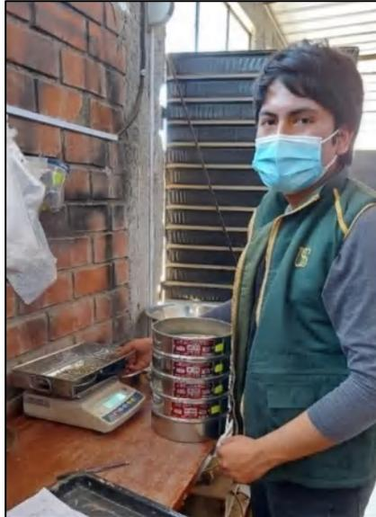
*Figura 12.* Tamizado para análisis granulométrico de la arena.
