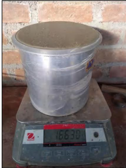
Figura 28. Peso unitario de la muestra de concreto fresco.
