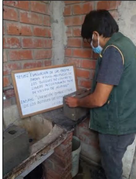
Figura 29. Lectura de medidas de los bloques de concreto ligero.
