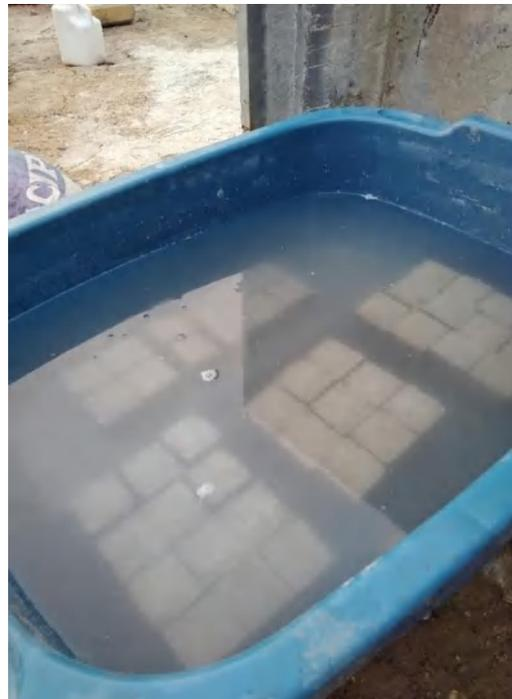
7. Apreciación visual de la expansión de la mezcla de concreto: Cubos de mortero sin incorporación de polvo de esc. de aluminio y con incorporación.
