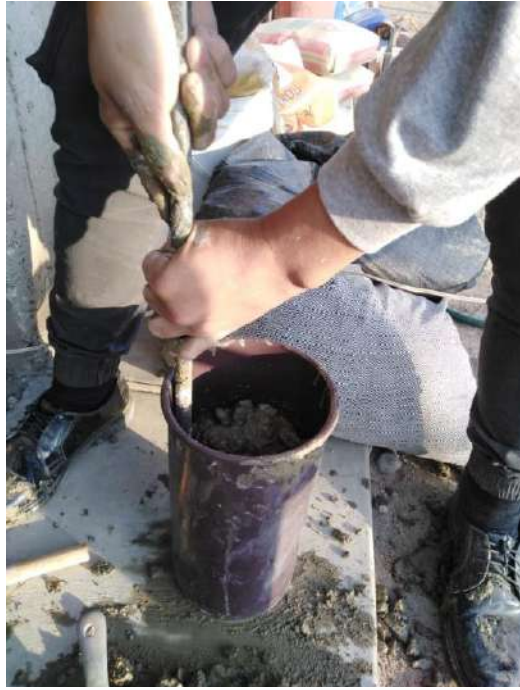
Figura 24: Compactación de probetas cilíndricas de 15cm x 30cm
