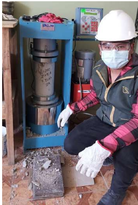
Figura 27: Ensayo de resistencia a la compresión y falla del espécimen
