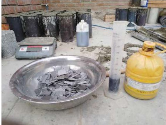
Figura 22: Diseño de mezcla con fibras de acero y aditivo plastificante.
