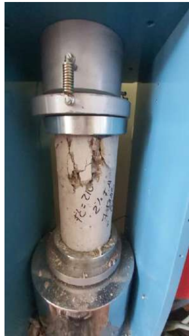
Figura 27: Ensayo de resistencia a la compresión y falla del espécimen
