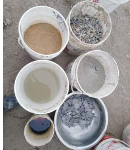
Figura 22: Diseño de mezcla con fibras de acero y aditivo plastificante.
