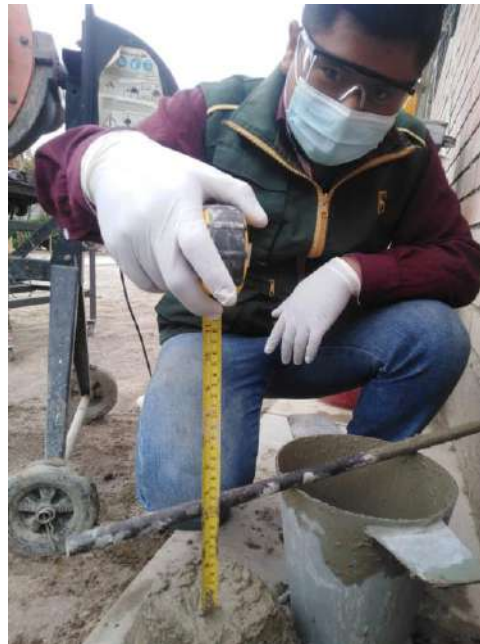
Figura 23: Asentamiento del concreto.
