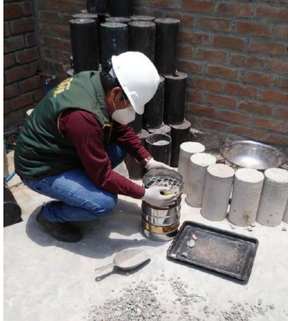
Figura 20: Análisis granulométrico de la piedra de 1/2"
