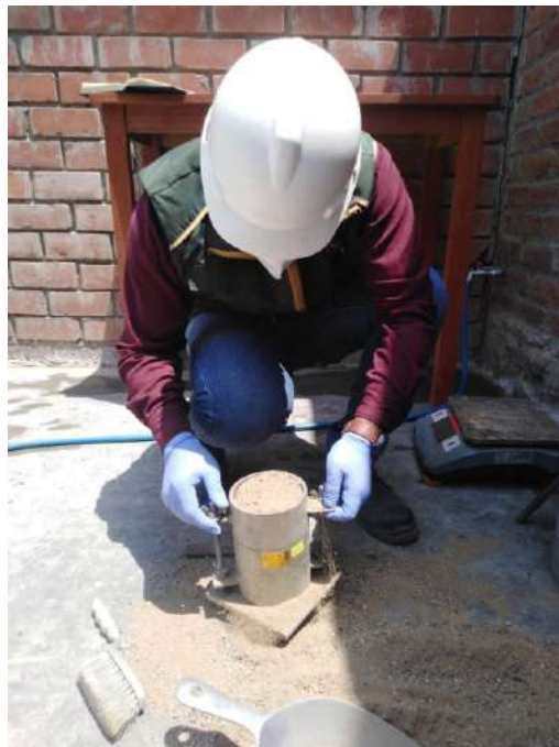
Figura 19: Peso Unitario y Humedad del agregado fino.
