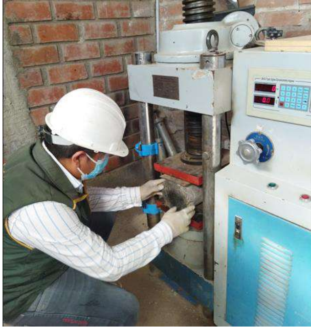
Figura 30: Ensayo de resistencia a la tracción
