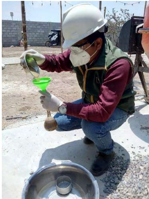
Figura 21: Ensayo de porcentaje de absorción del agregado fino.
