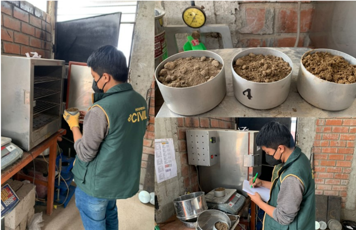
Figura 89. Pesado y puesta en horno de muestras de suelo– Ensayo de contenido de humedad.
