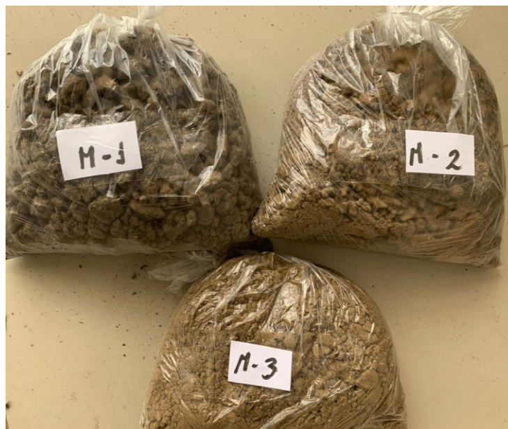
Figura 88. Extracción de muestras de calicatas para estudio de mecánica de suelos.
