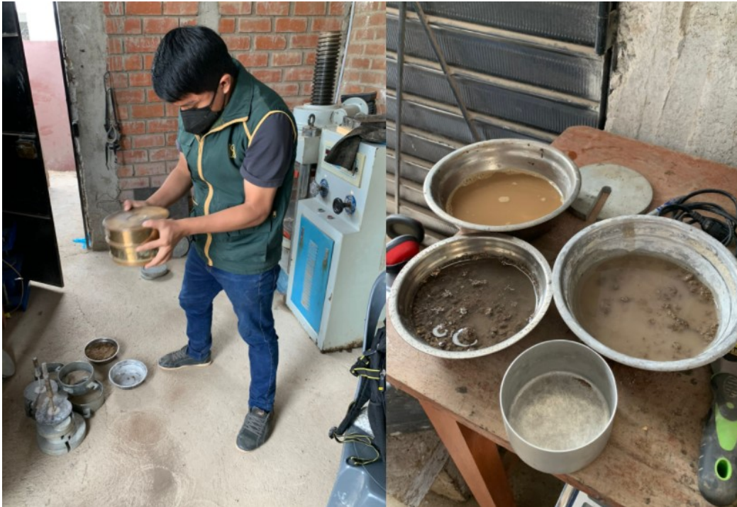
Figura 91. Tamizado de muestra tamiz N°40 y puesta en agua destilada – Límites de Atterberg.
