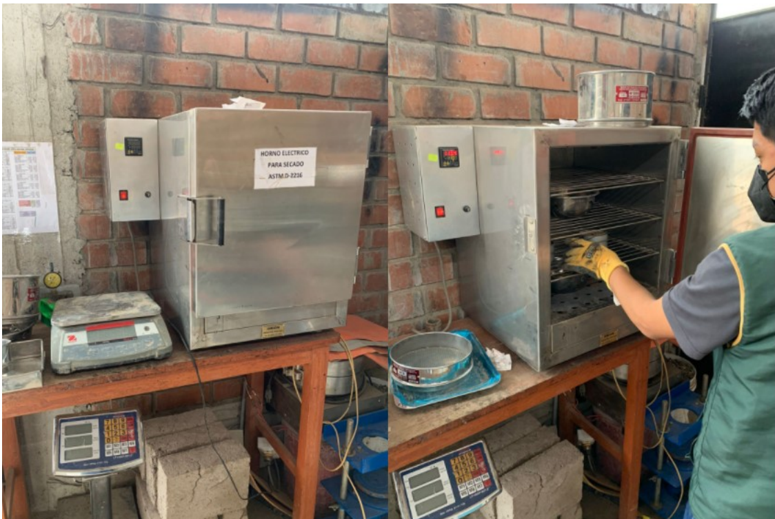
Figura 90. Retiro de horno y pesado de muestras de suelo – Ensayo de contenido de humedad.
