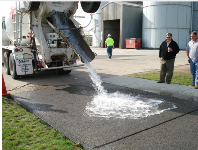
Figura 9: La característica clave del concreto permeable es su estructura de poro abierto Fuente: (ARGOS, 2020)
