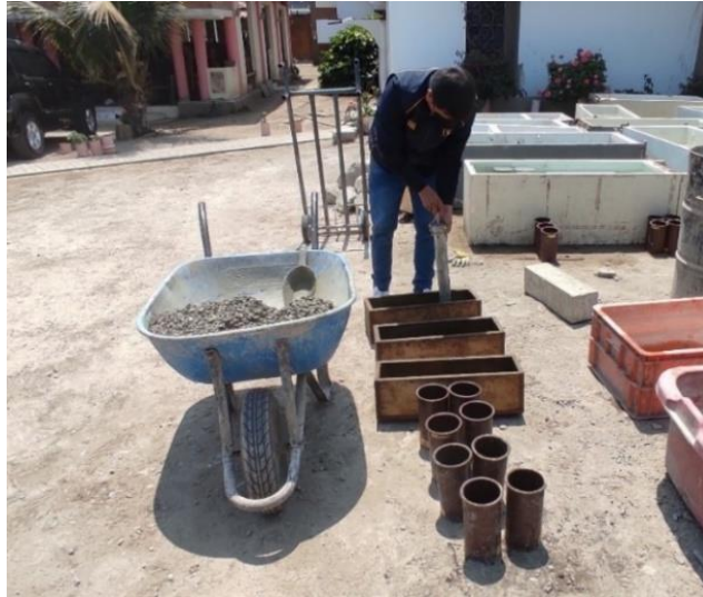
Figura 17: Compactación de las probetas cilíndricas y prismáticas de concreto permeable.
