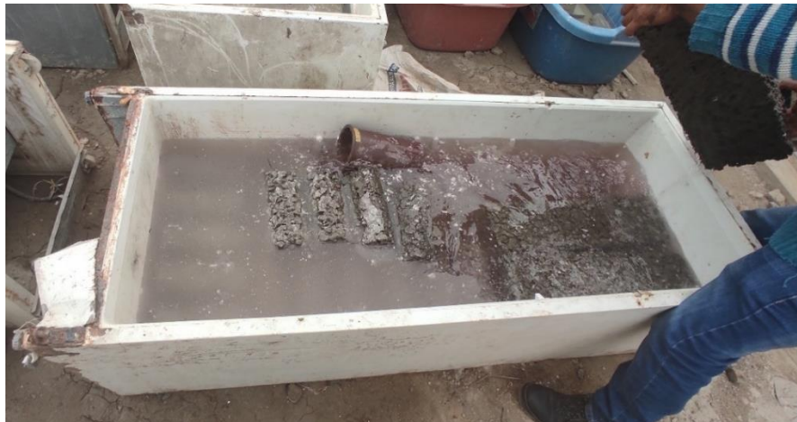
Figura 18: Curado de probetas cilíndricas y prismáticas de concreto permeable.
