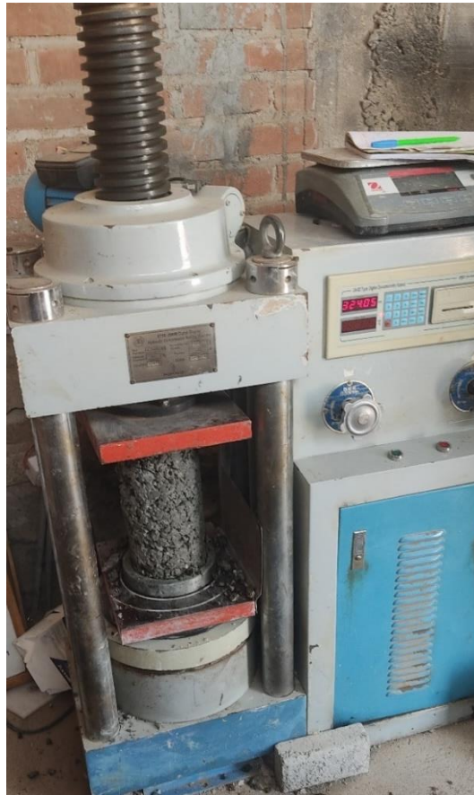
Figura 19: Rotura de probetas cilíndricas. Ensayo de resistencia a la compresión. Fuente: Autoría propia
