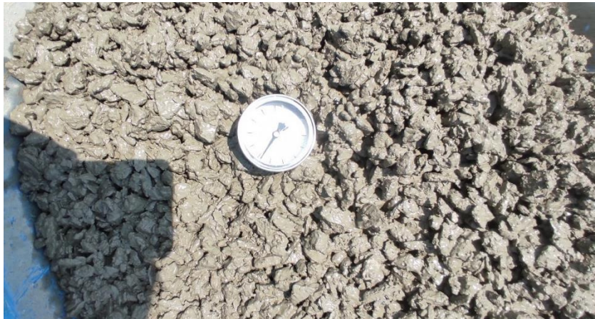
Figura 16: Medición de la temperatura del concreto permeable.
