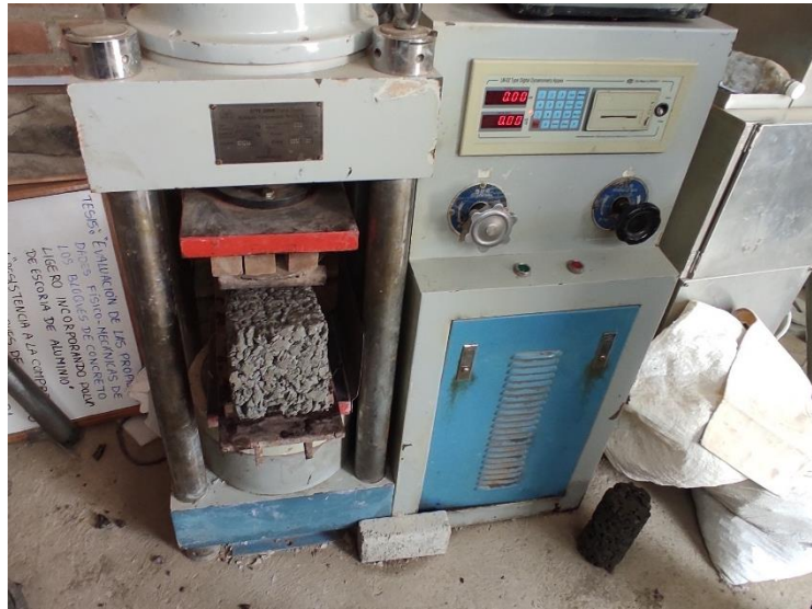
Figura 20: Rotura de vigas. Ensayo de resistencia a la flexión. Fuente: Autoría propia
