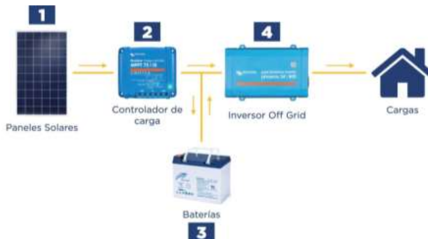
Figura 16. Elementos básicos de instalación autónoma
