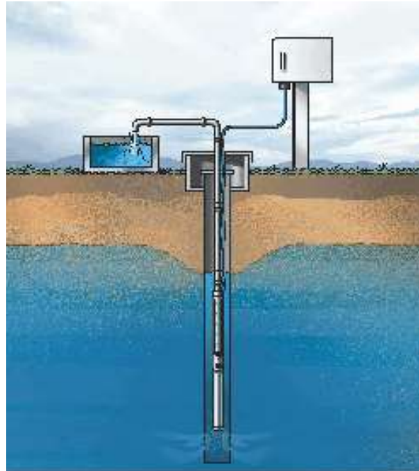
Figura 19. Instalación de bombeo con bomba sumergible
