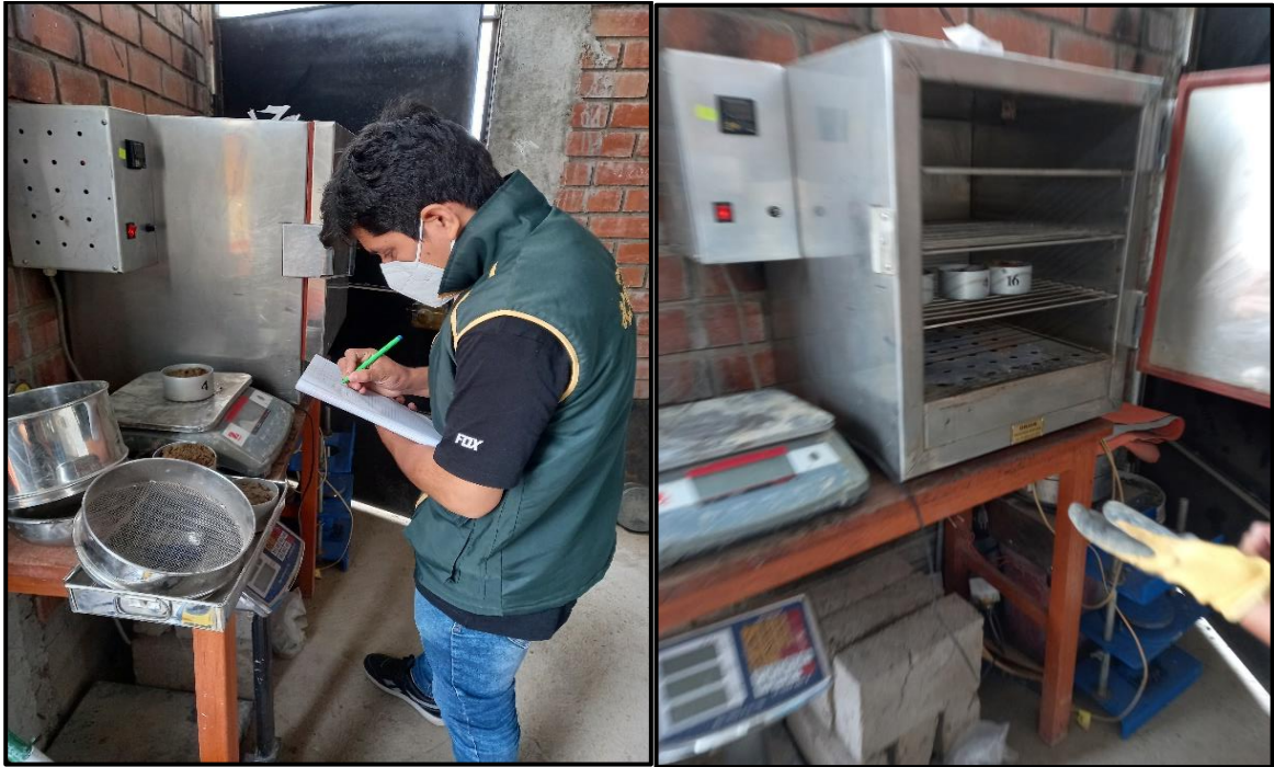
Figura 98: Pesado y puesta en horno de muestras de suelo– Ensayo de contenido de humedad
