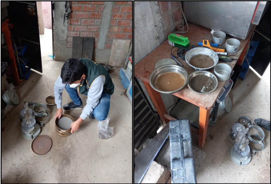
Figura 100: Tamizado de muestra tamiz N°40 y puesta en agua destilada – Límites de Atterberg
