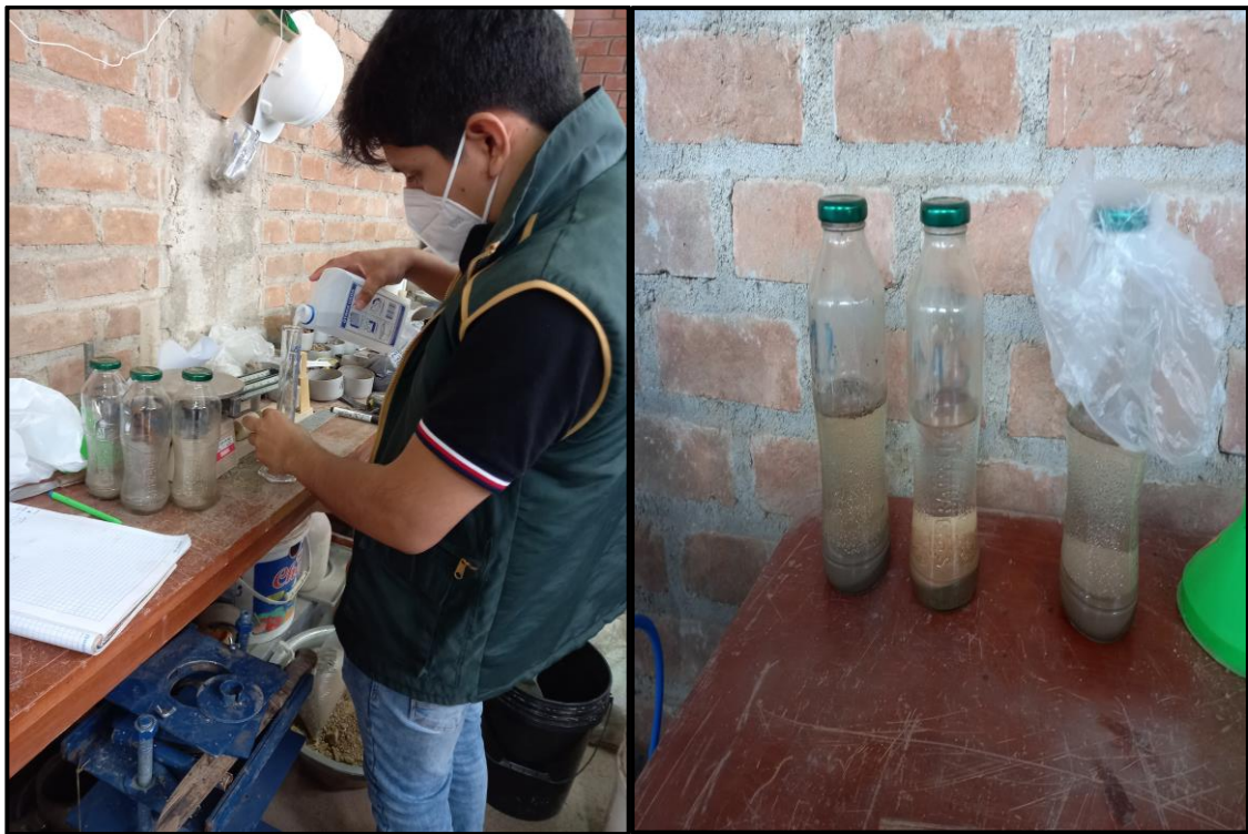
Figura 104: Agua destilada en muestras de suelo - Ensayo de sales solubles totales
