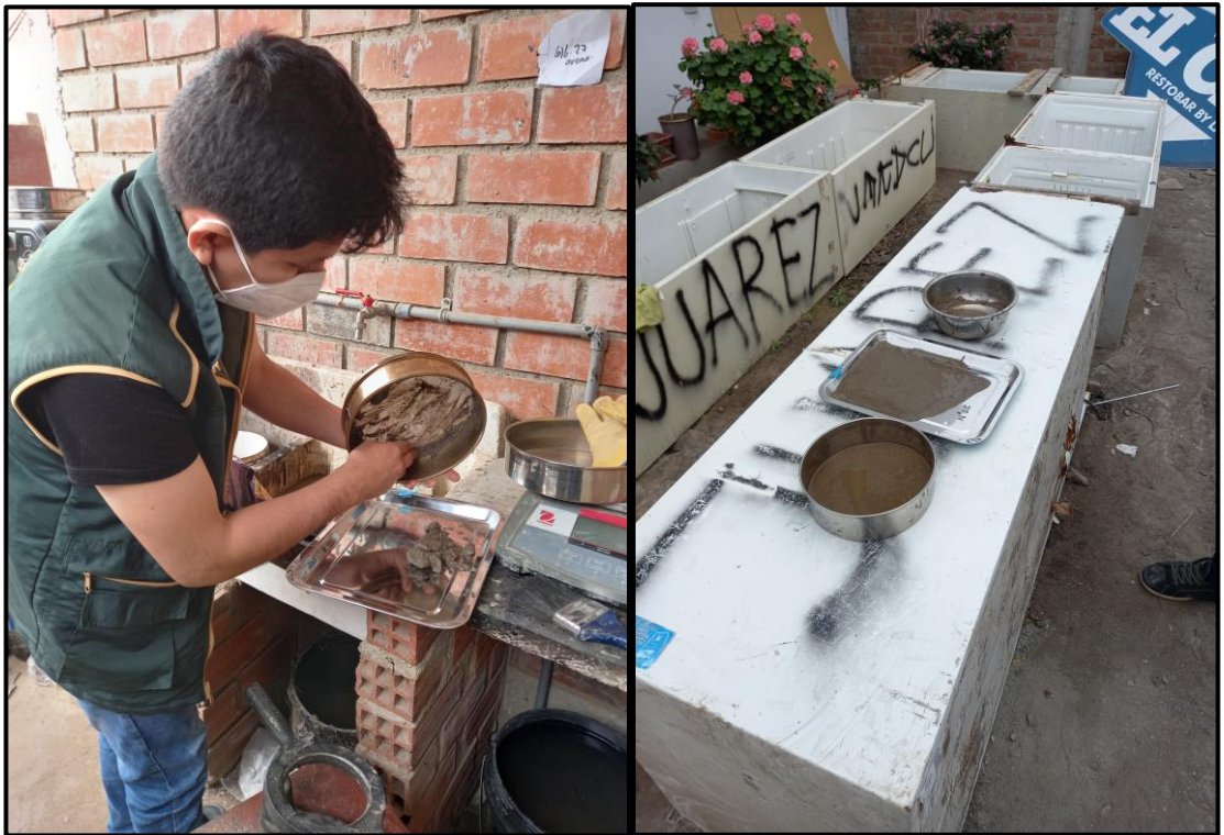
Figura 102: Lavado de masa y secado natural – Ensayo de análisis granulométrico
