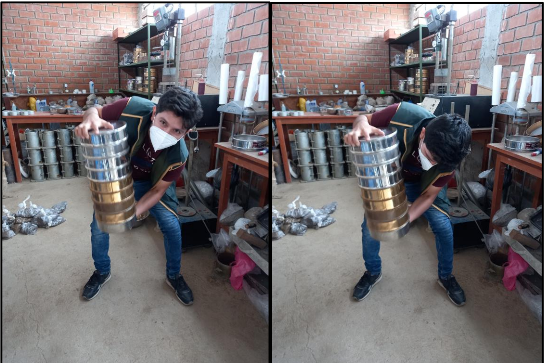
Figura 103: Tamizado de muestras – Ensayo para análisis granulométrico
