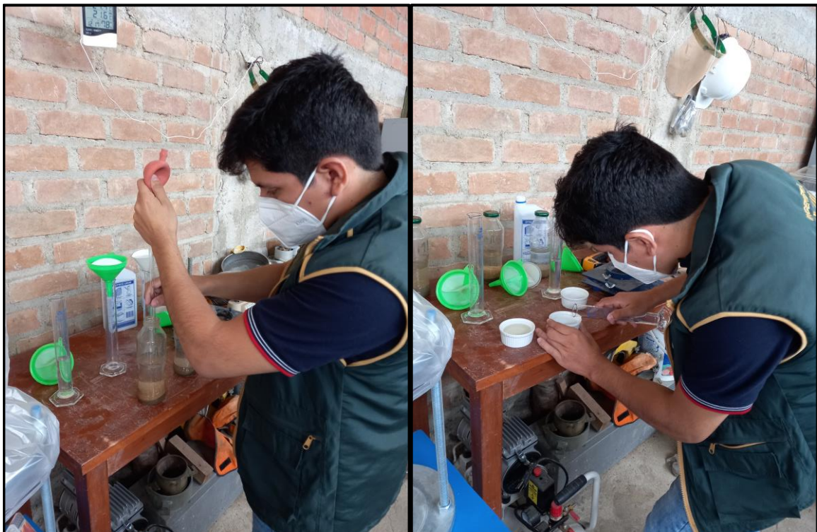
Figura 105: Filtrado de muestra, pesado y puesta en horno – Ensayo de sales solubles totales
