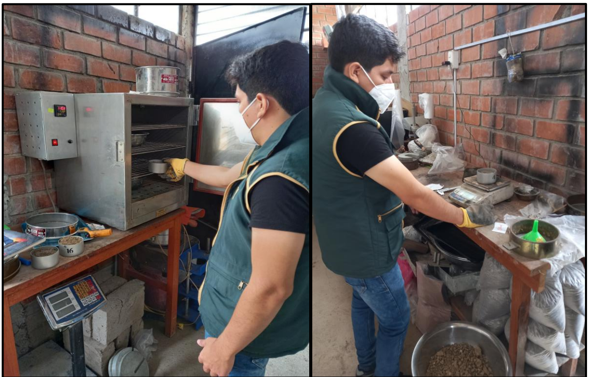
Figura 99: Retiro de horno y pesado de muestras de suelo – Ensayo de contenido de humedad
