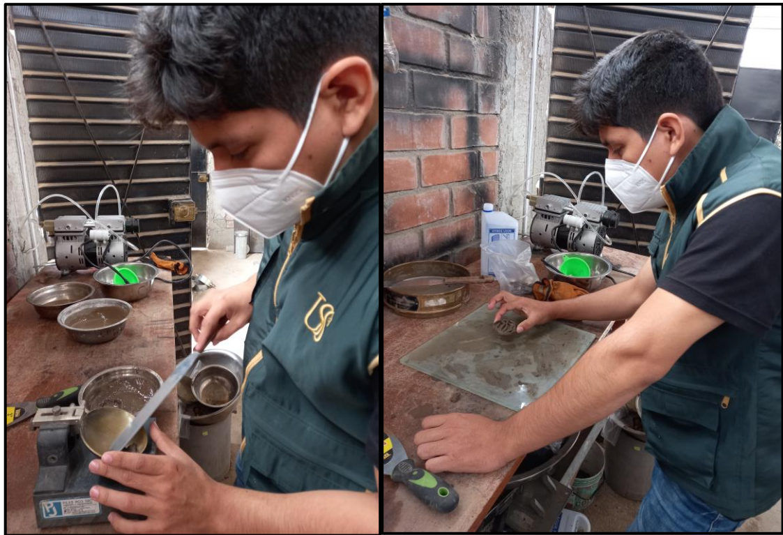
Figura 101: Copa Casagrande y enrollado de masa – Ensayo de límite líquido y límite plástico
