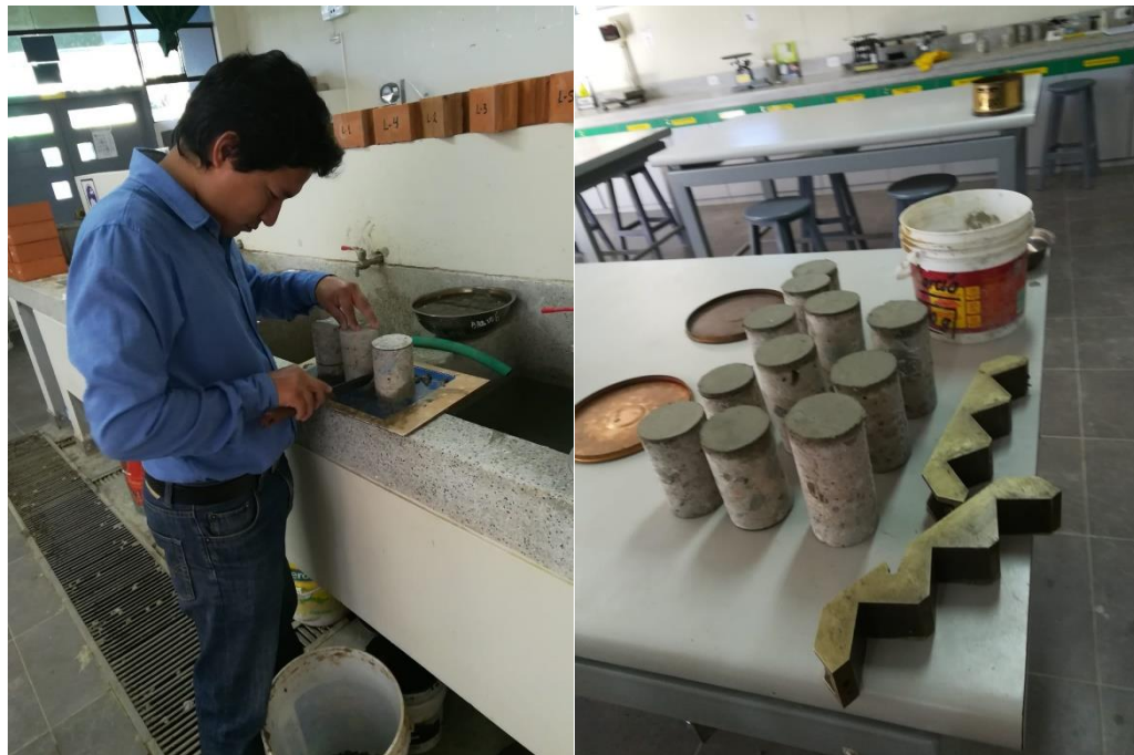
Figura 21: Preparación de los núcleos de concreto de los módulos en estudio.
