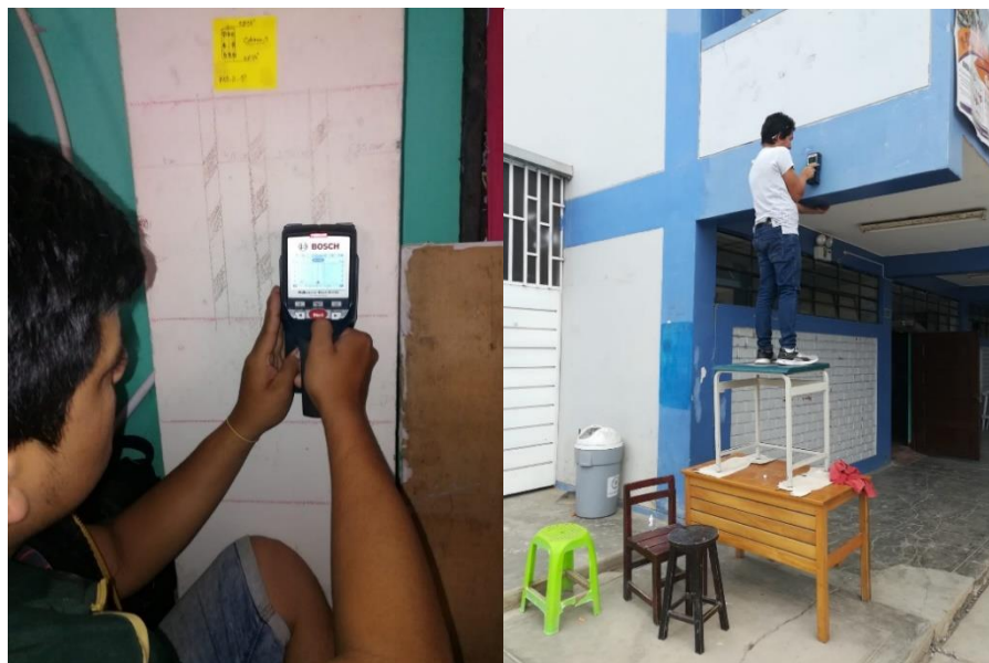
Figura 18: Escaneo al exterior con el Detector Bosch D-TECT 150-SV. Fuente: Elaboración propia.
