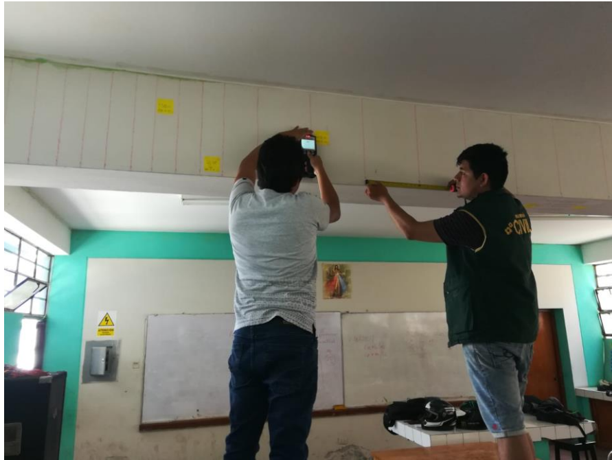
Figura 17: Escaneo al interior de las estructuras en estudio. Fuente: Elaboración propia.
