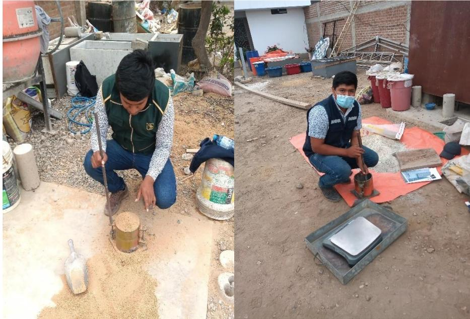
**Figura 16.** Peso unitario compactado de arena gruesa y vidrio triturado.
