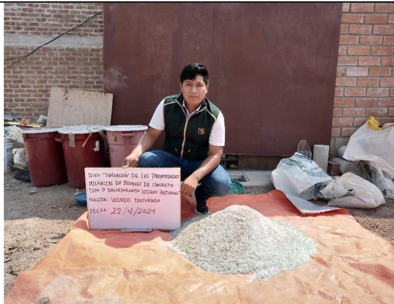
**Figura 1.** Vidrio reciclado obtenido por la tesista posteriormente cernida por la malla #4.
