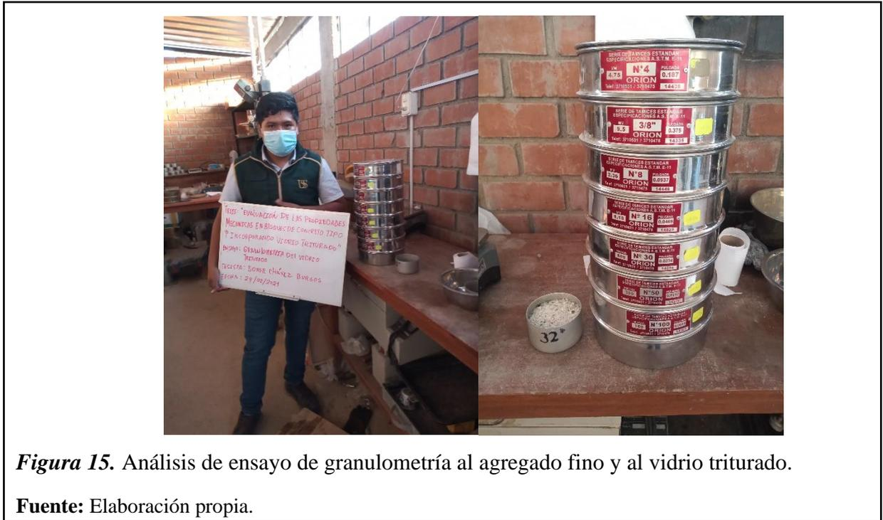
**Figura 15.** Análisis de ensayo de granulometría al agregado fino y al vidrio triturado.
