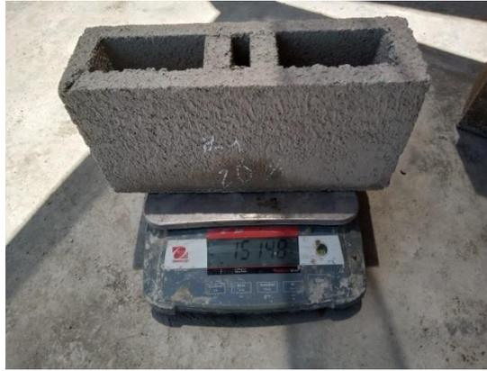
**Figura 11.** Bloque de concreto Tipo P y sus dimensiones.
