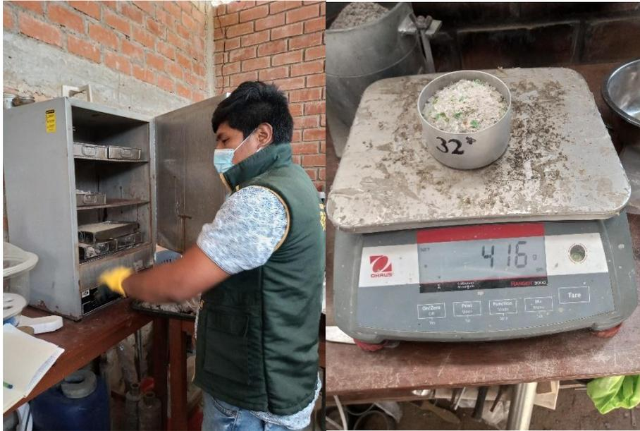
**Figura 17.** Ensayo de contenido de humedad de la arena gruesa, confitillo y vidrio triturado.
