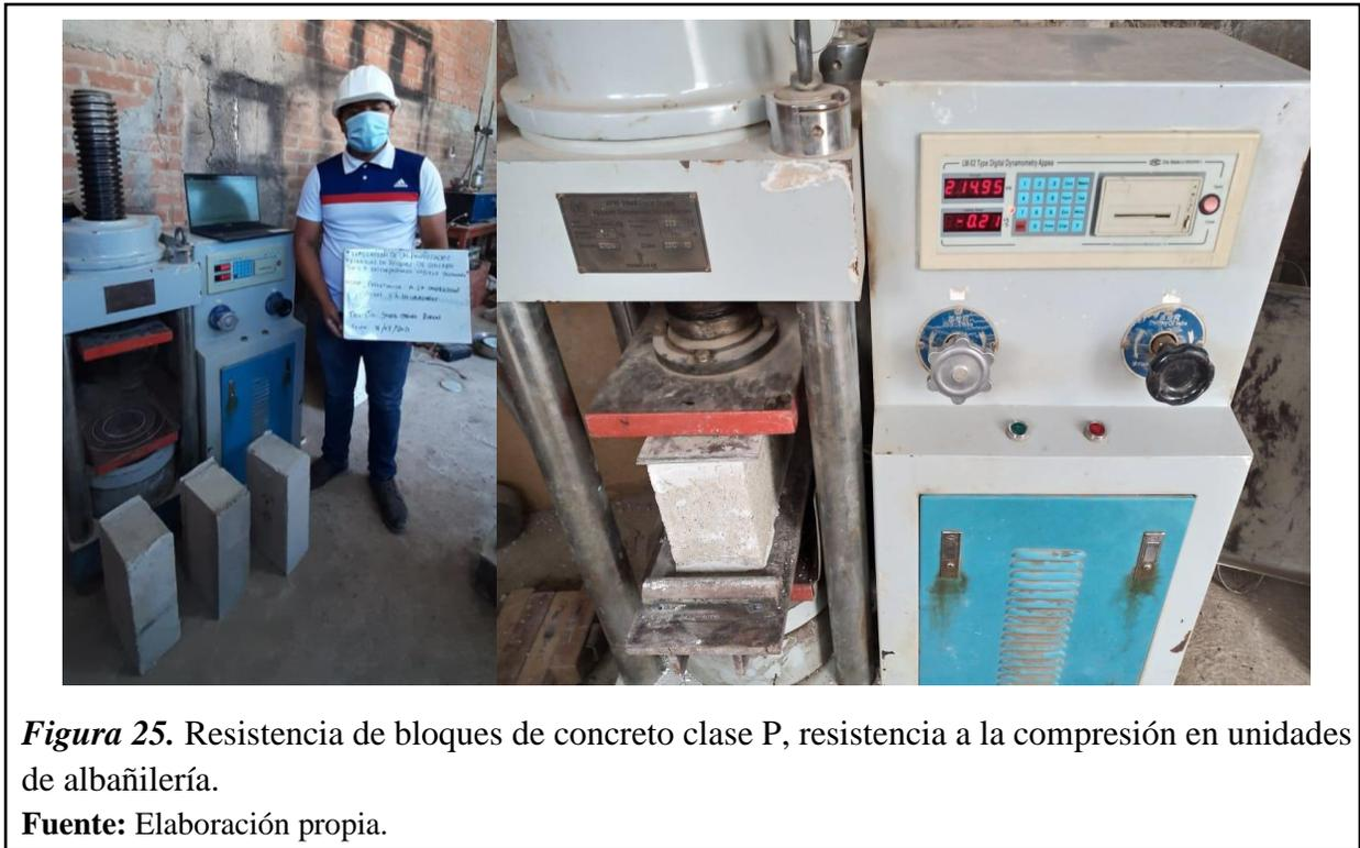
**Figura 25.** Resistencia de bloques de concreto clase P, resistencia a la compresión en unidades de albañilería.
