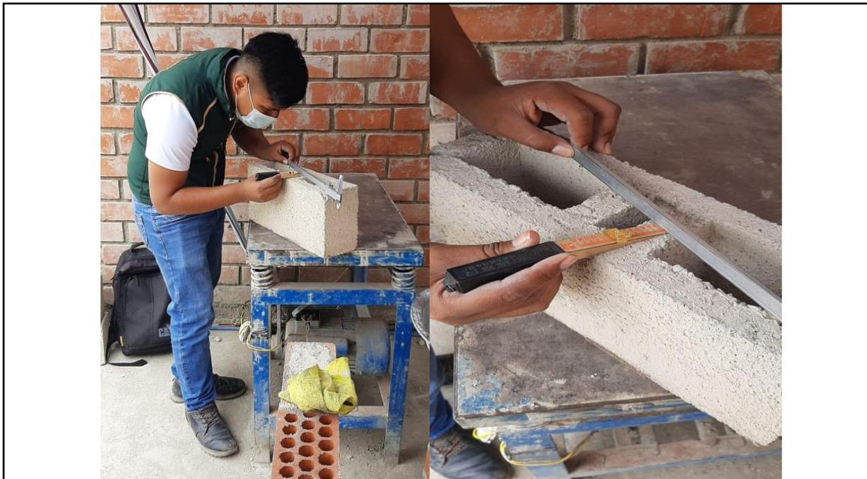
**Figura 21.** Alabeo de la unidad de albañilería – Bloque de concreto P.
