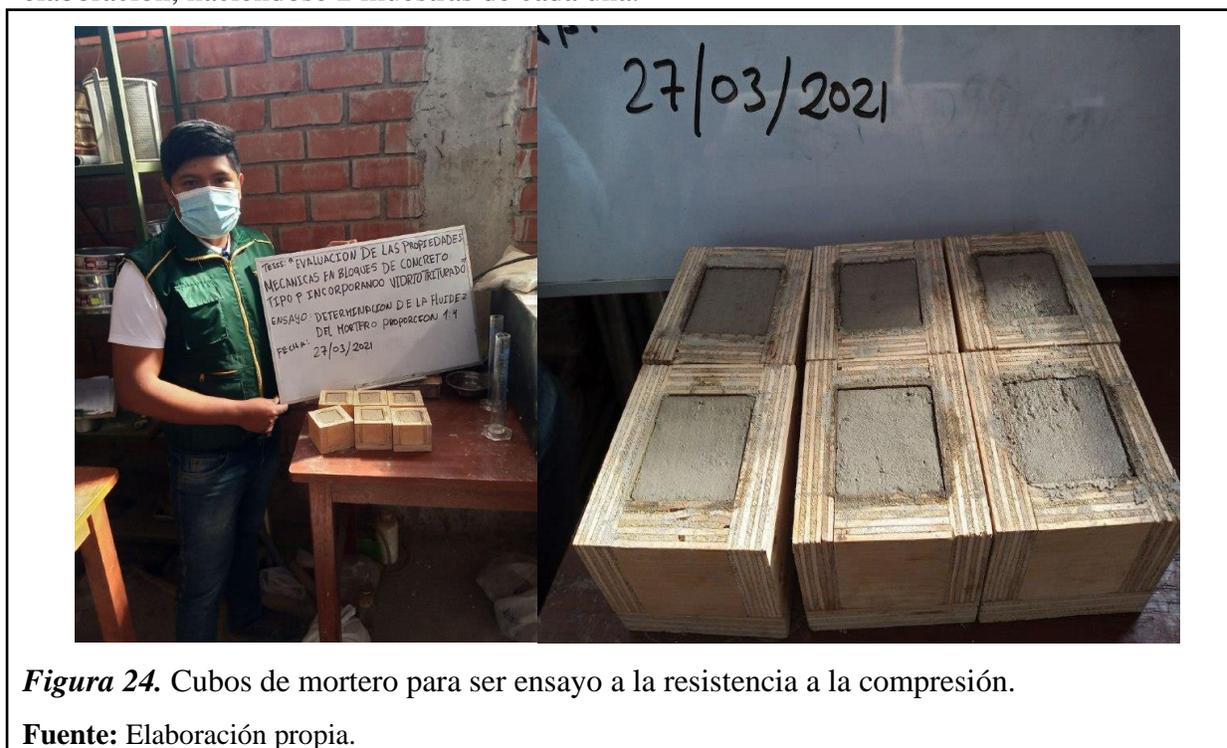
**Figura 24.** Cubos de mortero para ser ensayo a la resistencia a la compresión.
