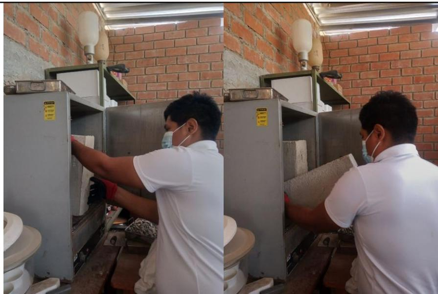
**Figura 22.** Prueba de absorción en bloques de concreto tipo P.
