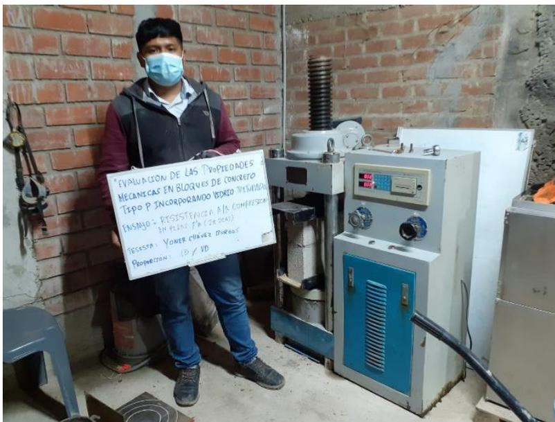
**Figura 26.** Resistencia de bloques de concreto clase P, resistencia a la compresión en pilas.
