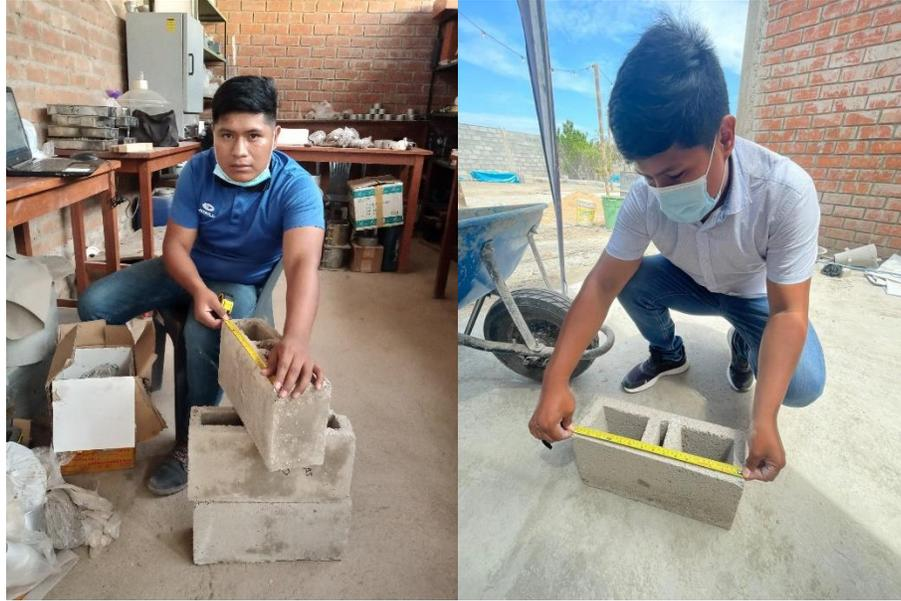
**Figura 20.** Variación dimensional de la unidad de albañilería – Bloque de concreto tipo P.
