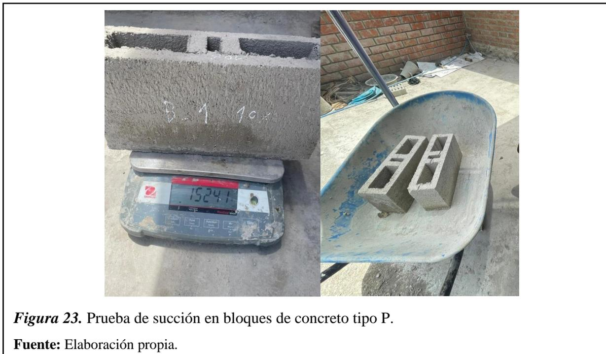
**Figura 23.** Prueba de succión en bloques de concreto tipo P.
