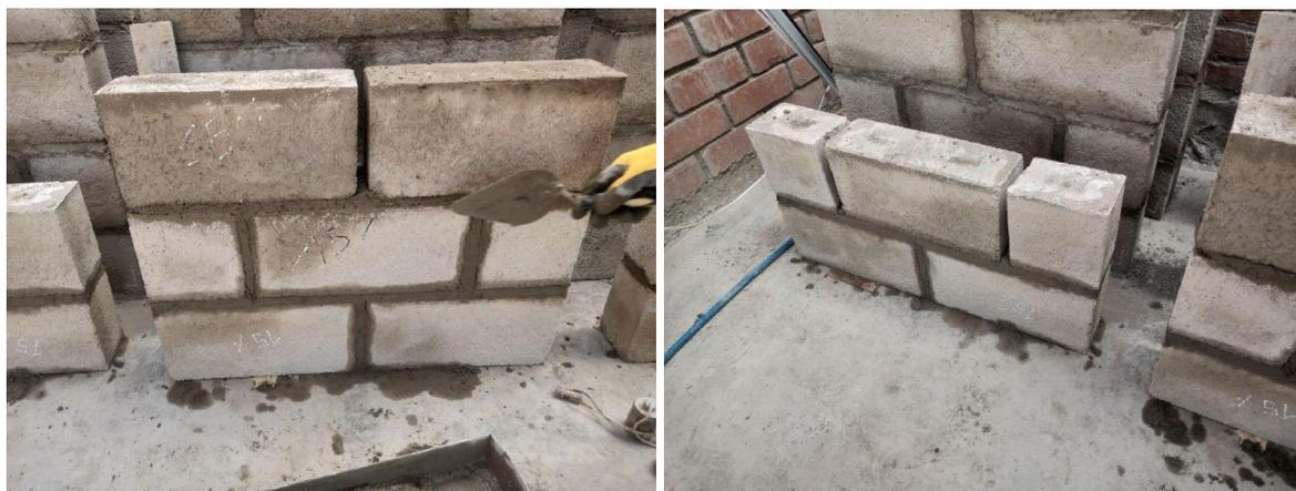
**Figura 7.** Resistencia de compresión en murete de concreto tipo P, dimensiones de 80 x 80 x 12 cm.
