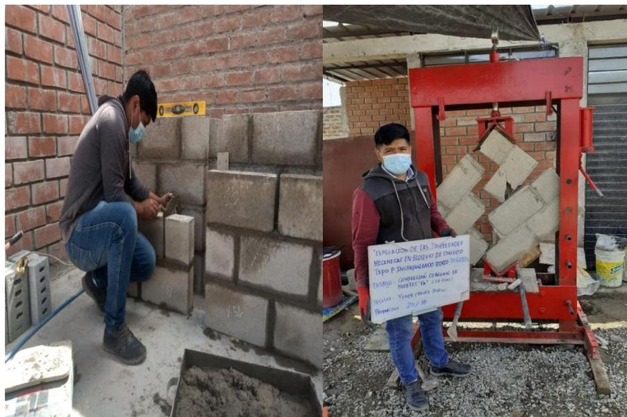
**Figura 27.** Resistencia de bloques de concreto clase P, resistencia a la compresión en muretes.
