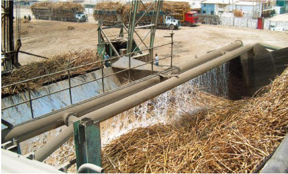
Figura N° 26 Lavado de caña - conductor 2
