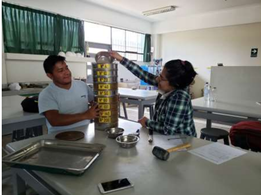
Figura 35: Ensayo de análisis granulométrico
