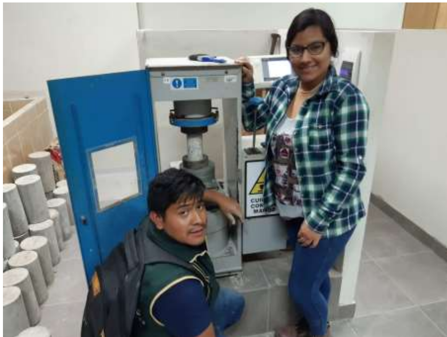
Figura 38: Rotura de los corazones diamantinos
