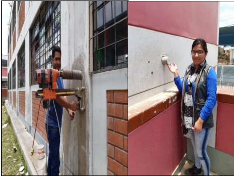
Figura 37: Extracción de corazones diamantinos
