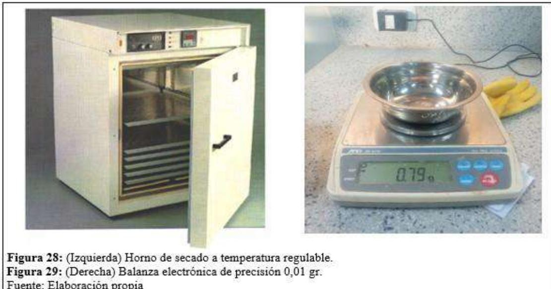
**Figura 28:** (Izquierda) Horno de secado a temperatura regulable.
