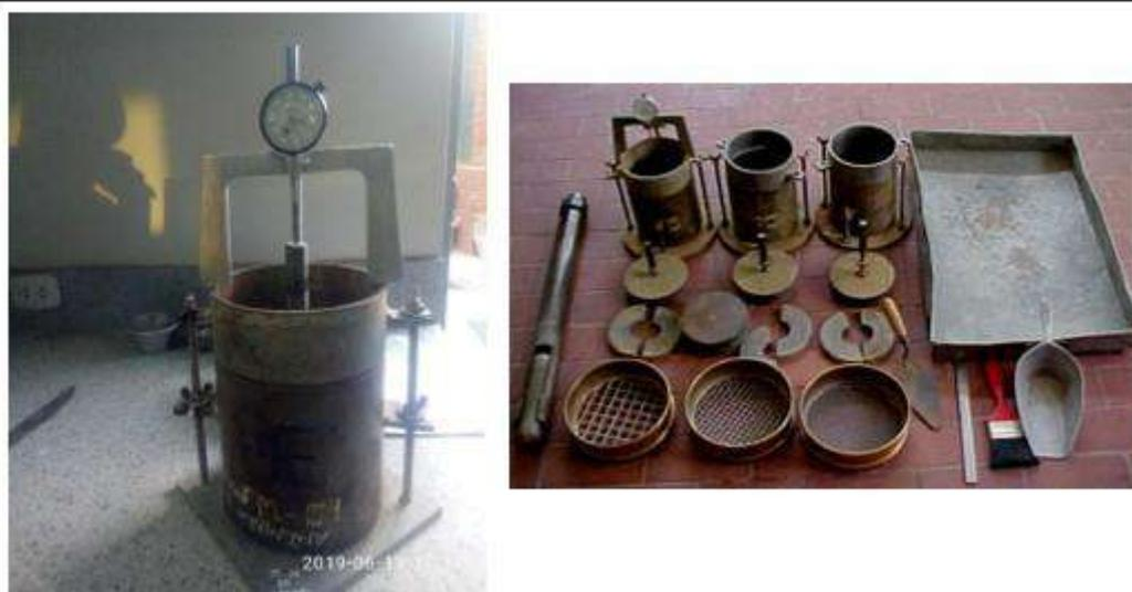
**Figura 41:** Lectura, medición y equipos de expansión para CBR.
