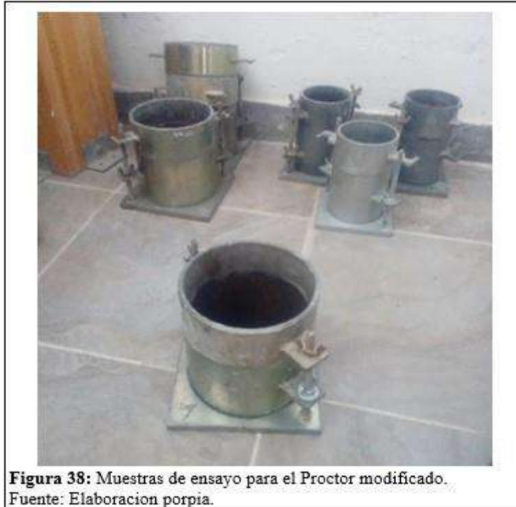
**Figura 38:** Muestras de ensayo para el Proctor modificado.
