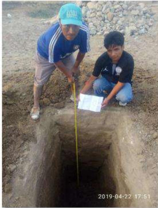
**Figura 25:** Extracción de la muestra natural.
