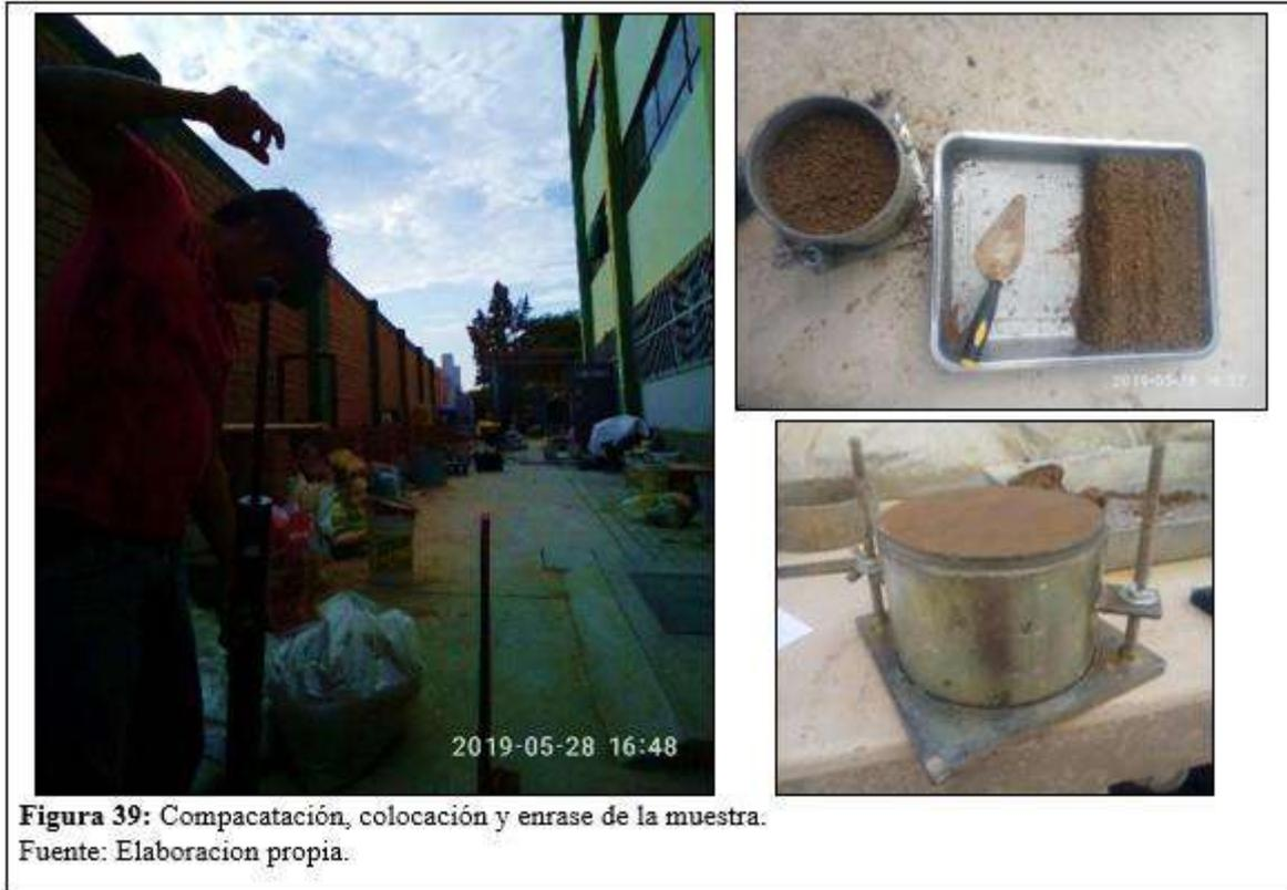
**Figura 39:** Compacatación, colocación y enrase de la muestra.
