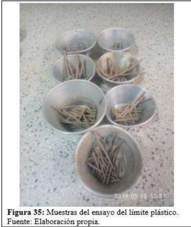
**Figura 35:** Muestras del ensayo del límite plástico.
