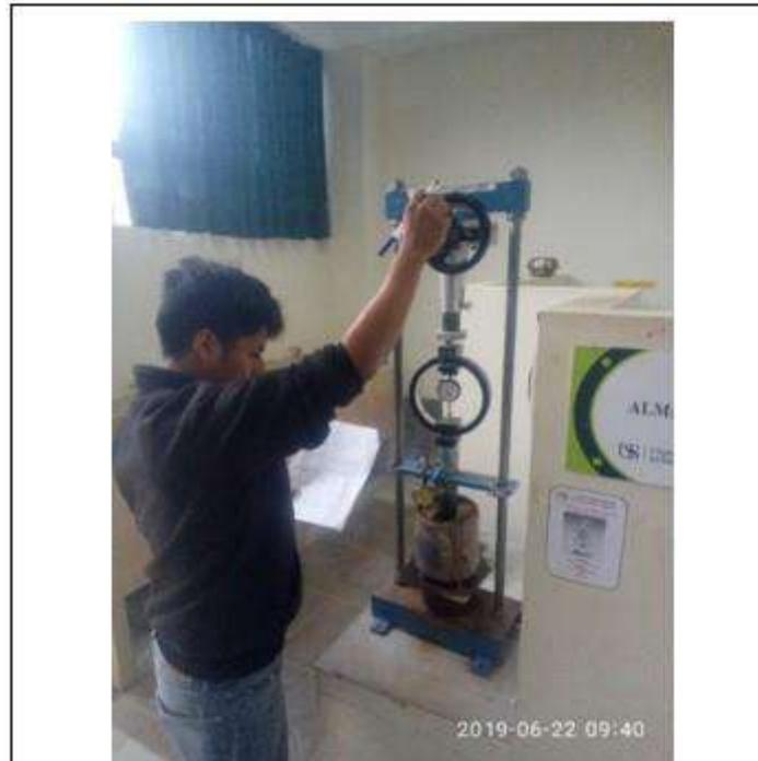
**Figura 40:** Procedimiento para el ensayo de penetración CBR.
