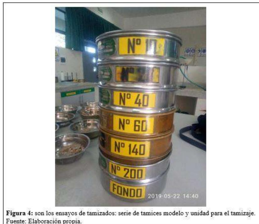
Figura 4: son los ensayos de tamizados: serie de tamices modelo y unidad para el tamizaje.
