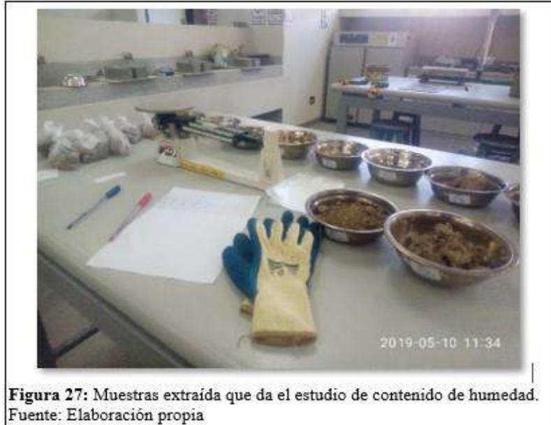
**Figura 27:** Muestras extraída que da el estudio de contenido de humedad.
