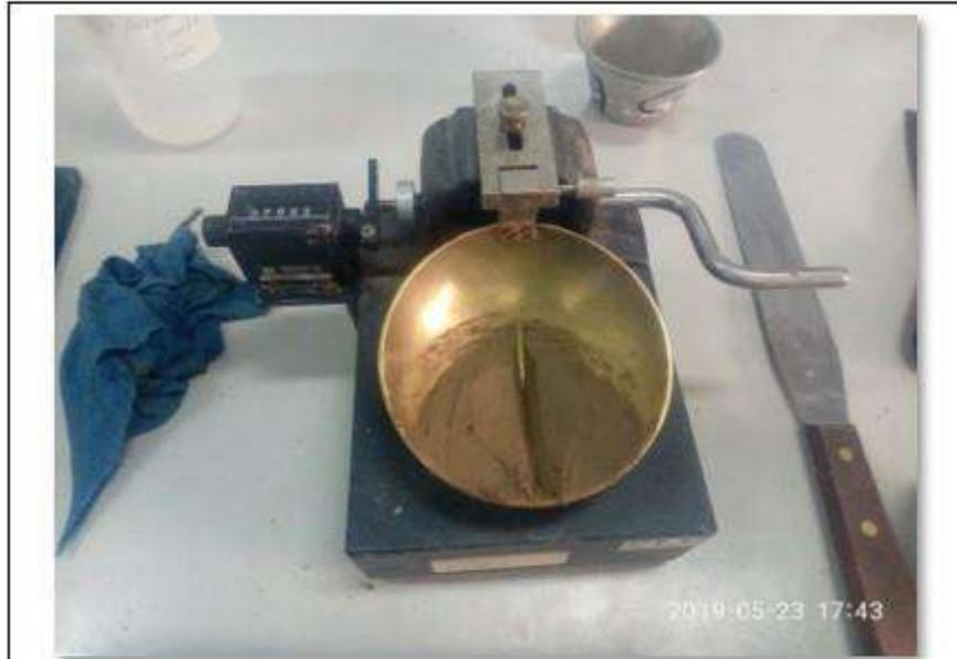
**Figura 33:** Copa de Casagrande para el ensayo de limite líquido.
