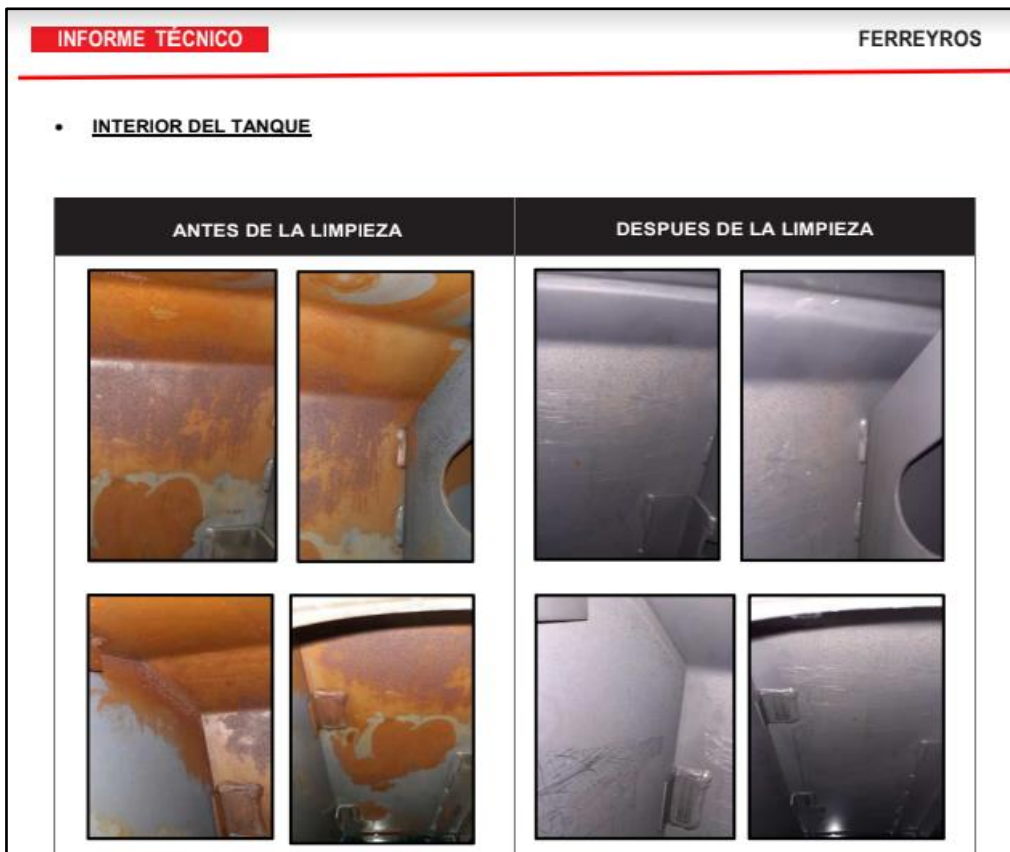
Figura 9. Tanque de combustible oxidado de una motoniveladora 140K
