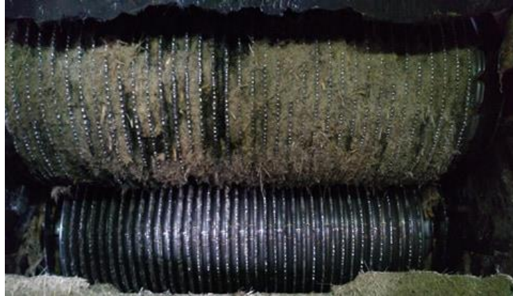
Figura No 13. Desgaste en los discos de las mazas Fuente: Propia, 2019
