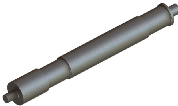
Figura No 25. Eje de la maza superior Fuente: Propia, 2020
