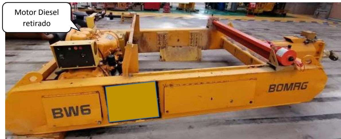
Figura 25: bastidor de rola de tiro sin tambor de accionamiento mecánico
