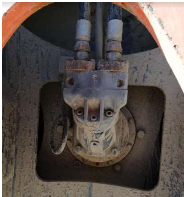
Figura 19: Motor hidráulico, sistema de vibración aprovechado Fuente: Equipo Hamm
