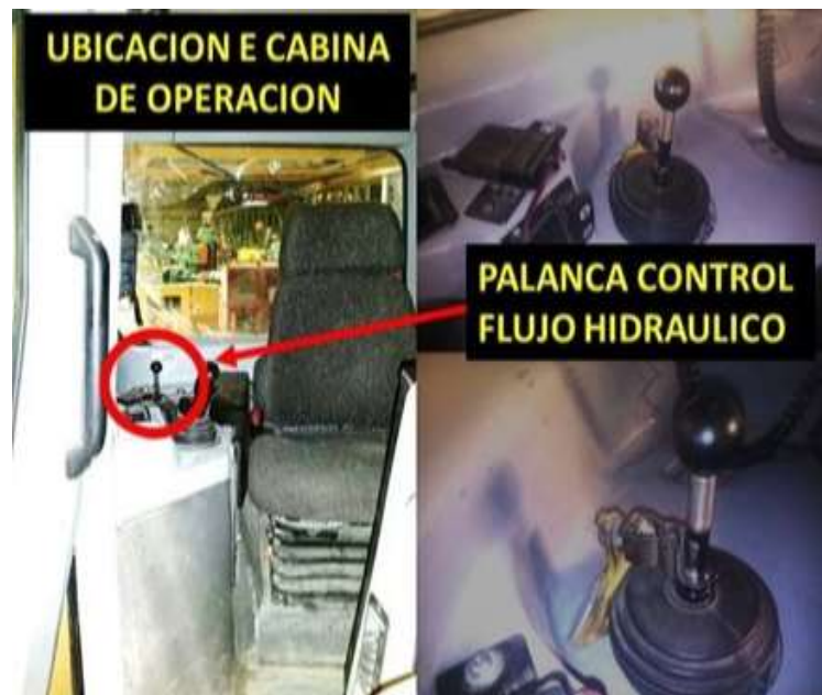
Figura 29: Modificación realizada en palanca de control en cabina
