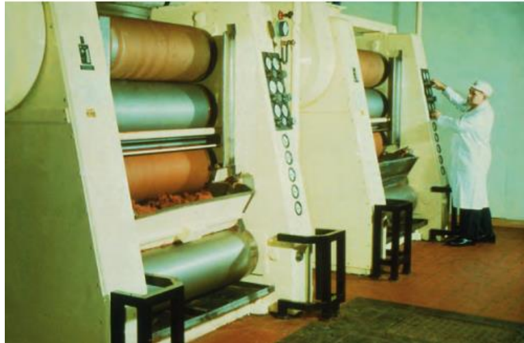
Figura 1.2. Diagrama esquemático de un refinador de cinco rodillos
