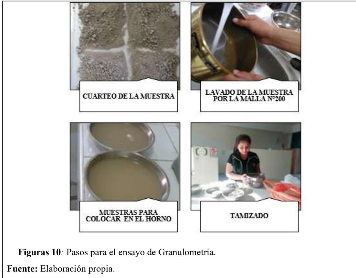
**Figuras 10:** Pasos para el ensayo de Granulometría.
