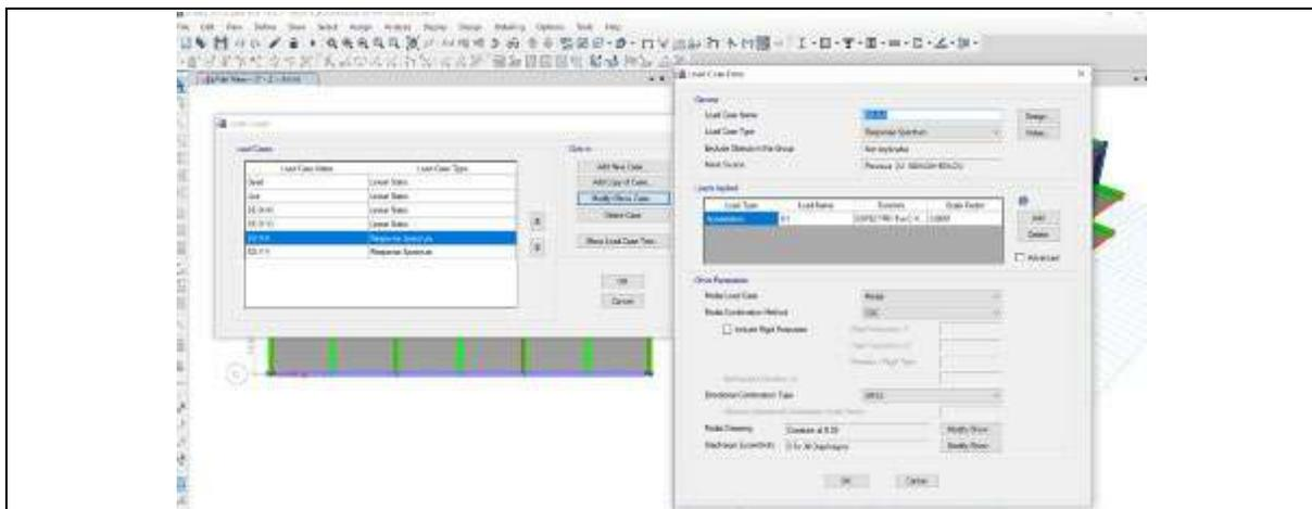
**Figuras 27:** Ícono “load case” permite determinar la aceleración espectral
