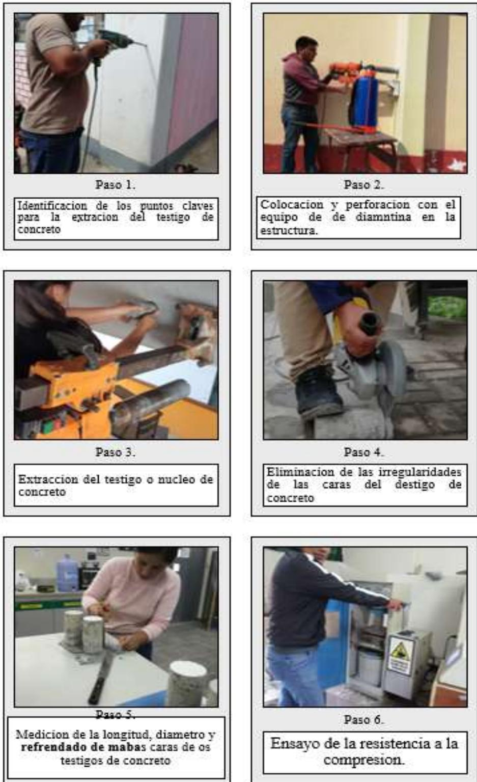
**Figuras 13:** Esquema secuencial del ensayo de diamantina
