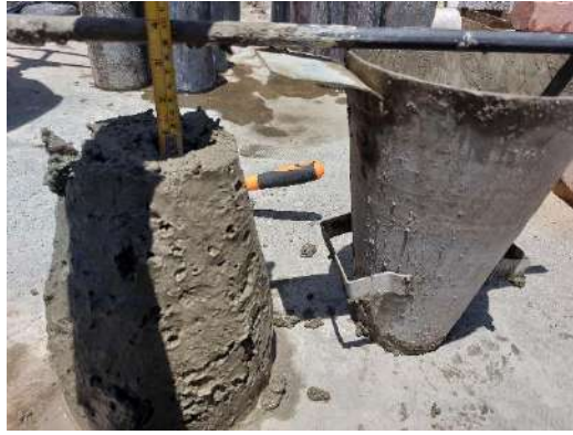
Figura 30 Medición de lecturas del asentamiento del concreto.
