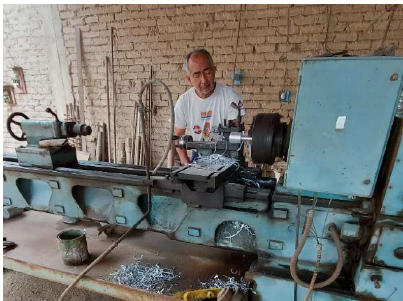
Figura 5. Proceso de cilindrado en un torno industrial.
