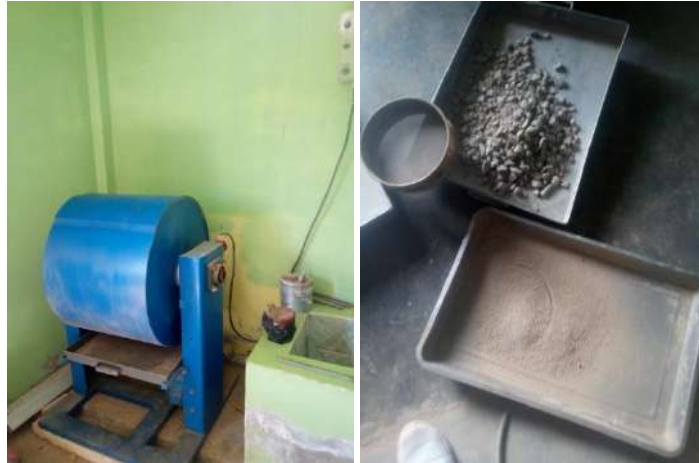
Figura 28 Ensayo de materiales en la máquina de los ángeles.
