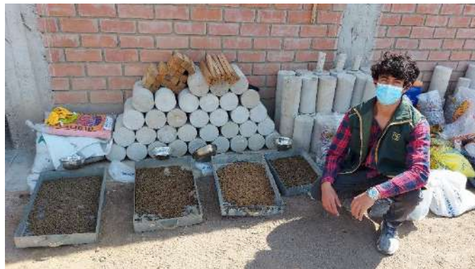
Figura 26 Secado de muestras de agregado fino para el ensayo de absorción.
