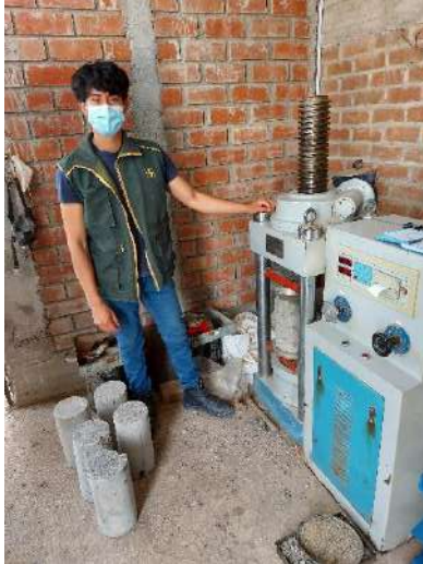
Figura 29 Probetas de muestra a edad de 7 días, para evaluación de la resistencia críticas de diseño f'_{cr} .
