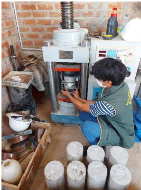
Figura 35 Ensayo módulo elástico del concreto.
