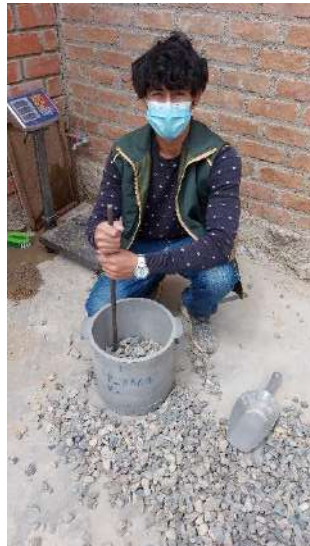
Figura 23 Realización del peso unitario compactado del agregado grueso.
