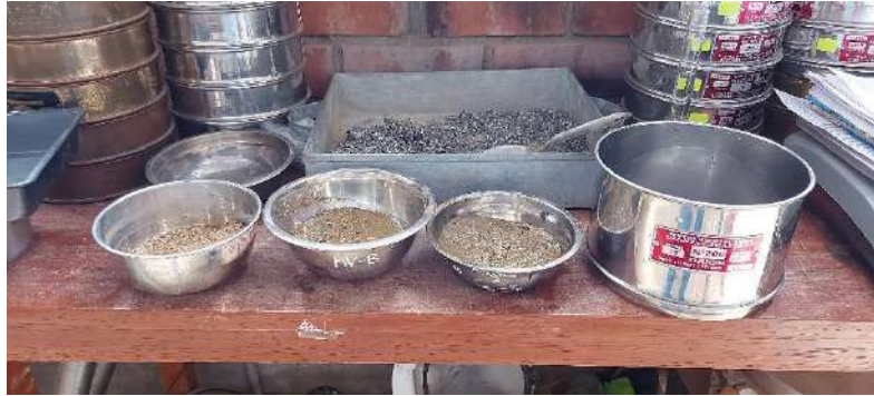
Figura 27 Tamizado de material por la malla 75 \mu m (N°200)
