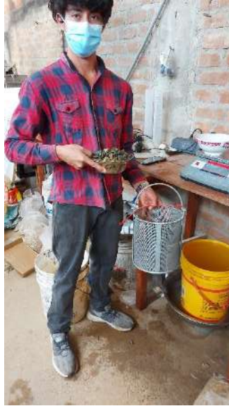
Figura 25 Realización del ensayo de peso específico y absorción de agregado grueso.
