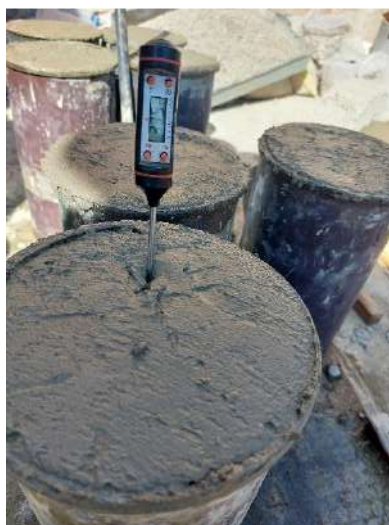
Figura 31 Medición de lecturas de la temperatura del concreto.
