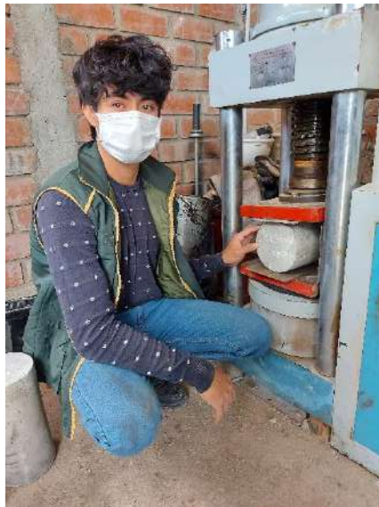
Figura 33 Ruptura de probetas en ensayo de tracción.
