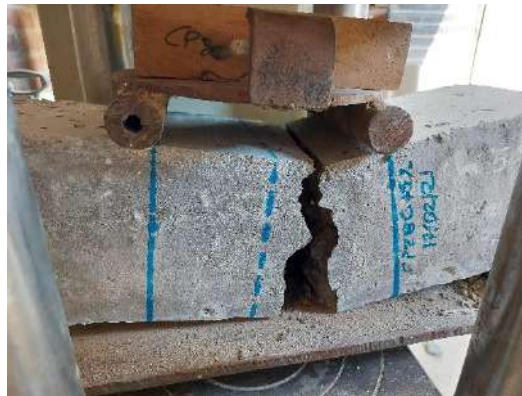
Figura 34 Ensayo de flexión carga en los tercios de la viga.
