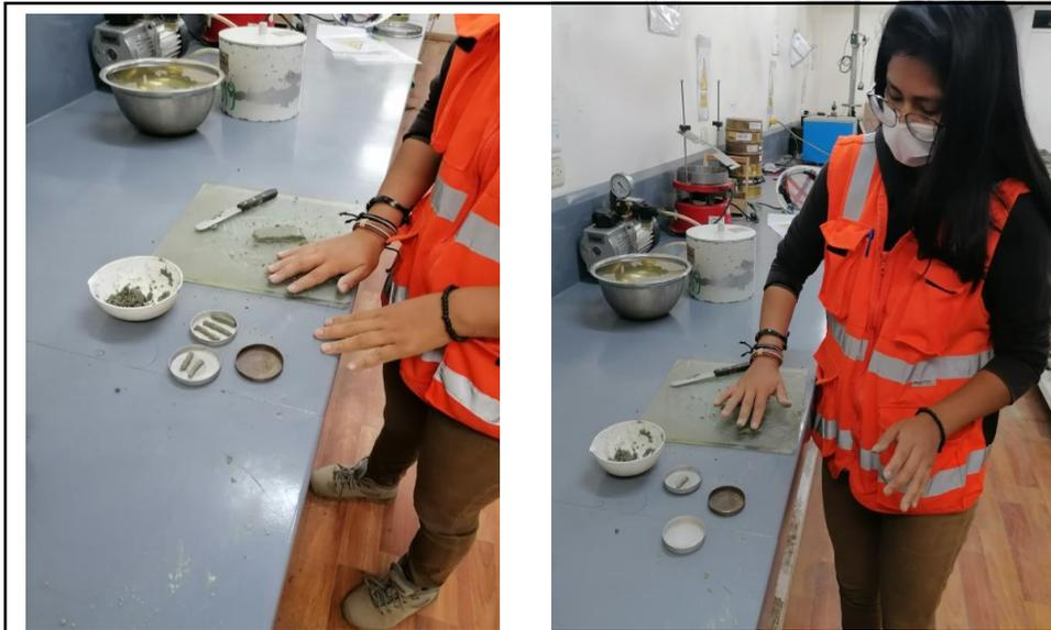
**Figura 29:** *Ensayos de Límites de consistencia.*
