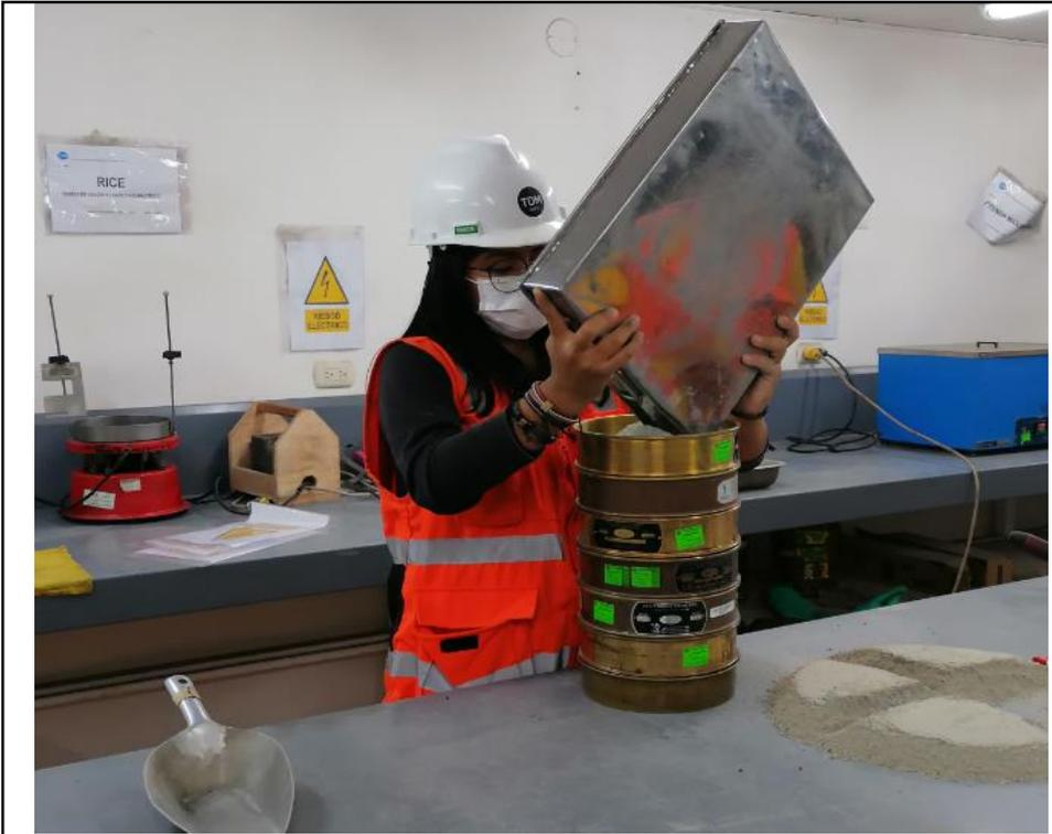
**Figura 37: Ensayos Granulométrico**
