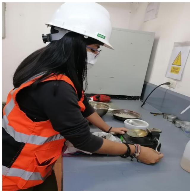
**Figura 30:** Ensayos de Límites de consistencia.
