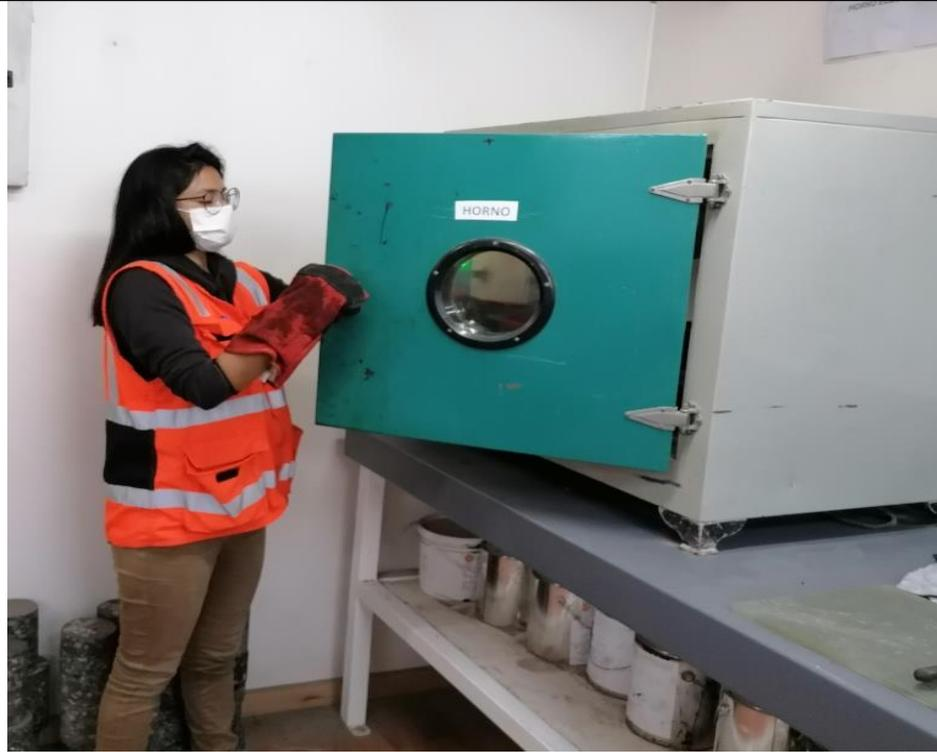
**Figura 26:** Colocación de la muestra al horno.
