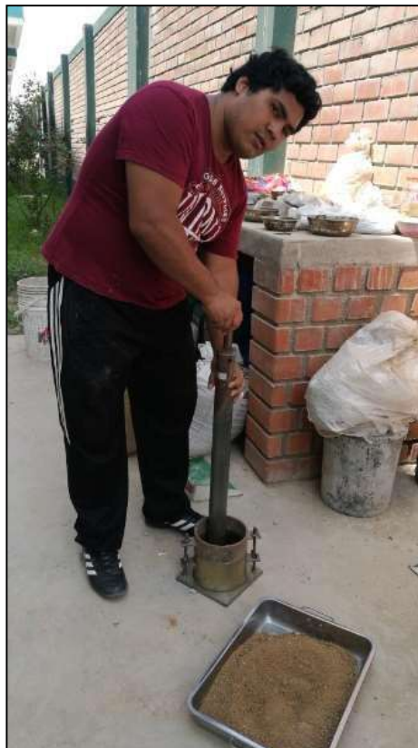
Figura n° 39: Compactado de muestra (5 capas) de cantera La Victoria con el método C.
