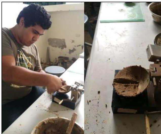
Figura n° 35: Ranuración de la muestra dentro de la copa Casagrande, para limite líquido.
