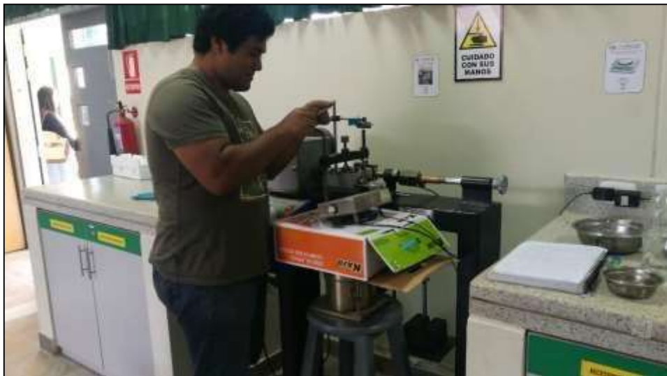
Figura n° 43: Toma de datos del ensayo, para una determinada carga aplicada.
