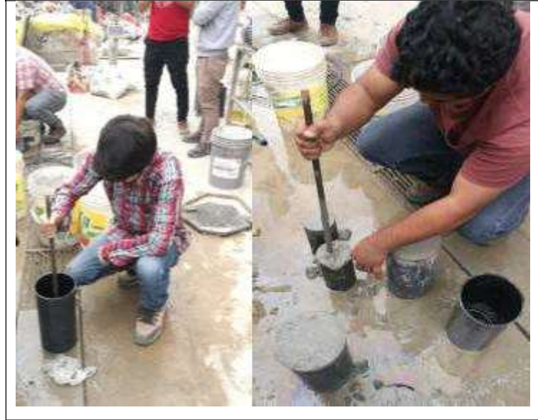
Figura n° 73: Chuzoneo de concreto por capas.
