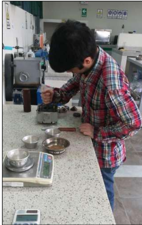
Figura n° 42: Compactado de muestra (3 capas) dentro del molde de sección circular
