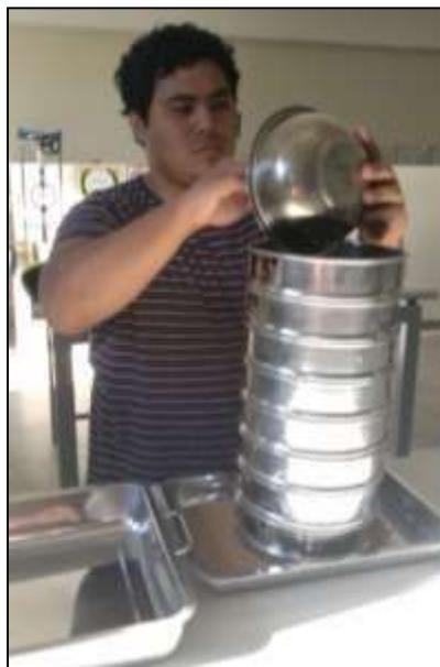
Figura n° 32: Tamizado del material de cantera
