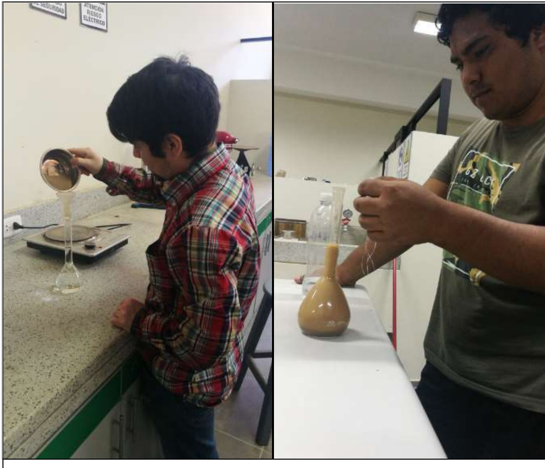
Figura n° 31: Colocado de la muestra a la fiola y medida de la temperatura.
