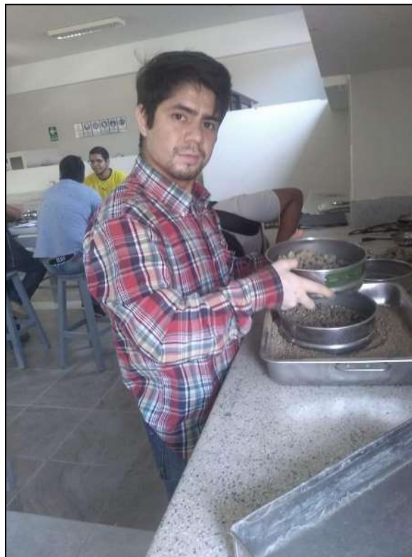
Figura n° 37: Tamizado de la muestra para hallar el método de compactación a usar.
