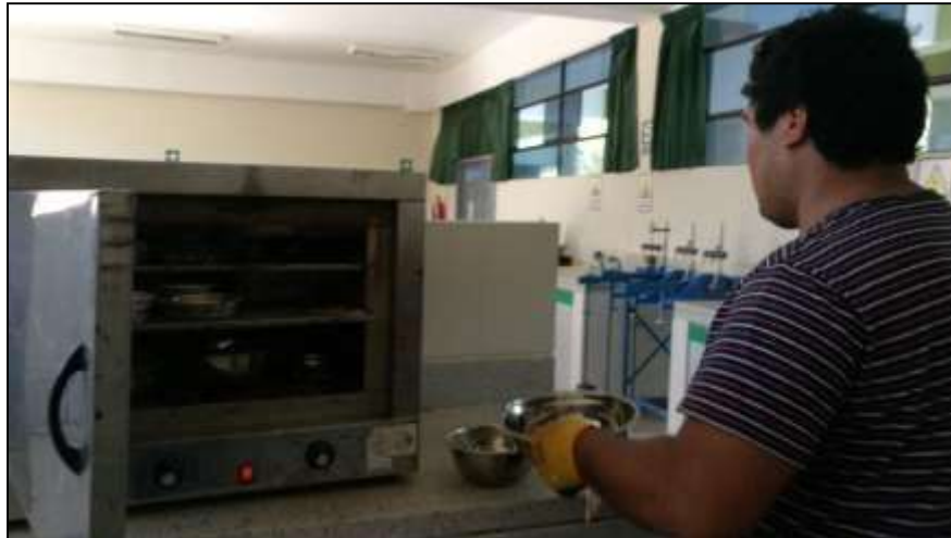
Figura n° 30: Colocado de las muestras al horno, para hallar contenido de humedad.
