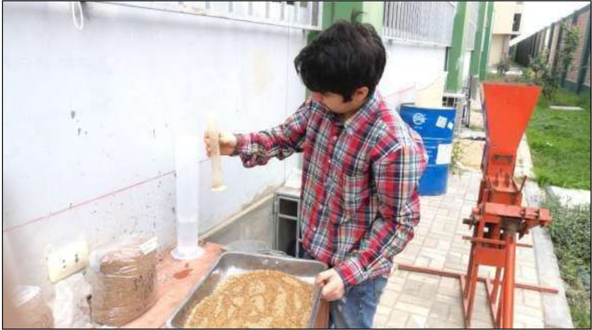
Figura n° 38: Incorporación de agua a la muestra a compactar.
