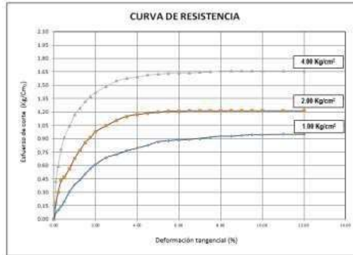
Figura n° 46: Gráfica de Curva de Resistencia ensayo Corte Directo, cantera Tres Tomas.
