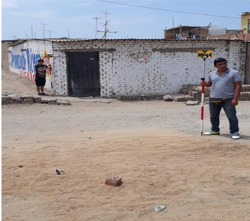
*Anexo 48: Instalación de primas para su posterior levantamiento*
