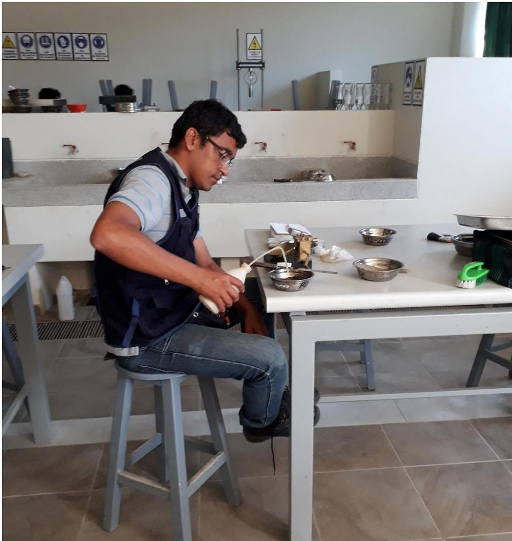
*Figura 70: Saturación de las muestras para Limite Líquido*
