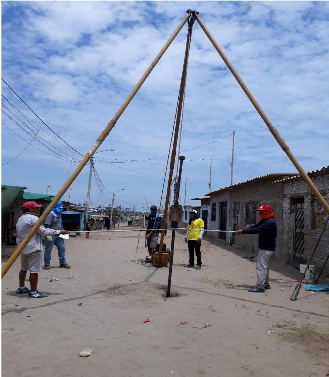
*Figura 64: Ensayo SPT*
