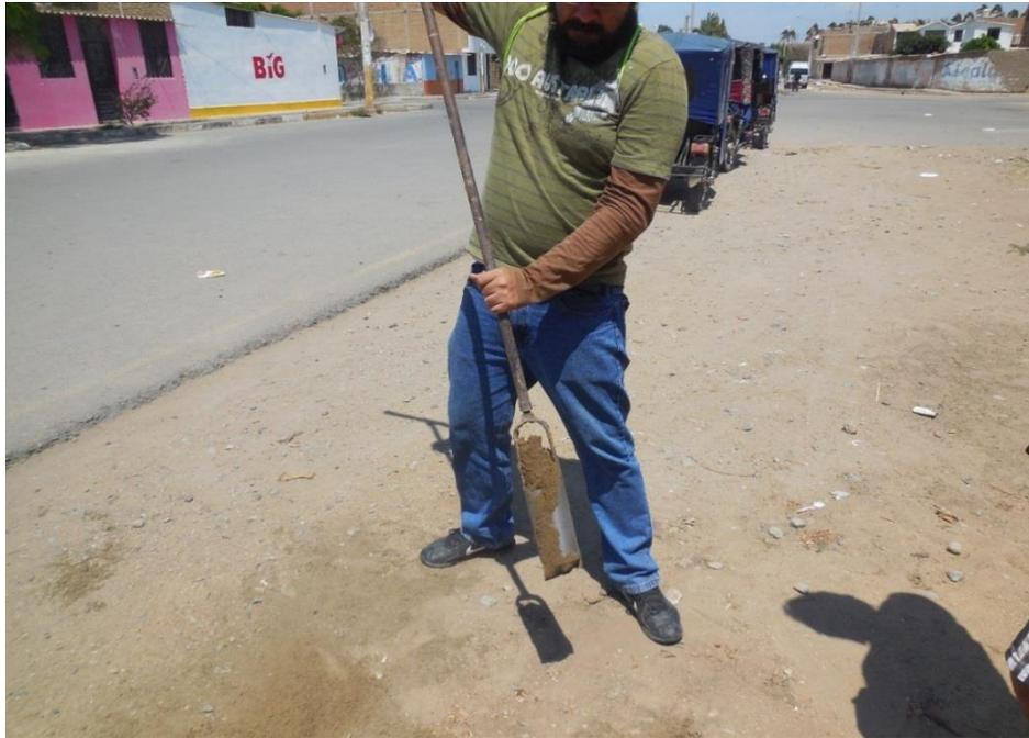
*Figura 53: Extracción de muestras con posteadora*
