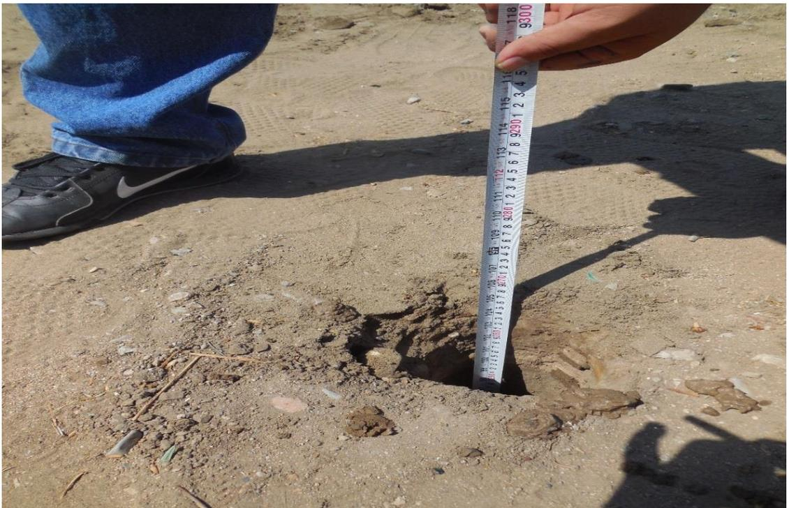
*Figura 56: Medición de la profundidad del pozo de exploración*
