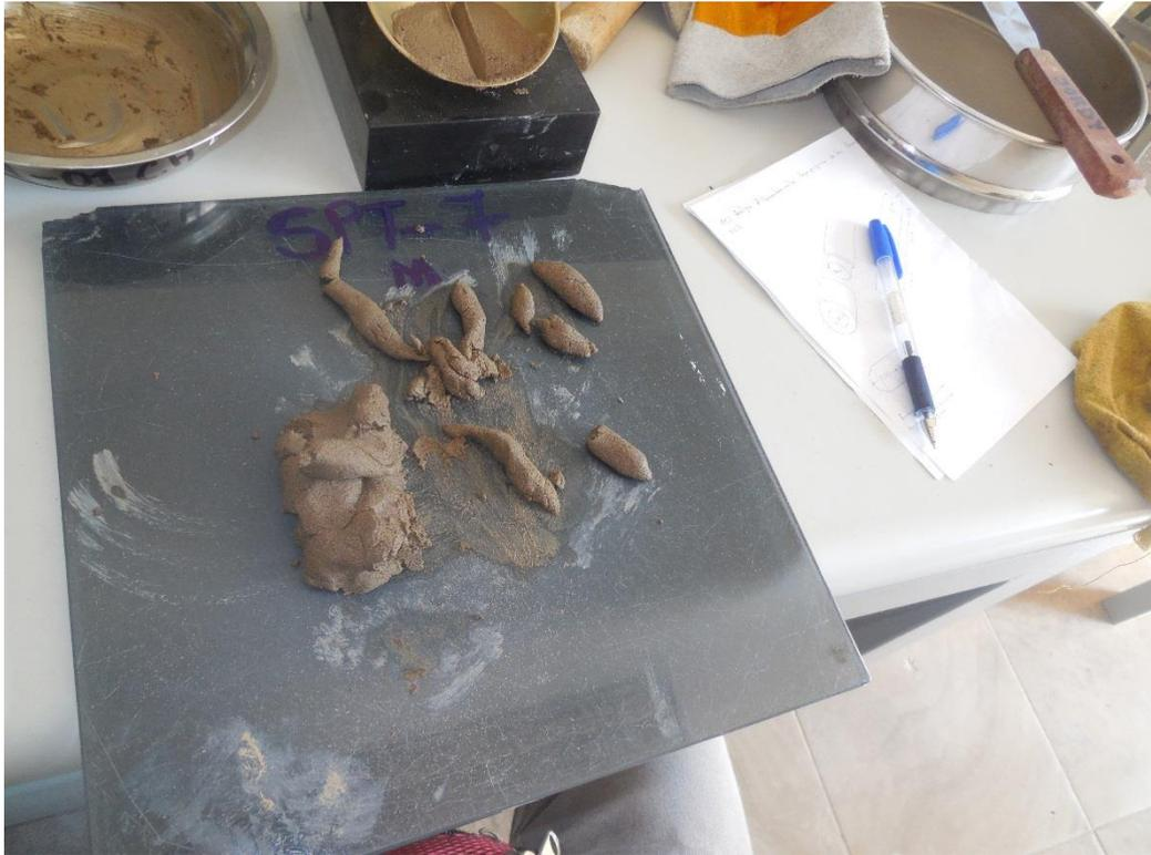
*Figura 73: Formación de cilindros para ensayo de Límite Plástico*
