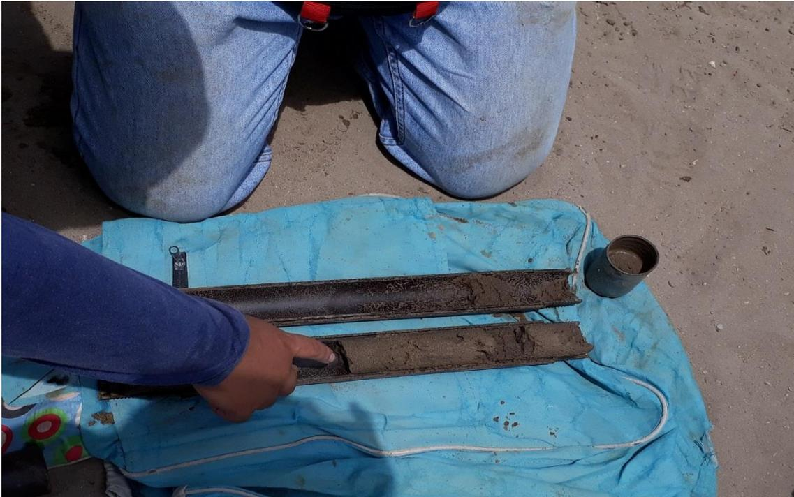
*Figura 5: Se aprecia que la napa freática es alta. Encontrando muestra húmeda mayormente siendo arenas mal gradadas*
