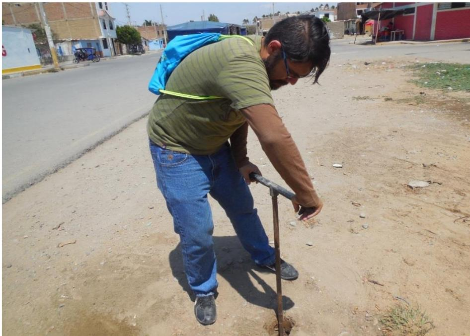
*Figura 52: Proceso de exploración con posteadora*
