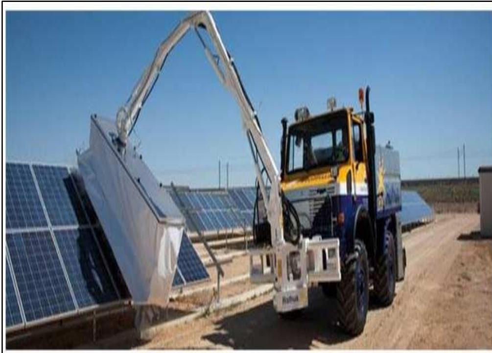
*Figura 4. Equipo de limpieza solar bright con vapor de agua
