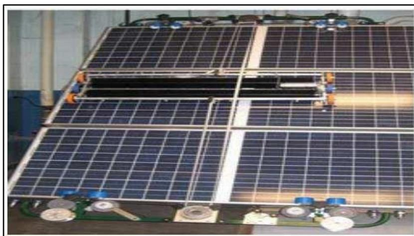
*Figura 14. Desplazamiento del robot V1.0 a lo largo de paneles
