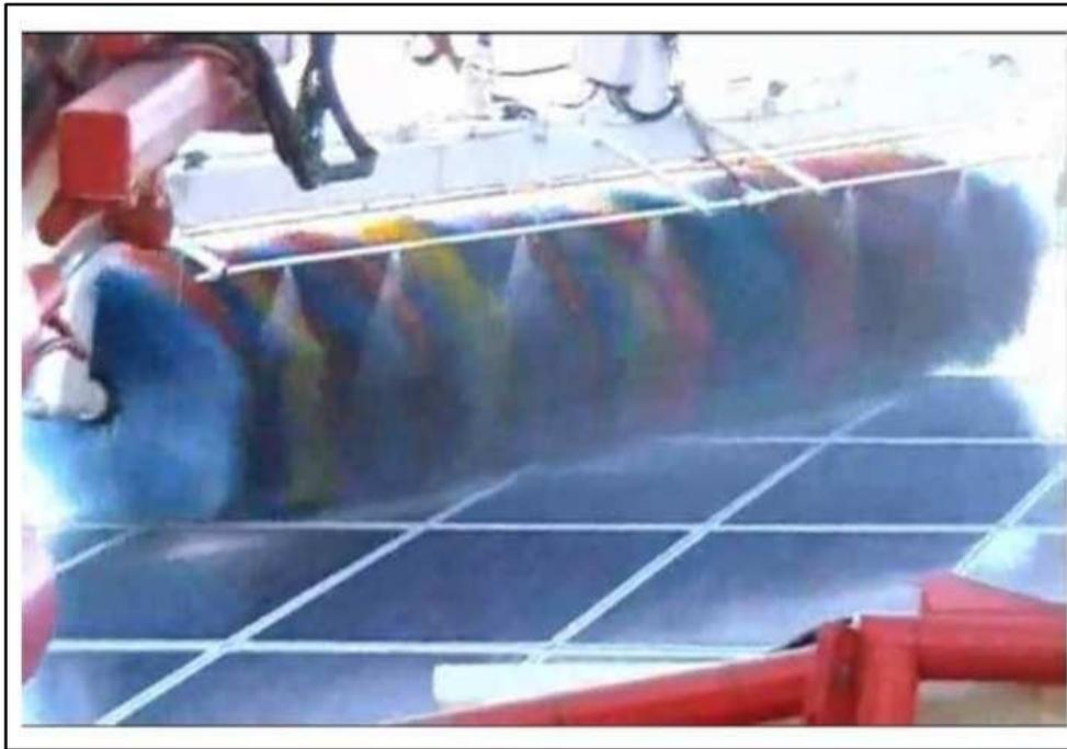
*Figura 6. Limpieza de paneles*
