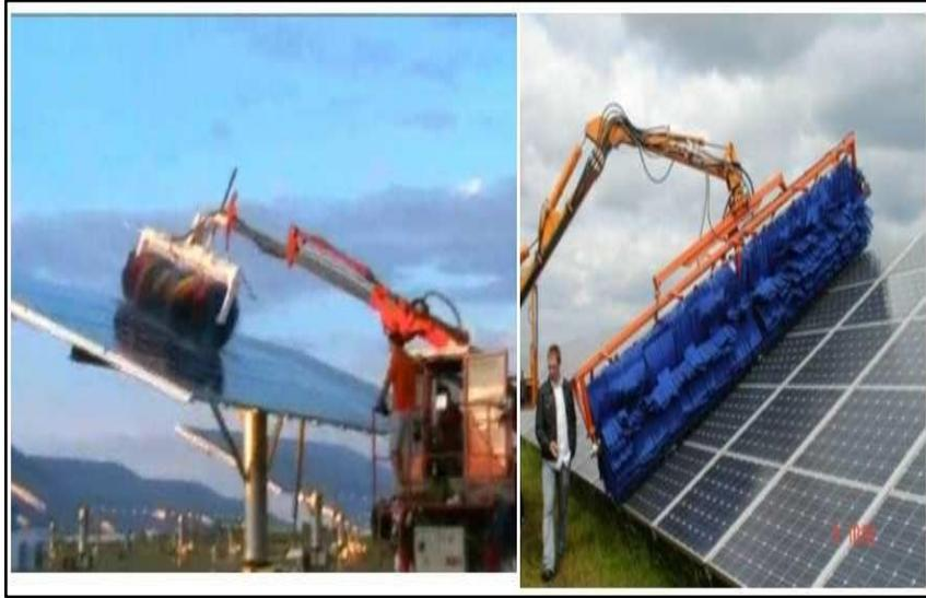
Figura 5. Equipos de limpieza - autopropulsores fijas y seguimiento.
