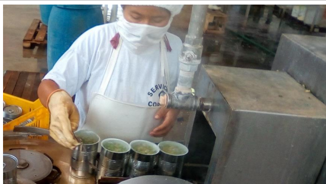
Figura 27: Ingreso de latas por el exhausting
