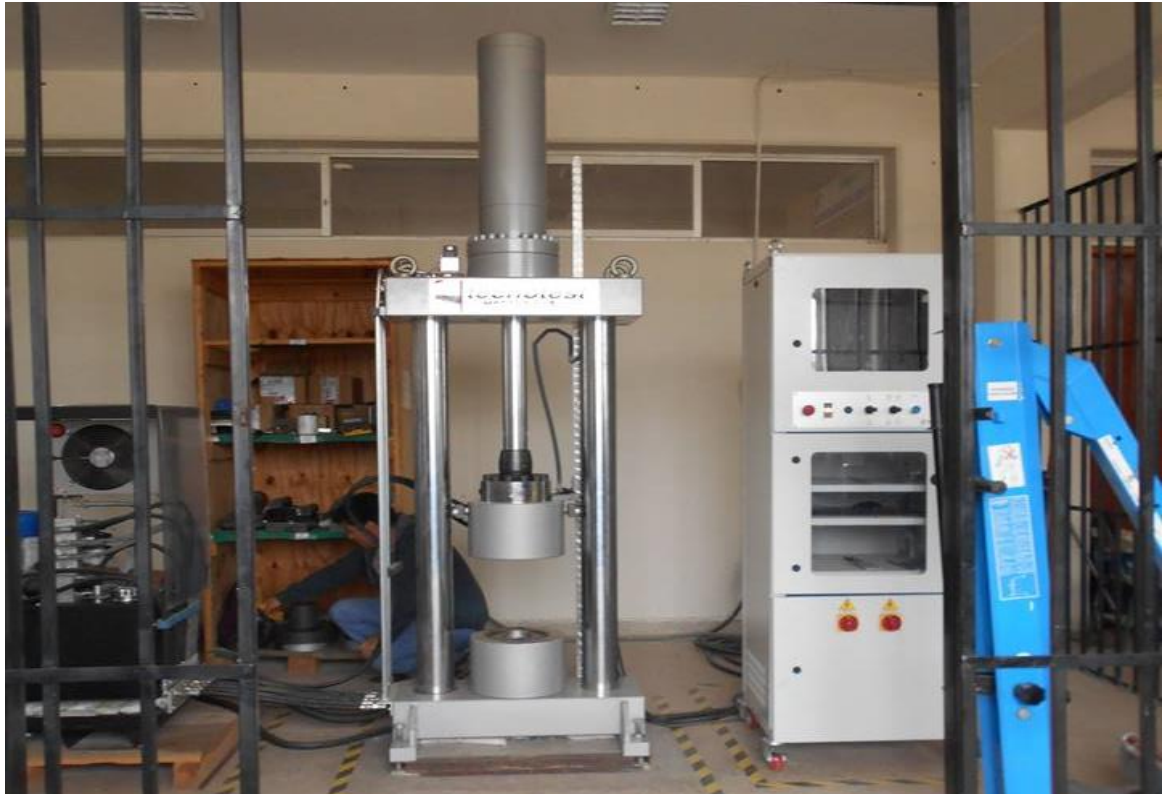
Figura 13: Máquina de ensayo universal con la que se realizó la prueba piloto
