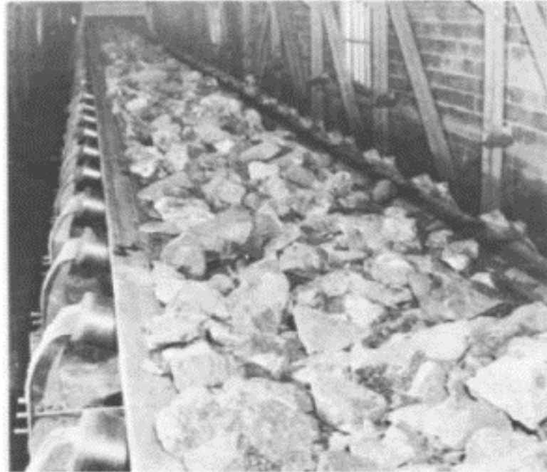
Figura 4. Transportador de 54” con inclinación transportando terrones grandes de mineral abrasivo.
