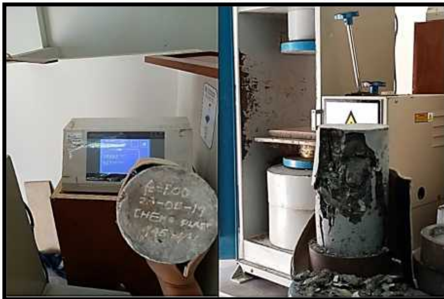
Figura 14: Compresión de probetas cilíndricas de 20x10 cm y forma de ruptura
