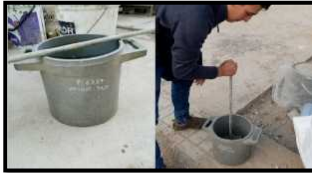
Figura 6.- Molde sin varillar y varillado.
