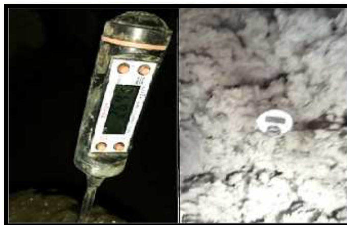
Figura 13: Temperatura del concreto en diferentes horarios
