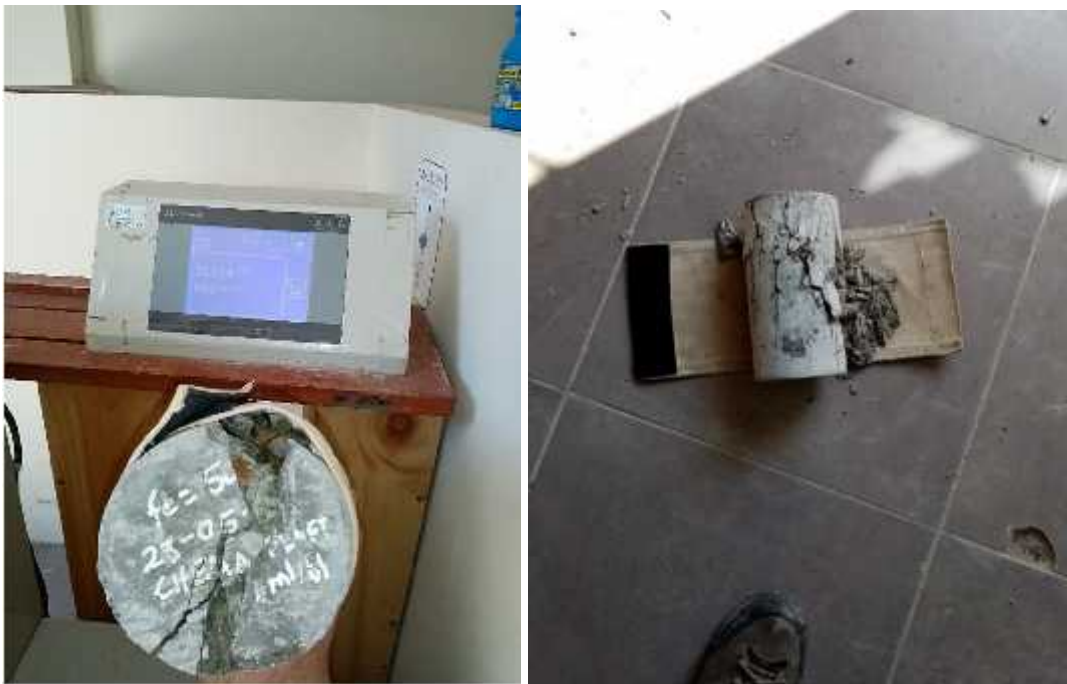
Foto 6: Tipo de fisura de concreto de 350, 420 y 500 kg/cm 2
