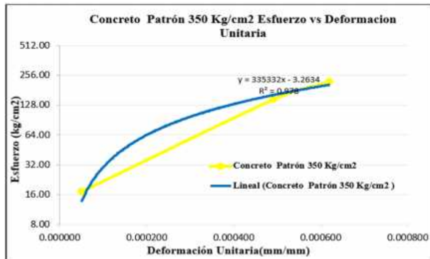
Figura 60.- Esfuerzo vs deformación de concreto patrón 350kg/cm2
