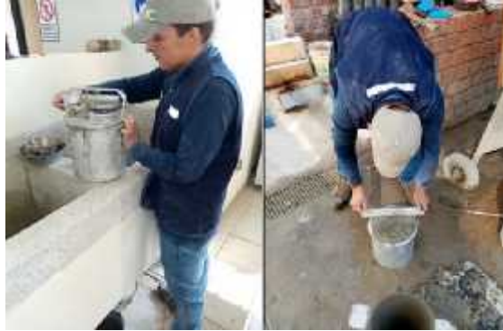
Figura 12: Contenido de aire con la olla de Washington.
