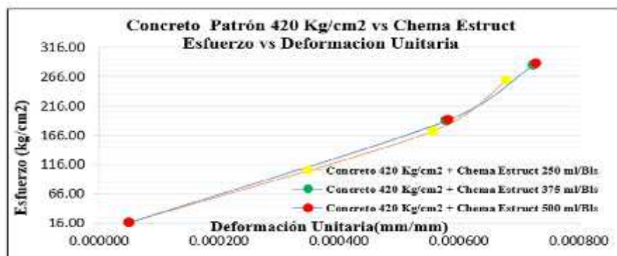
Figura 75.- Esfuerzo vs deforma de concreto 420kg/cm 2 más Chema Estruct 250 ml/bls, 375 ml/bls y 500 ml/bls
