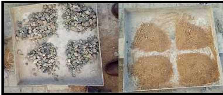
Figura 4.- Cuarteo del agregado grueso y fino.
