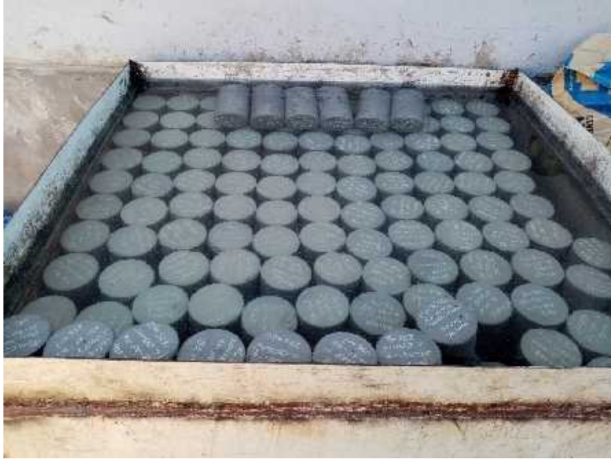
Foto 5: Curado de las probetas a los 7, 14 y 28 para Chema plast y 3, 7,14y para el concreto patrón de 3, 7, 14 y 28.
