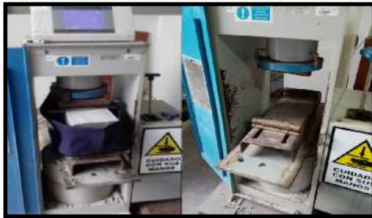
Figura 16: Ensayo para determinar la resistencia a la flexión en las vigas simplemente apoyadas.
