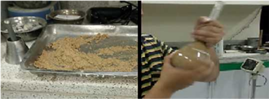
Figura 7.- Sacando el aire atrapado para para determinar el contenido de humedad.
