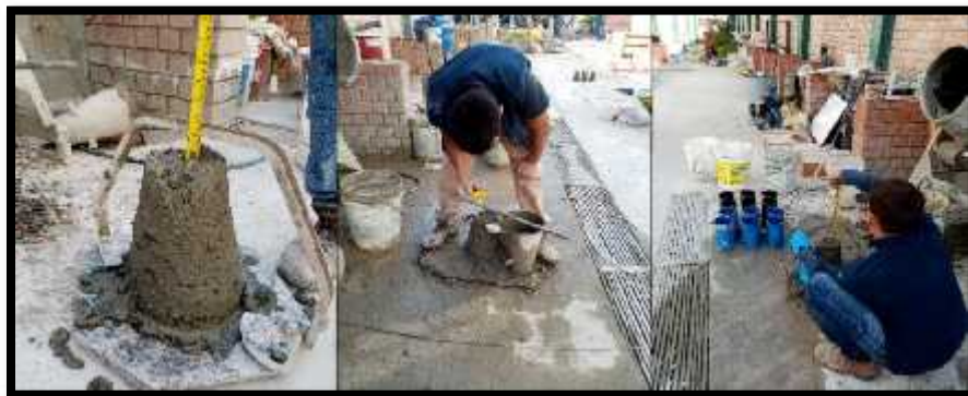
Figura 11: Asentamiento del concreto patrón vs con aditivo
