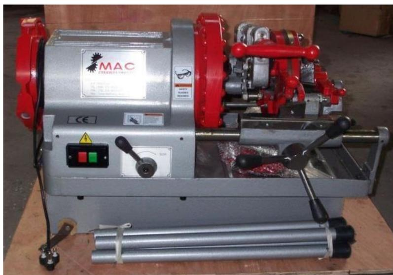
**Figura 7.** Máquina Roscadora de la empresa.
