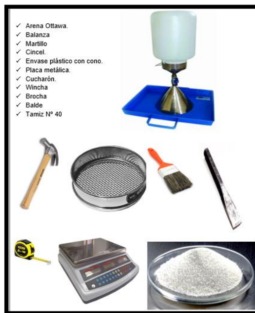
Figura N° 18: Instrumentos para el ensayo de densidad de campo
