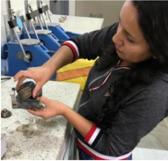
Imagen N° 29: extracción de muestra cortada
