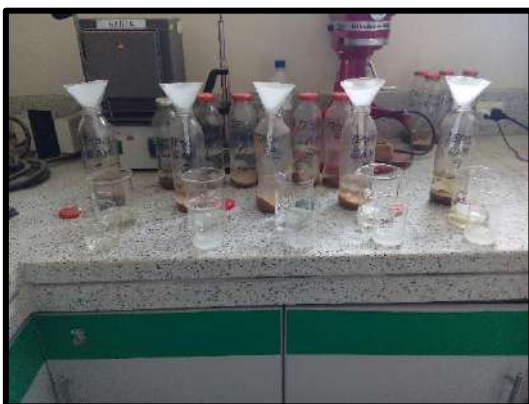
Figura 124. Se puede apreciar en esta foto el respectivo ensayo realizado en la universidad con respecto a cloruros y sulfatos
