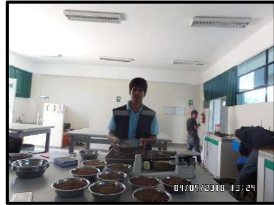
Figura 115. Se puede apreciar en la foto tamizando la muestra para agragado fino como para agrado grueso por la malla N°40
