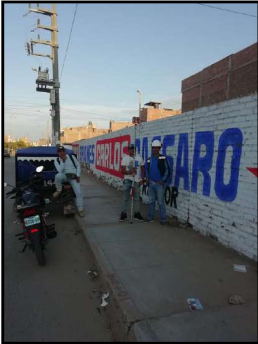
Figura 35. Cambio de estación PL-10 para seguir con el cierre de la poligonal cerrada.
