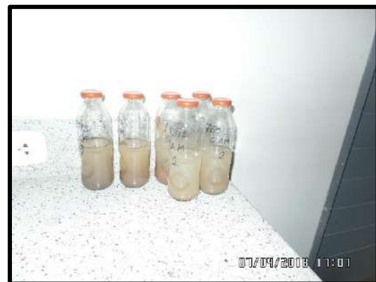
Figura 121. Se puede apreciar en esta foto las muestras identificadas y dejando en reposo para que se asiente y poder ser ensayadas al dias siguiente su respectivo ensayo.
