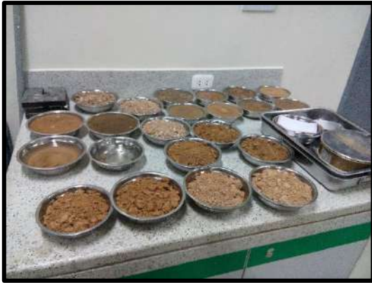
Figura 112. Se puede apreciar en la foto todas las muestras pesadas en forma natural antes de poner al horno y poder realizar en ensayo granulométrico.
