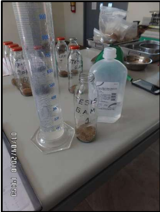
Figura 118. Se puede apreciar en esta foto para respectivo ensayo de sales totales tomando un porcion de muestra de 50 gr y en botellas de vidrios con una relacion 1:5.
