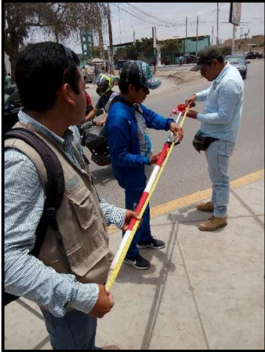
Figura 18. Miendo los bastones al eje de prisma para tomar las lecturas respectivas en la estación total.
