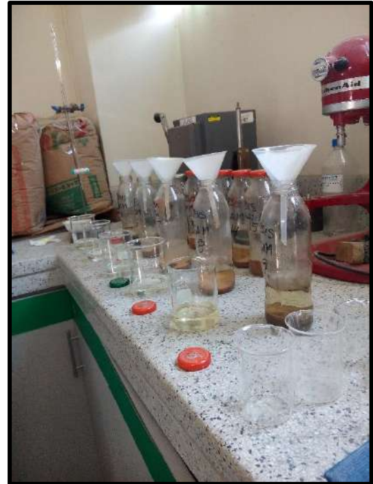
Figura 125. Otra toma de las muestras con el respectivo ensayo de cloruro.
