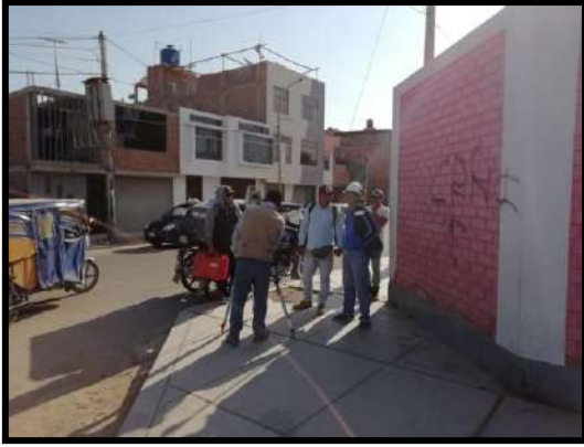
Figura 26. Se realizo la poligonal cerrada de la Urbanización, en este caso se puede ver la Estacion a un costado del Colegio Salazar Bondi.
