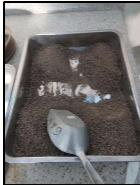
Figura 110. Se puede apreciar en esta foto el cuarteo respectivo para realizar en ensayo de granulometria y contenido de humedad.
