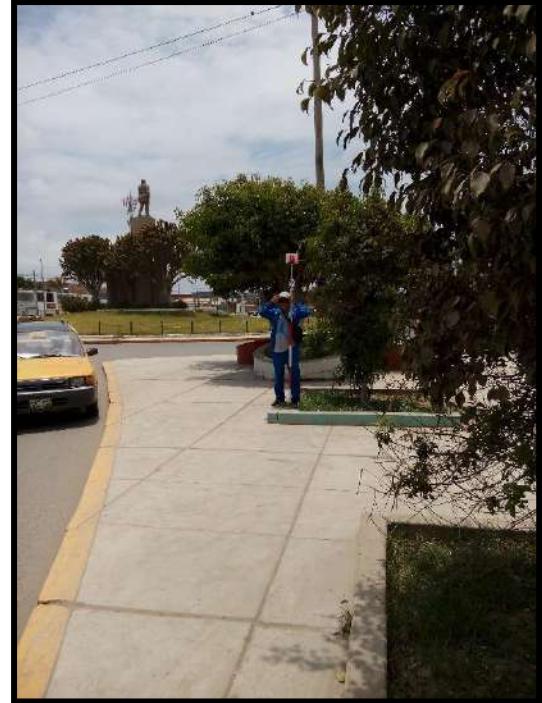
Figura 20. Se realizo la toma de lectura de vista atrás del punto geodesico.
