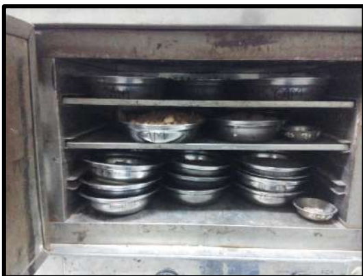
Figura 113. Se puede apreciar las muestras sometidas al horno por 24 horas para proceder el respectivo ensayo.
