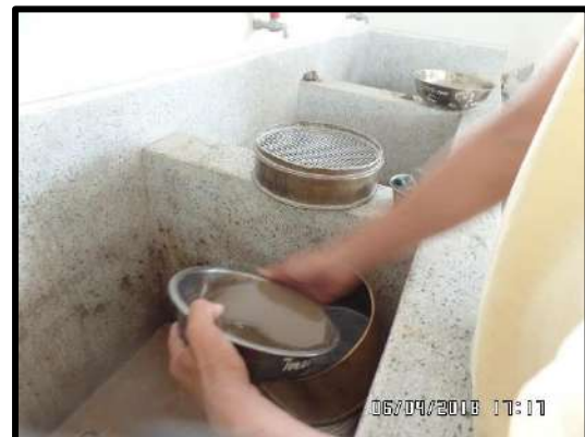
Figura 116. Se puede apreciar en esta foto de como se esta lavando la muestra y pasando por la malla N° 200.
