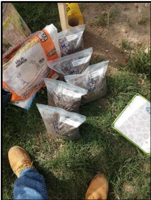
Figura 104. Se puede apreciar en esta toma la extracción de muestras de la primera calicata.
