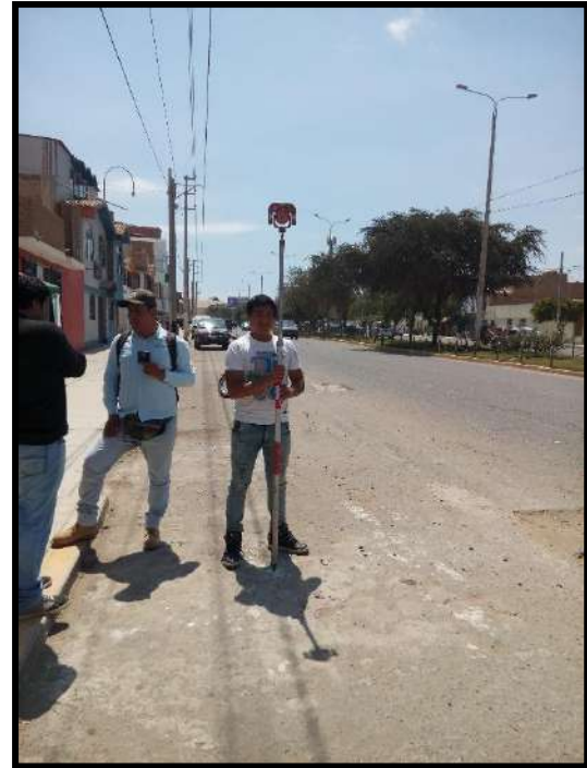
Figura 24. Vista del porta mira en la toma de lectura para cambio de estación.
