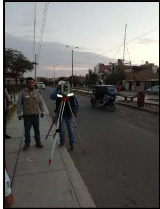
Figura 37. Culmino con la de estación PL-14 para el cierre de la poligonal cerrada.
