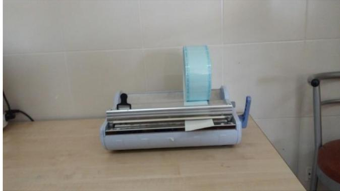
Selladora de calor, en este equipo se realiza el sellado de las bolsas con el contenido en el interior con un indicador químico (cinta testigo 3M).
