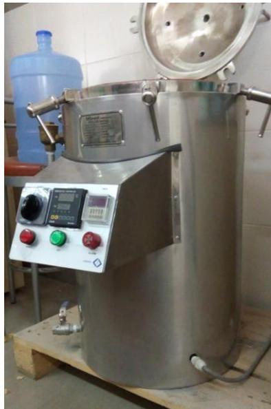
En la autoclave de la universidad señor de sipan colocamos a esterilizar las bolsas de papel plástico con el contenido a 121 ° C y 15 psi durante 30 min.
