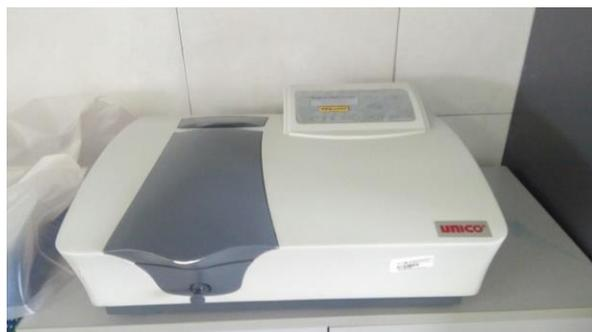
En el espectrofotómetro S 2100UV+ se realizaron las lecturas después de las 24 horas en la incubadora a una longitud de onda de 550NM según la página de espectrofotometría de absorbancia.
