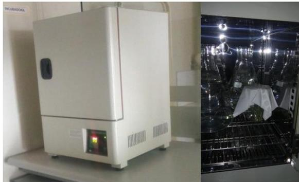
En la incubadora se procedio a dejar incubando las muestras a una temperatura de 37°C por 24 horas y poder realizar las lecturas de los microorganismos presentes en los segmentos de las bolsas esterilizadas.
