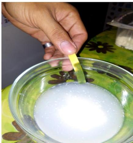
**Figura 41 :** Medición del ph diluido en agua
