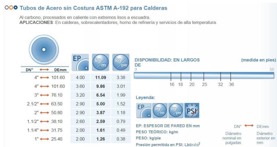
Figura 2: Tubos de Acero sin Costura ASTM A-192 para Calderas
