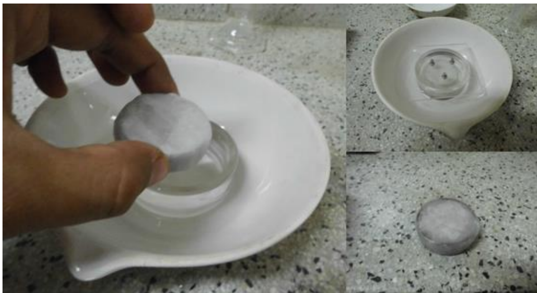
Figura 35. Pastilla de suelo con parafina para determinar el volumen final
