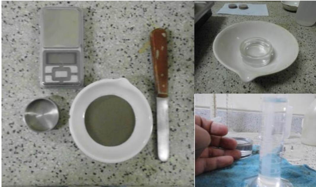
Figura 34. Equipos para límite de contracción
