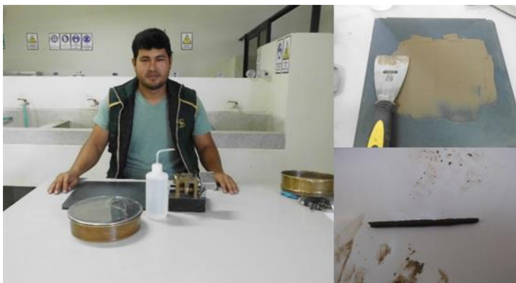
Figura 32. Límite plástico del material en estudio.
