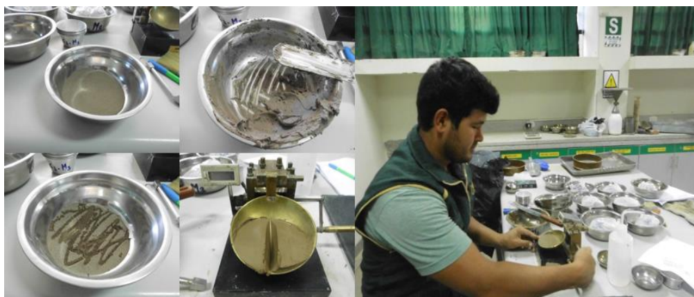
Figura 31. Límite líquido del material en estudio.
