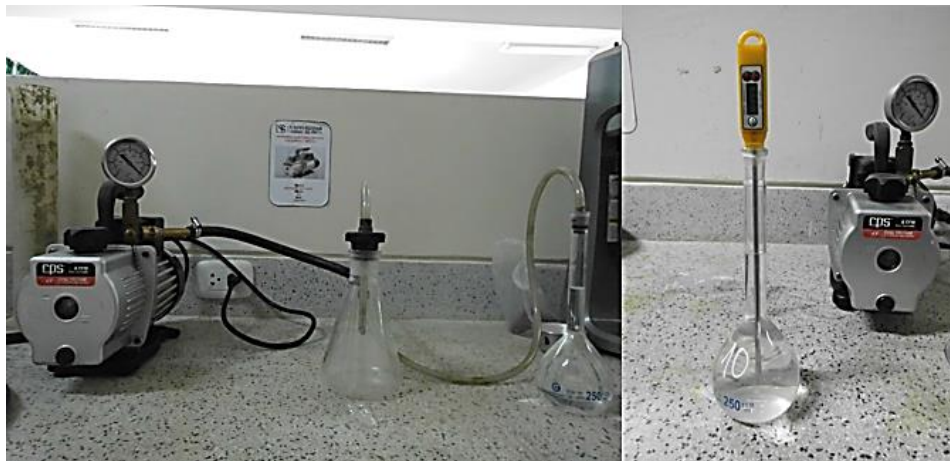
Figura 39. Eliminación del aire y calibración de la fiola
