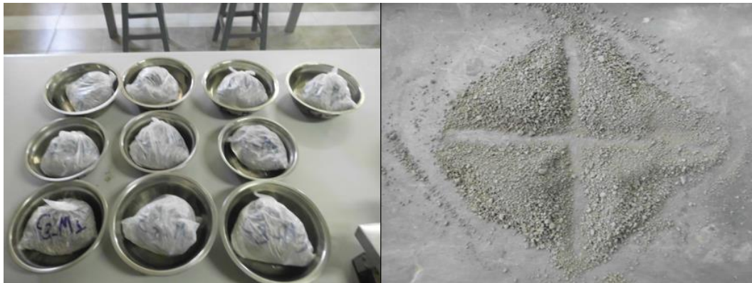
Figura 27. Cuarteo para obtención de muestras a ensayar.
