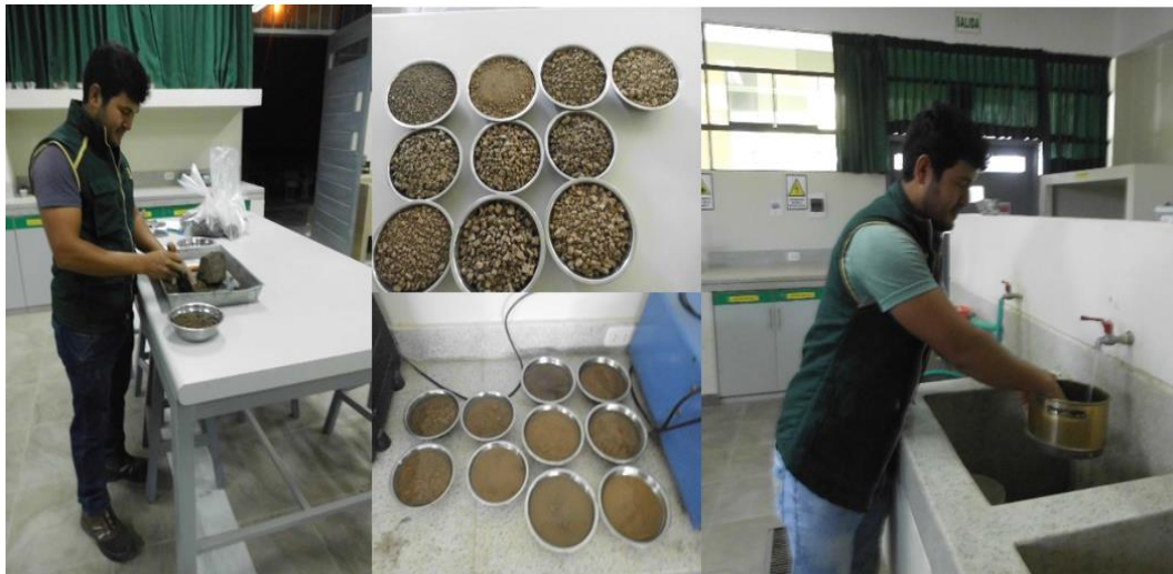
Figura 29. Granulometría por lavado del material en estudio.
