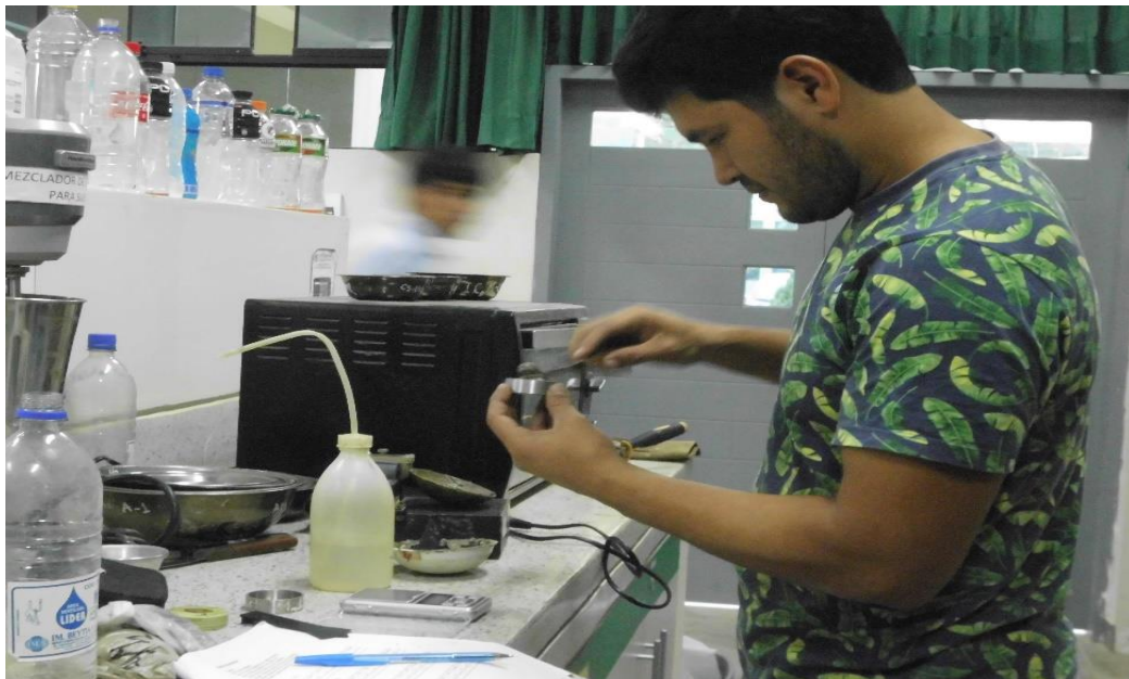
Figura 33. Colocación de la muestra de suelo en el plato de contracción
