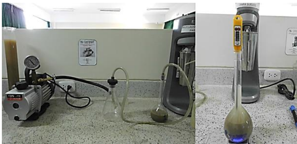
Figura 40. Eliminación del aire con la muestra y peso total del ensayo
