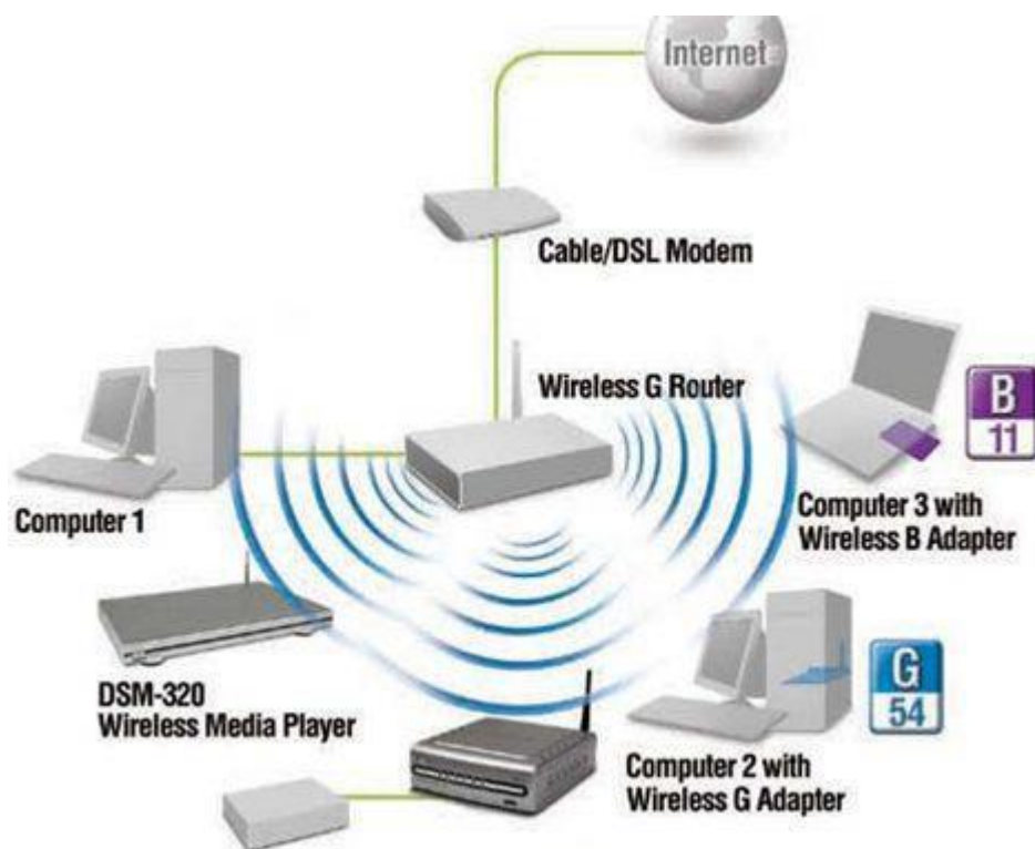
Ilustración 3 Funcionamiento de una red WIFI
