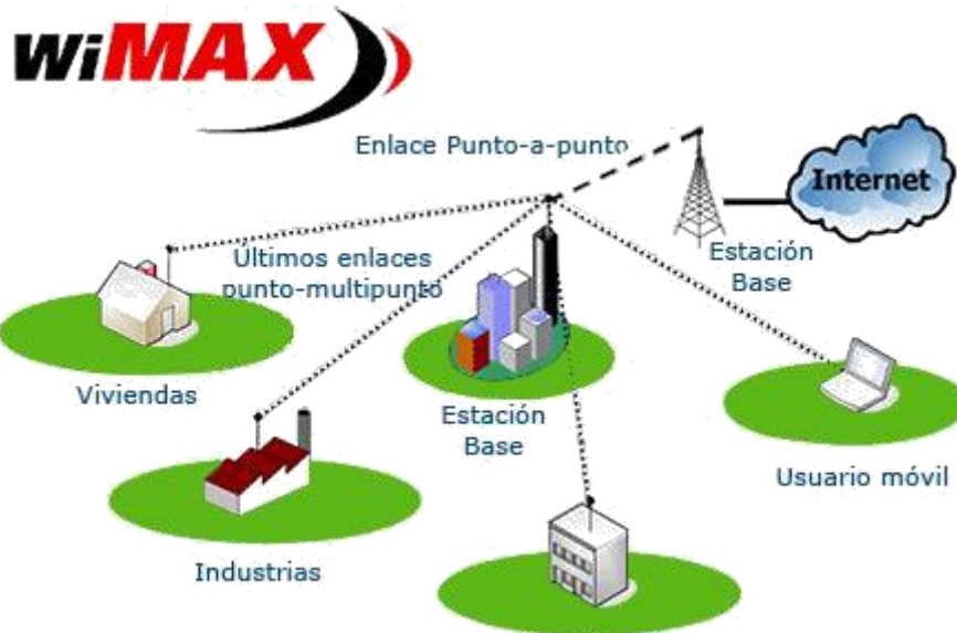
Ilustración 5 Funcionamiento de una red Wimax
