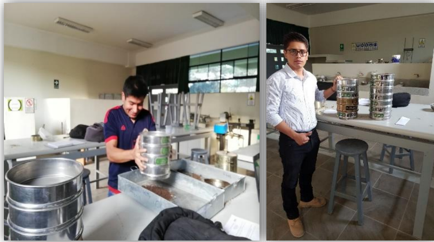
Figura 21. Tamizado granulométrico de las muestras de suelo. Fuente: Elaboración propia.
