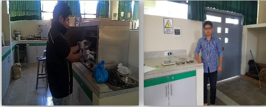
Figura 22. Ensayo de contenido de humedad para las muestras de suelo Fuente: Elaboración propia.
