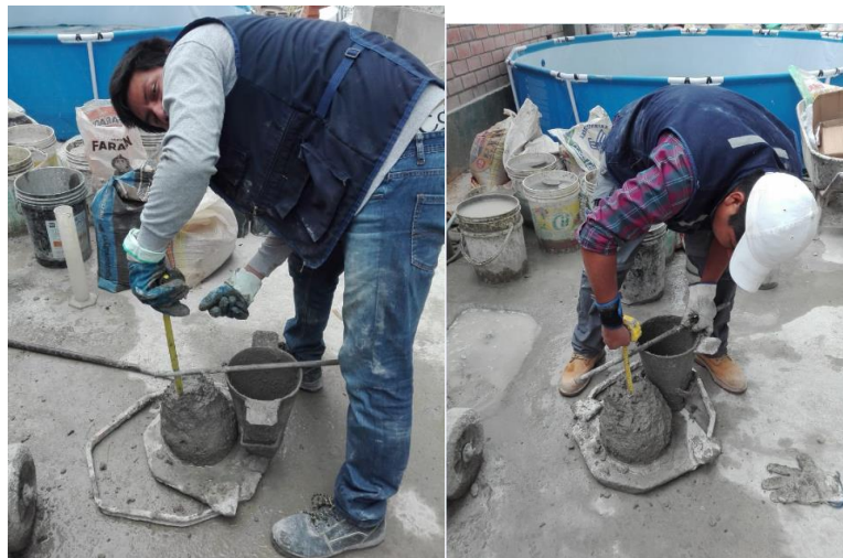
Figura. 17: Determinación del Slump Fuente: Elaboración propia
