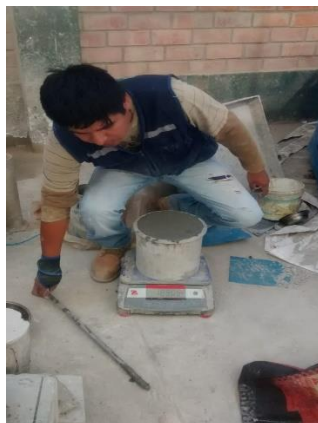
Figura. 18 Peso unitario del concreto fresco Fuente: Elaboración propia
