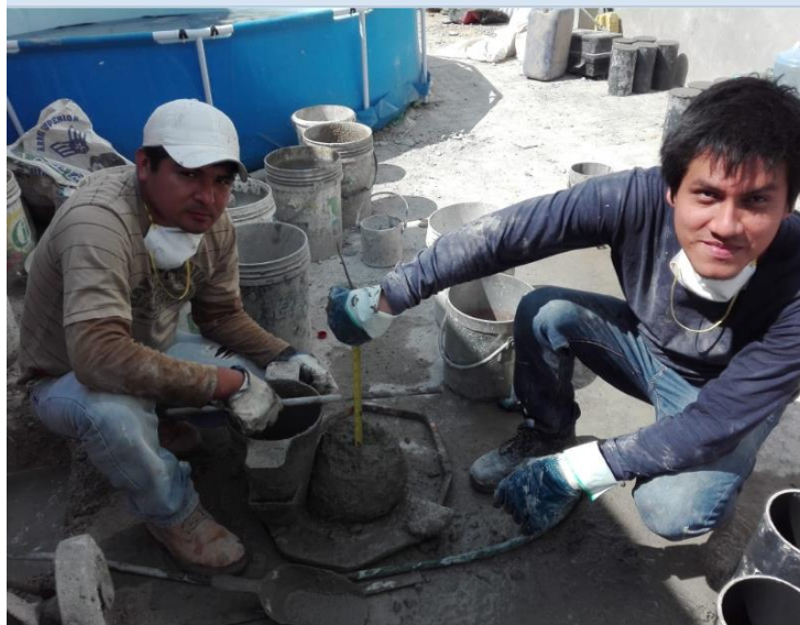
Figura. 15 Diseño y verificación del asentamiento para diseño de mezcla del concreto patrón Fuente: Elaboración propia
