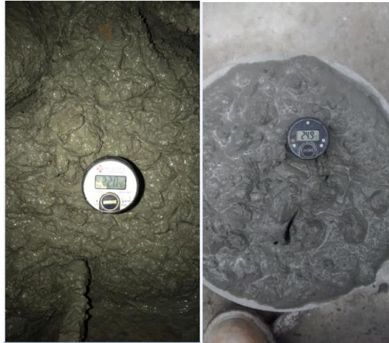
Figura. 20 Medición de la temperatura de la mezcla Fuente: Elaboración propia
