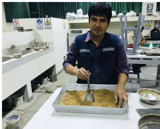
Figura. 6: Compactación del material Fuente: Elaboración propia
