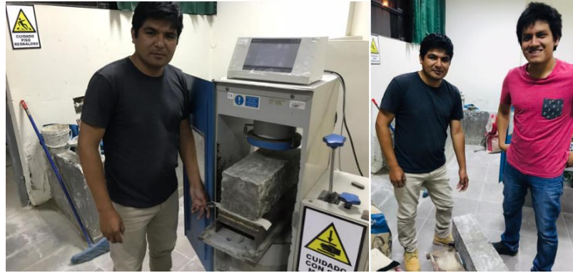
Figura. 23 Ensayo a flexión en vigas
