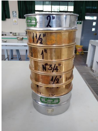
Figura 7: Tamices estandarizados para la granulometría de agregado grueso para diseño de concreto
