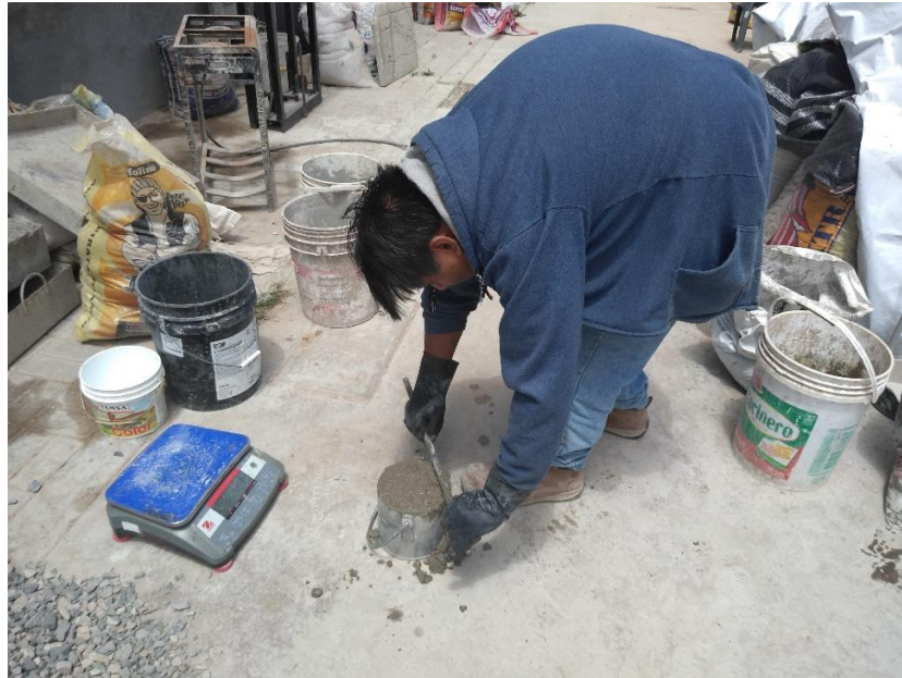
Figura 20: Evaluación del peso unitario de la mezcla de concreto.
