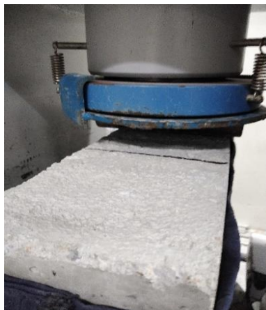
Figura 28: Ensayo de resistencia a la flexión del concreto con carga al centro de luz.
