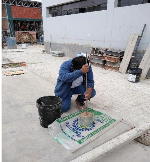
Figura 10: Realización del peso unitario compactado del agregado fino.
