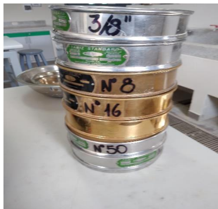
Figura 4: Tamices estandarizados para la granulometría de agregado fino para diseño de concreto
