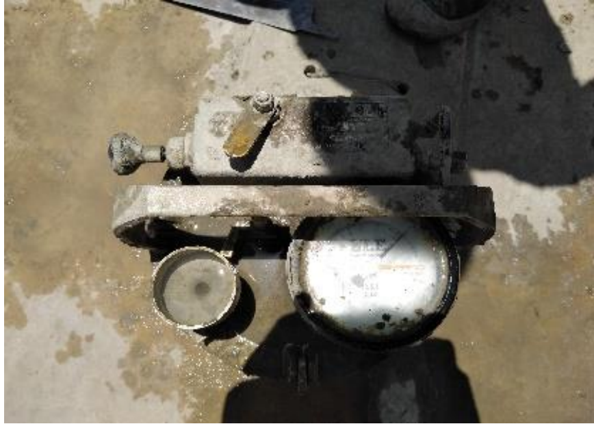
Figura 21: Evaluación del contenido de aire atrapado en la mezcla de concreto.
