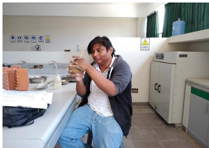
Figura 14: Realización del ensayo de peso específico del agregado fino.
