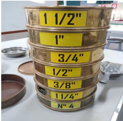
Figura 16: Mallas establecidas para el ensayo de degradación del agregado grueso.
