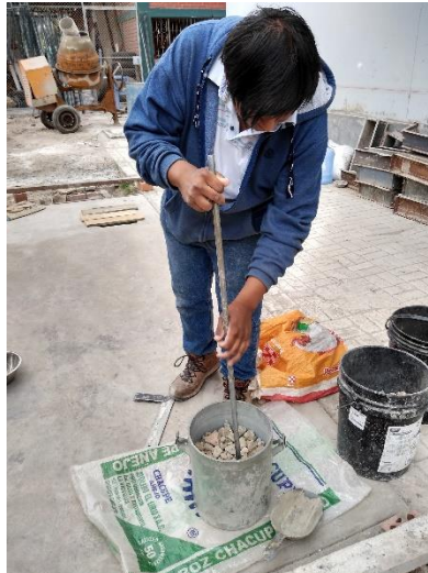
Figura 11: Realización del peso unitario compactado del agregado grueso.
