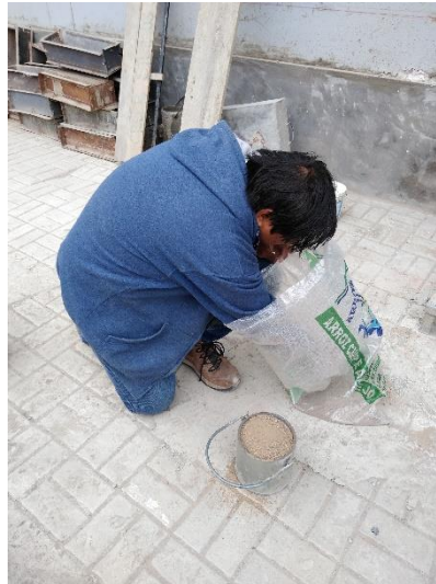
Figura 9: Realización del peso unitario suelto del agregado fino.
