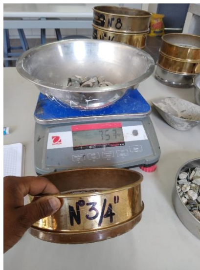
Figura 8: Peso del material retenido en el tamiz N°3/4”
