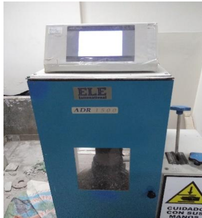
Figura 27: Ensayo de resistencia a la compresión del concreto en muestras cilíndricas.
