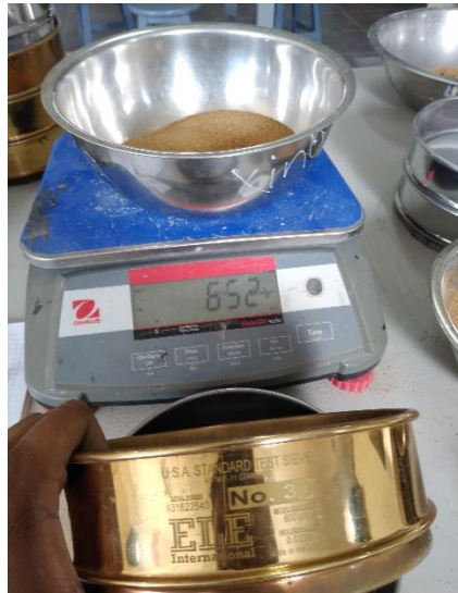
Figura 5: Peso del material retenido en el tamiz N°30
