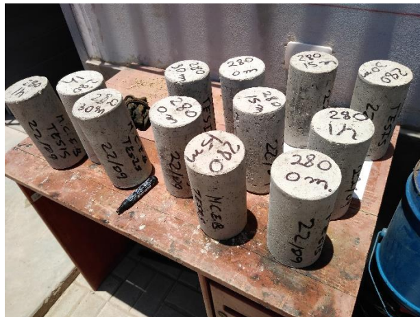
Figura 22: Elaboración de probetas cilíndricas f'c=280\text{kg/cm}^2 .
