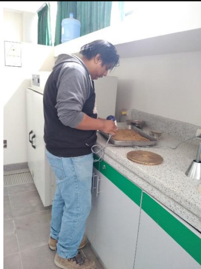
Figura 13: Realizando el secado superficial del agregado fino.
