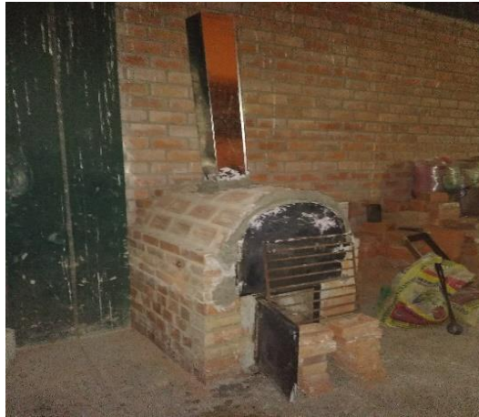
Figura 24: Horno artesanal utilizado para el ensayo de exposición al fuego.
