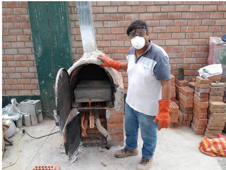
Figura 26: Exposición de las vigas de concreto armado al fuego.
