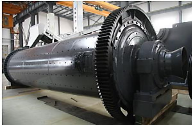
Ilustración 4. Molino de Bolas
