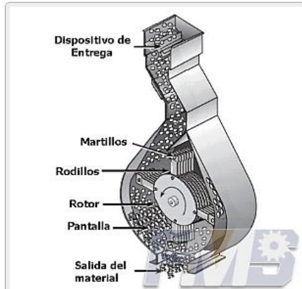
Ilustración 6. Molino de Martillos.
