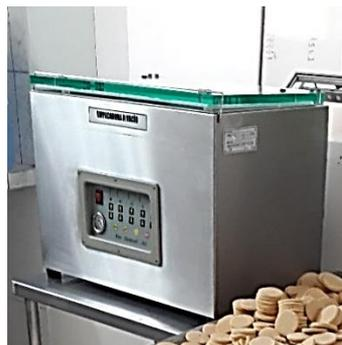
**Figura 27:** Empacadora al vacío.
