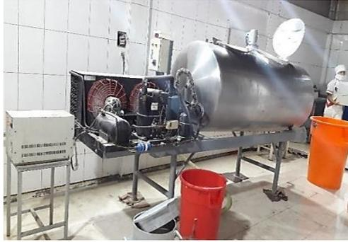
**Figura 17:** Tanque cilíndrico horizontal de leche.
