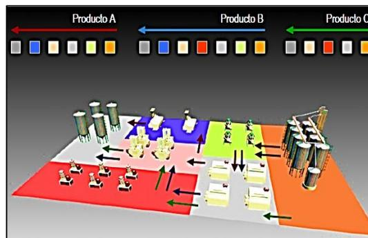
**Figura 2:** Distribución en planta por proceso.
