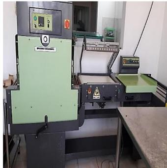
**Figura 25:** Selladora en “L” semi automática con túnel.
