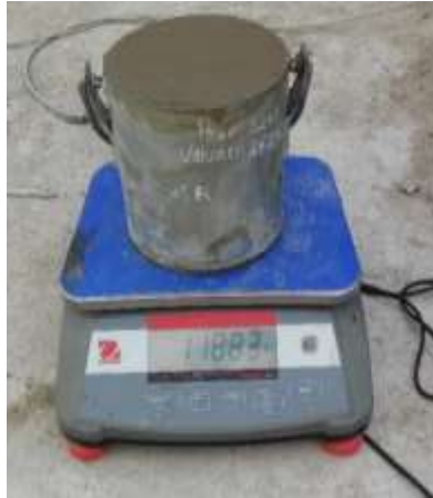
Figura 47. Realización del ensayo de peso unitario del concreto fresco.
