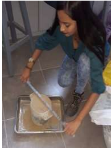
Figura 26. Eliminación de material excedente para peso unitario del agregado fino.
