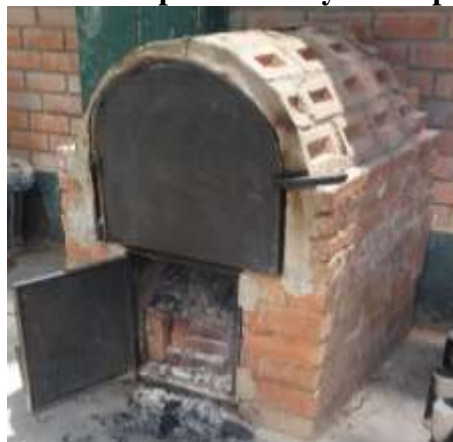
Figura 50. Horno artesanal utilizado en la investigación.
