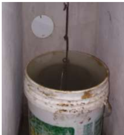
Figura 33. Muestra del agregado grueso sumergida en canastilla con agua.
