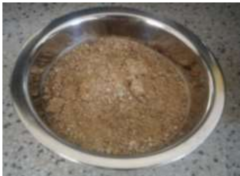
Figura 29. Muestra de agregado fino después de haber saturado 24 horas.
