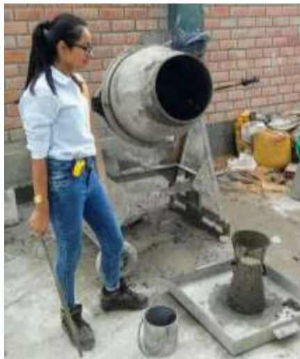
Figura 43. Ensayo de asentamiento del concreto.
