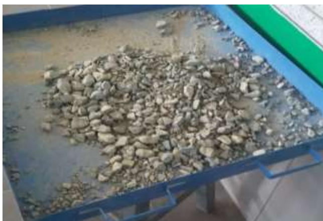
Figura 40. Muestra de piedra después de ser ensayada en la Máquina de Los Ángeles.
