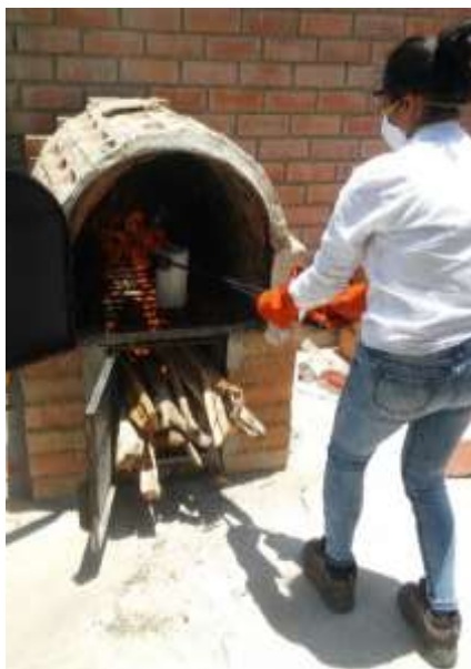
Figura 53. Introducción y exposición al fuego de muestras de vidrio sódico cálcico.
