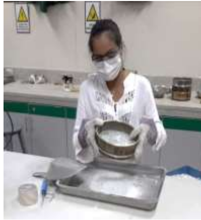
Figura 24. Tamizado de vidrio sódico cálcico triturado y molido.
