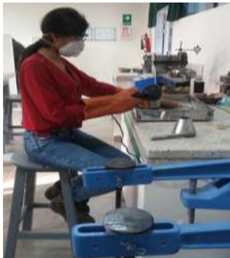
Figura 35. Secado de vidrio para obtener una muestra saturada superficialmente seca.
