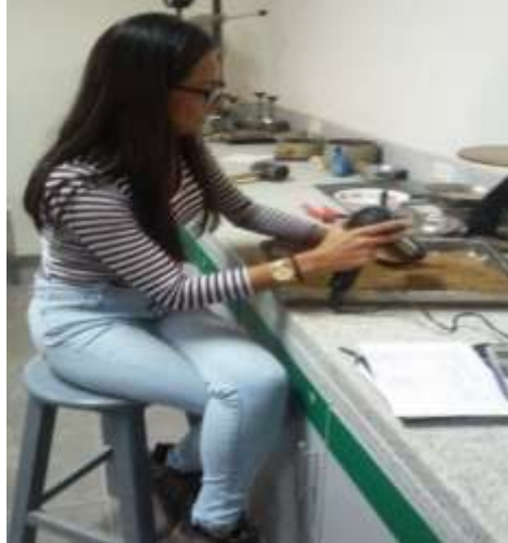
Figura 30. Secado de agregado fino para obtener una muestra saturada superficialmente seca.
