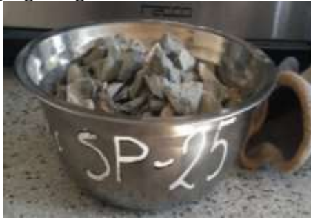
Figura 37. Muestra de agregado grueso secada por 24 horas en un horno.
