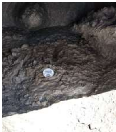
Figura 45. Temperatura de mezclas de concreto en estado fresco.
