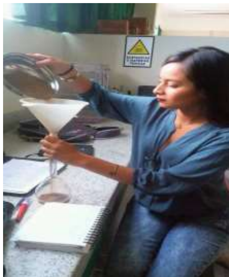
Figura 31. Obtención del volumen del agregado fino por el método gravimétrico.
