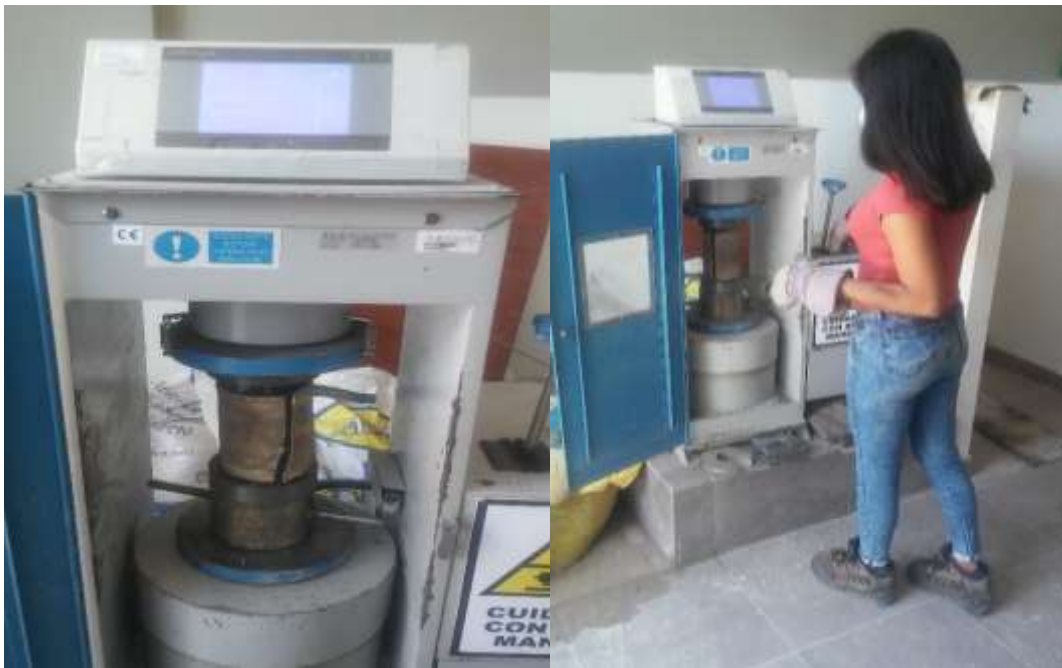
Ensayo de resistencia a la compresión de muestras cilíndricas de concreto después de haber sido sometidas al fuego a los 28 días de edad.
