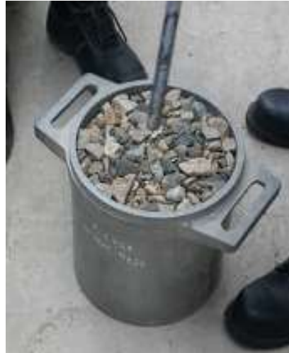
Figura 27. Vaciado de muestra de agregado grueso al molde de peso unitario.
