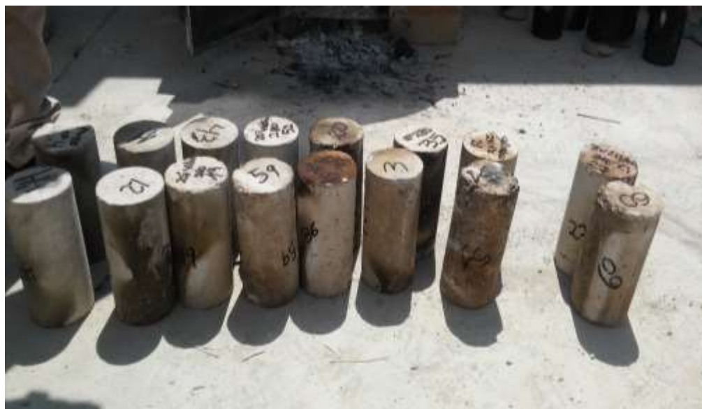
Muestras extraídas después de haber sido sometidas al fuego durante 30 minutos.
