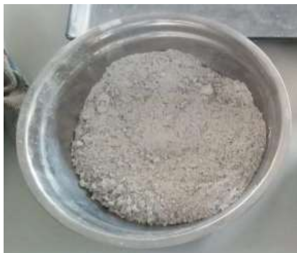
Figura 8. Resultado del vidrio molido obtenido a través de la Maquina de los Ángeles en el Laboratorio de la Universidad Señor de Sipán.
