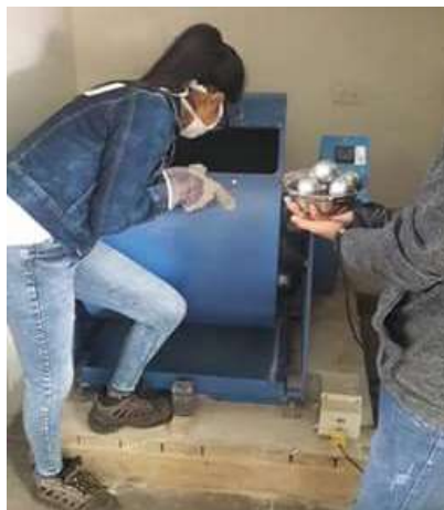
Figura 23. Ingreso de envases de vidrio a la Máquina de Los Ángeles para su trituración y molienda.
