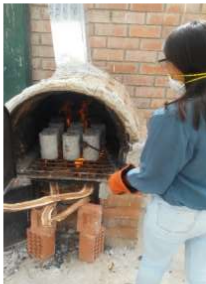
Figura 52. Introducción y exposición al fuego de muestras de caucho.
