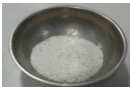
Figura 39. Muestra de vidrio sódico cálcico secada por 24 horas en un horno.
