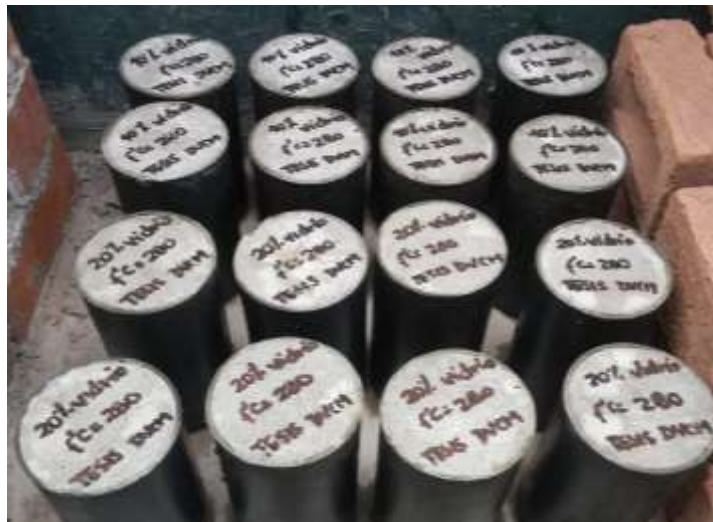
Figura 48. Elaboración y curado de especímenes de concreto.
