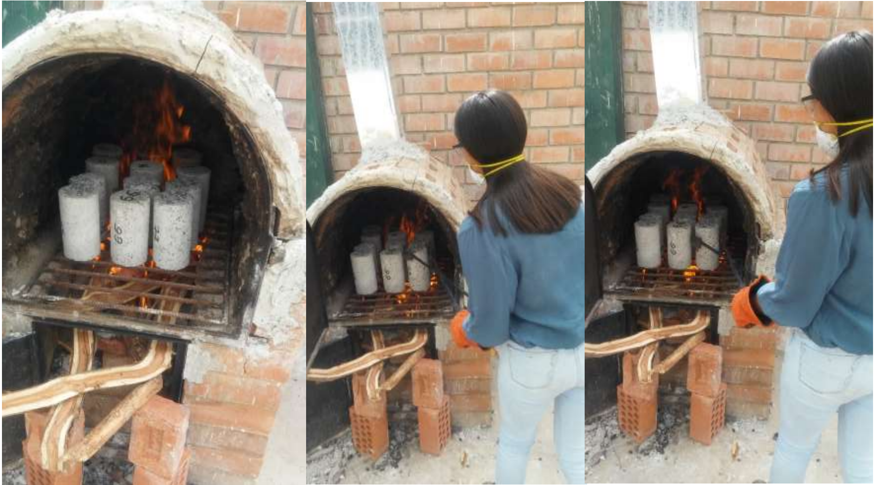
Quemado de probetas de concreto patrón y concreto con caucho a 15, 30 y 60 minutos.
