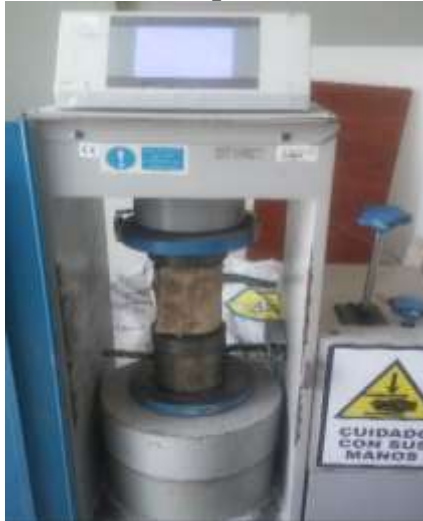
Figura 49. Ensayo de resistencia a la compresión de testigos de concreto.
