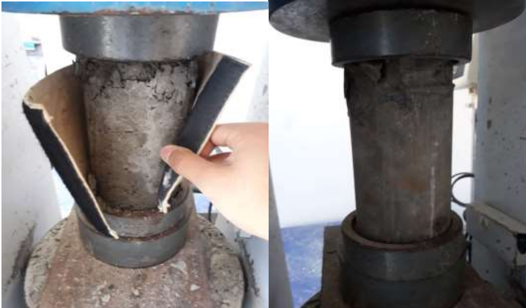
Ensayo de resistencia a la compresión de muestras cilíndricas de concreto a los 7, 14, 21 y 28 días de edad.
