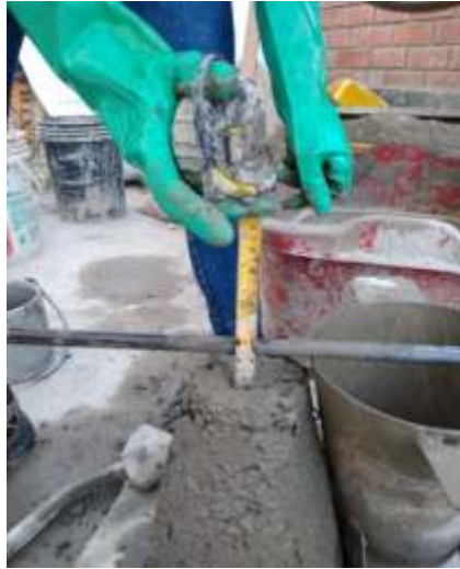
Figura 44. Prueba de asentamiento con el cono de Abrams.
