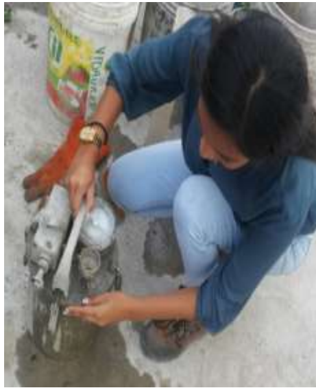
Figura 46. Realización del ensayo de contenido de aire atrapado en la mezcla de concreto.
