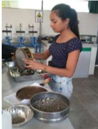
Figura 20. Granulometría de agregado fino.
