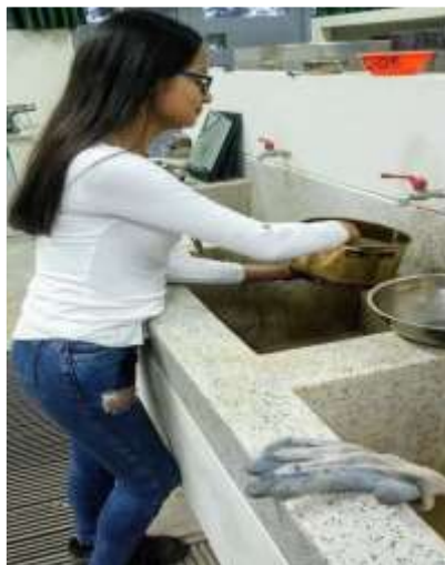
Figura 19. Lavado de muestra de agregado fino en la malla N.º 200.
