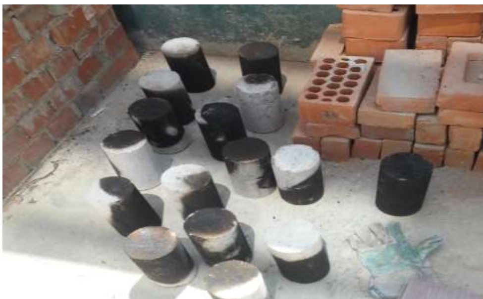
Muestras extraídas después de haber sido sometidas al fuego durante 60 minutos.
