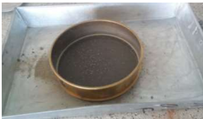
Figura 41. Agregado grueso tamizado por la malla N° 12.
