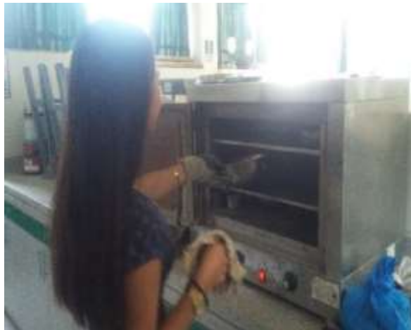
Figura 36. Extracción de la muestra de agregado fino después de haberse sometido a secado por 24 horas en un horno.
