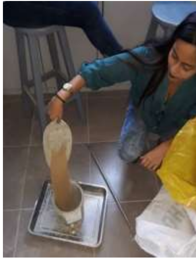
Figura 25. Vaciado de muestra de agregado fino al molde de peso unitario.
