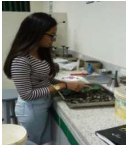
Figura 32. Secado del agua de la superficie de las partículas de agregado grueso.
