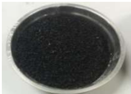
Figura 38. Muestra de caucho secada por 24 horas en un horno.
