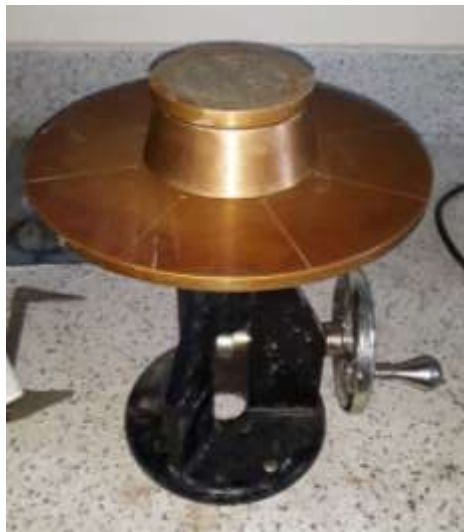
Figura 47. Mezcla de mortero colocada adentro del tronco cónico en la mesa de fluidez.
