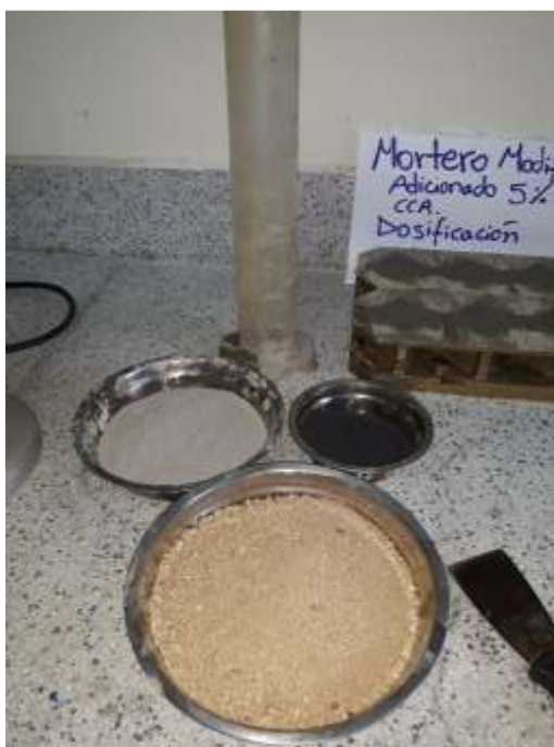
Figura 45. Materiales a emplear en las dosificaciones del diseño de mezcla del mortero.
