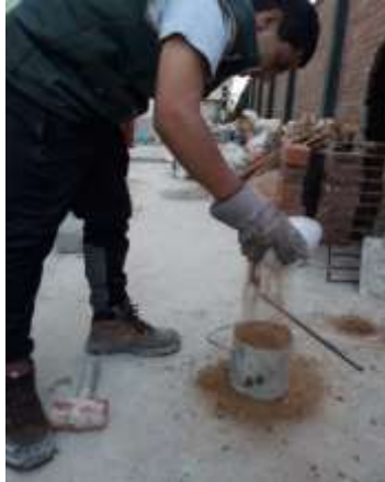
Figura 29. Descarga del agregado fino en el recipiente.
