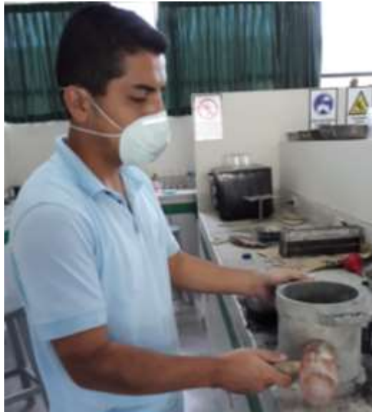
Figura 18. Compactando la capa de cenizas de cáscaras de arroz usando la comba de goma.
