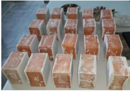
Figura 43. Muestras listas para ser ensayadas en la compresora hidráulica.
