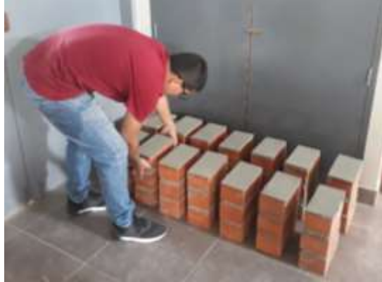
Figura 61. Pilas de albañilería con su capping en ambas caras de sus superficies.
