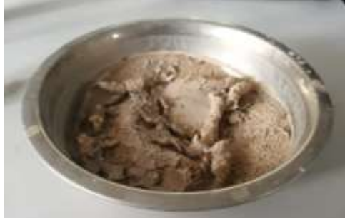
Figura 28. Agregado fino seco después de 24 horas de colocado en el horno.
