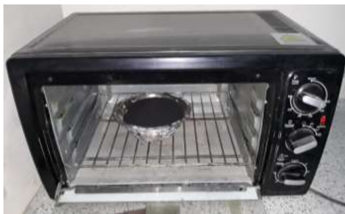
Figura 22. Cenizas de cáscaras de arroz colocado en el horno durante 24h.
