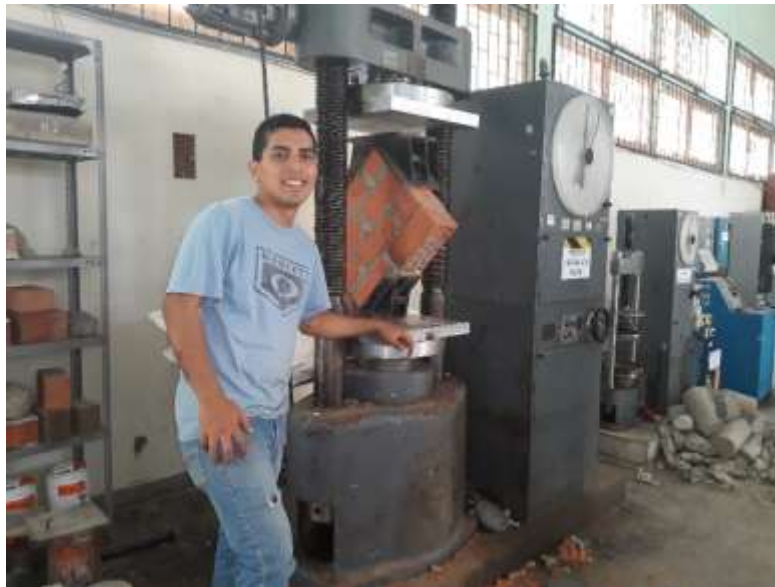
Figura 65. Ensayo de compresión diagonal en muretes de albañilería.
