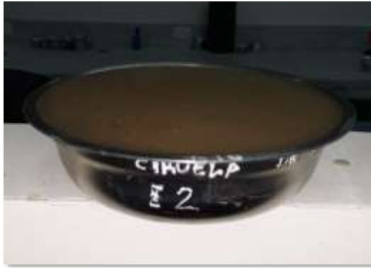
Figura 25. Saturación del agregado fino durante 24h.
