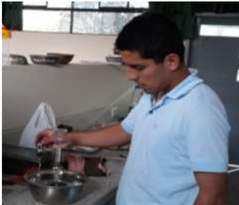
Figura 21. Baño maría del frasco Le Chatelier y tomando la temperatura para obtener la Lf.
