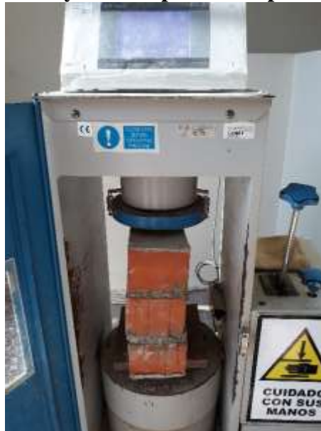
Figura 62. Ensayo de resistencia a la compresión de elementos de albañilería.
