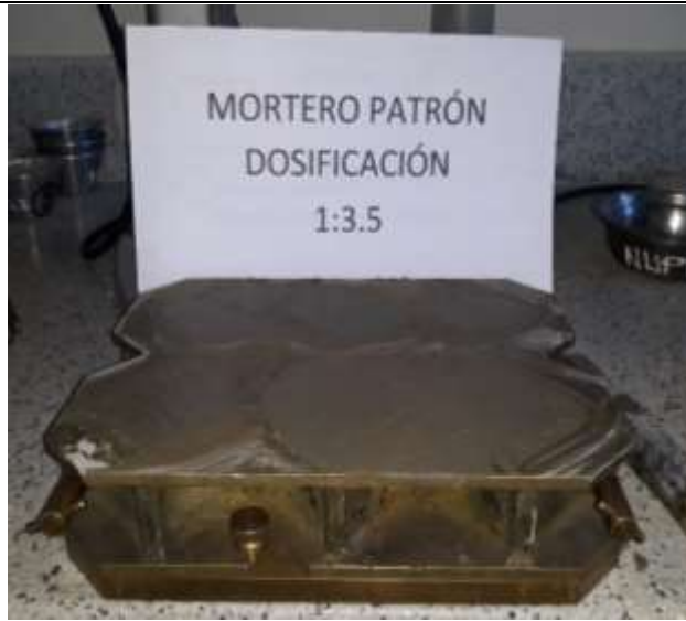
Figura 53. Elaboración de los especímenes de mortero en los moldes cúbicos.
