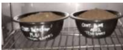
Figura 33. Muestra colocada en el horno durante 24 horas.
