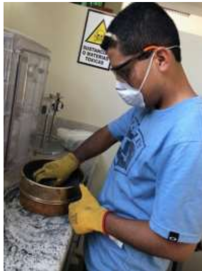
Figura 5. Equipos de protección individual necesarios para realizar ensayos de materiales.
