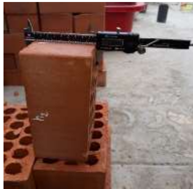
Figura 39. Medición de la superficie de asiento usando el vernier electrónico.
