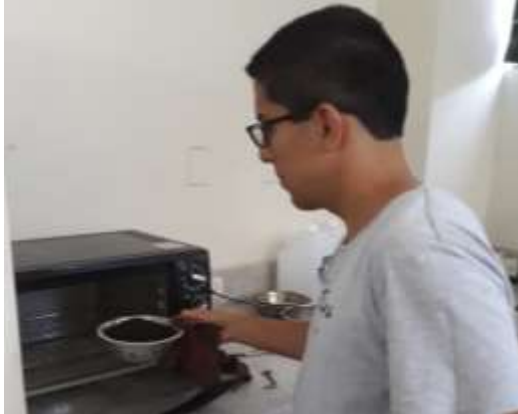
Figura 23. Cenizas de cáscaras de arroz extraído del horno después de 24 h.
