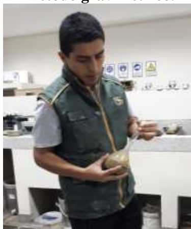
Figura 27. Volumen del agregado fino por el método gravimétrico.
