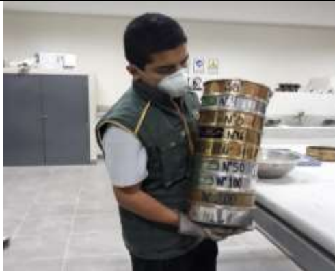
Figura 24. Análisis granulométrico por las distintas mallas normalizadas.
