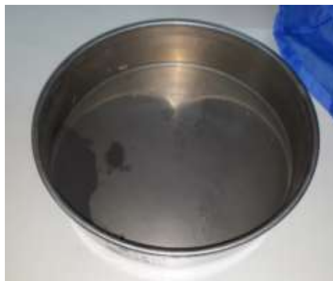
Figura 14. Cenizas de las cáscaras de arroz después de ser tamizada por la Malla N° 200.
