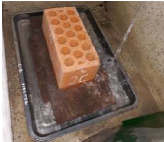
Figura 40. Ensayo de succión de los ladrillos.
