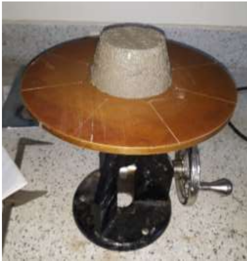
Figura 48. Mezcla de mortero después de retirar el recipiente tronco cónico.
