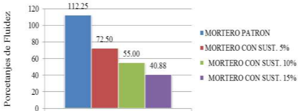
Figura 72. Resultado en barras del ensayo de fluidez de la dosificación P1 (1:3.5), mortero patrón y sustituido con CCA.
