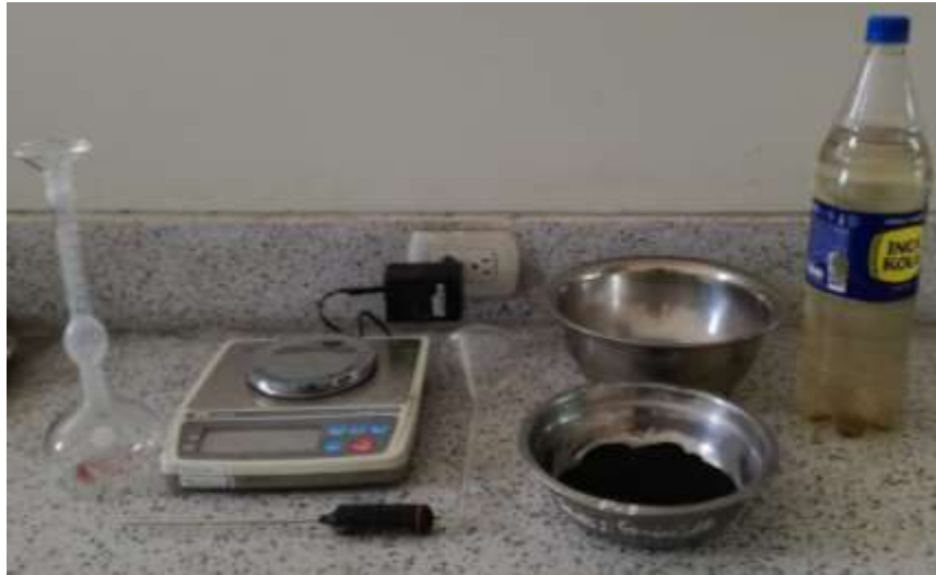
Figura 19. Material y equipo utilizado para realizar el ensayo de peso específico de las CCA.
