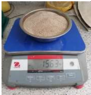
Figura 36. Se pesa la arena retenida en los orificios para poder obtener su densidad.
