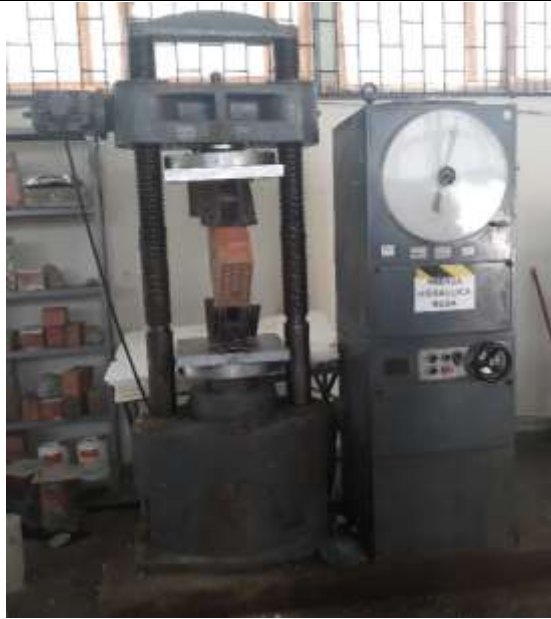
Figura 64. Prensa hidráulica en donde los muretes fueron ensayados.
