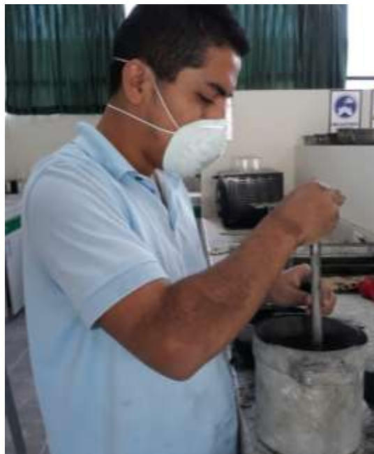
Figura 17. Apisonamiento de las cenizas de cáscaras de arroz utilizando la varilla.
