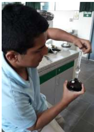
Figura 20. Extracción del aire atrapado en el frasco Le Chatelier.
