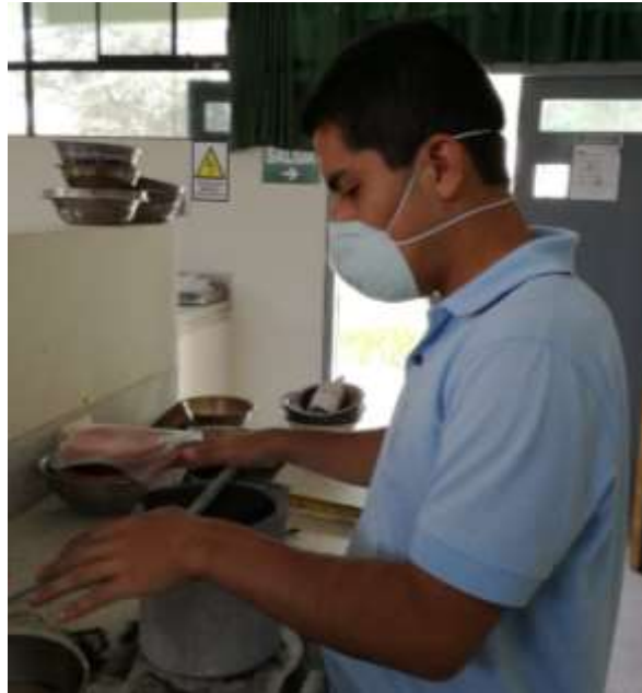
Figura 16. Enrasado del material para ser nivelado y posteriormente pesado.
