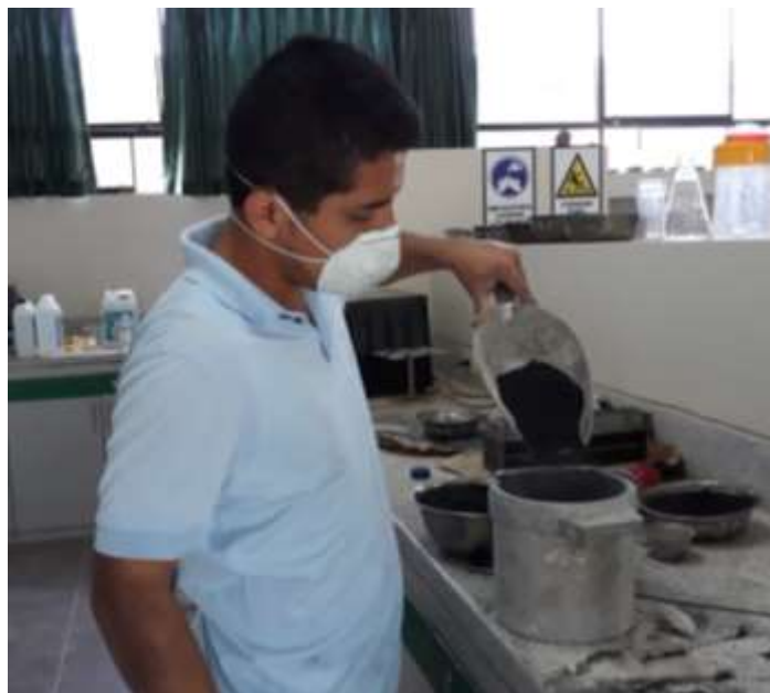
Figura 15. Descarga de las cenizas de cáscaras de arroz en el recipiente.
