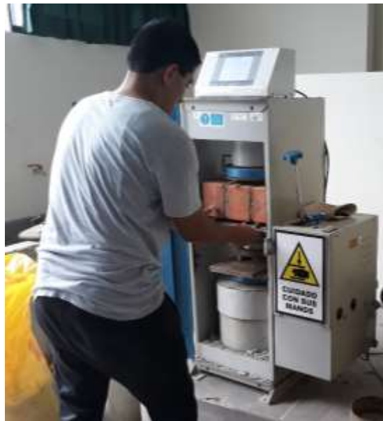
Figura 60. Ensayo de resistencia a la adherencia por flexión de elementos de albañilería.
