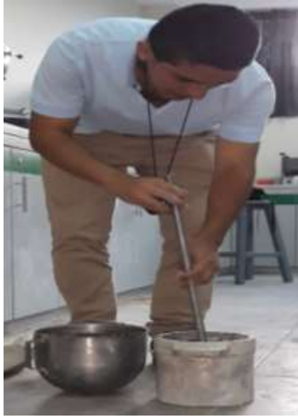
Figura 51. Llenado y compactado del recipiente con mortero.
