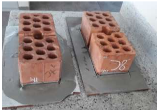
Figura 42. Colocación de capping a los distintos ladrillos a ensayar.
