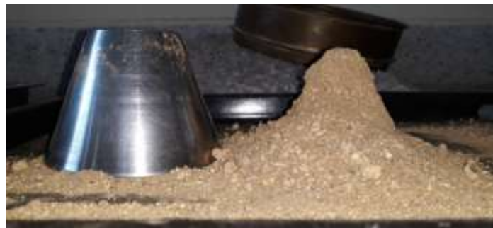
Figura 26. Muestra del agregado fino saturada superficialmente seca.
