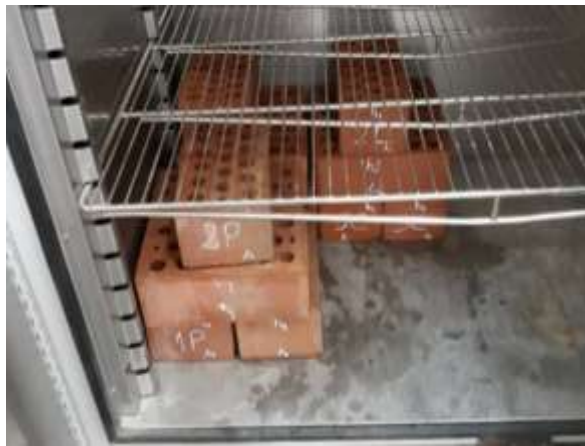
Figura 37. Secado de los ladrillos en el horno a 110 °C durante 24 horas.
