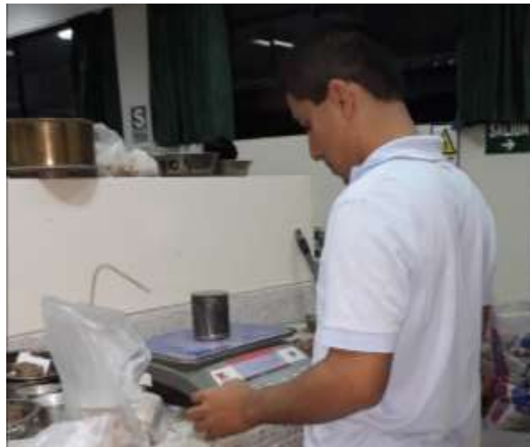
Figura 50. Peso del recipiente metálico con la muestra para calcular el contenido de aire.
