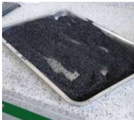
Figura 13. Cenizas de cáscaras de arroz obtenido directo del horno de fundición.
