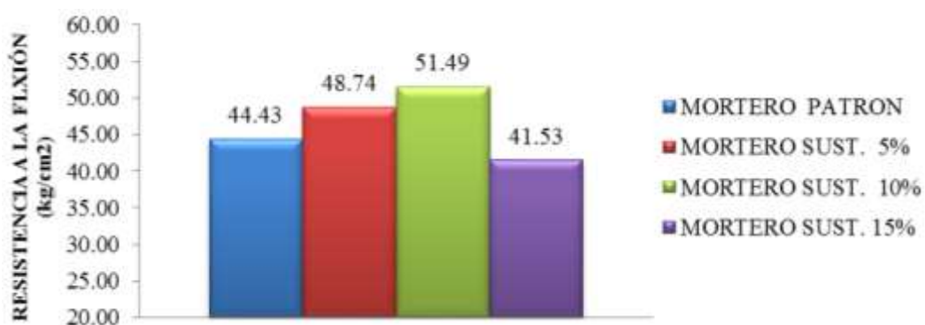
Figura 111. Resultado en barras del ensayo de resistencia a la flexión en la dosificación P2 (1:4), mortero patrón y sustituido con CCA.
