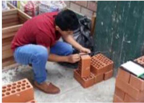
Figura 34. Tomando medidas de las caras del ladrillo utilizando el vernier electrónico.
