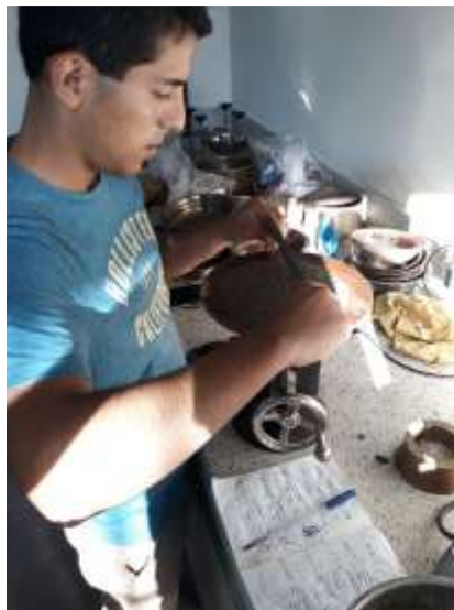
Figura 49. Tomando las 4 medidas diametrales para determinar la fluidez del mortero.
