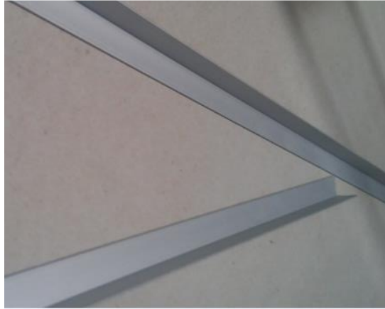
Figura 27. Ángulos de aluminio para el tanque de almacenamiento.
