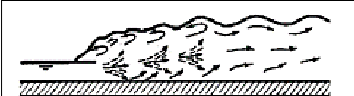
Figura 11. Resalto hidráulico Oscilante.
