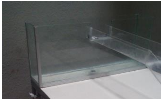
Figura 28. Tanque de almacenamiento aguas arriba.
