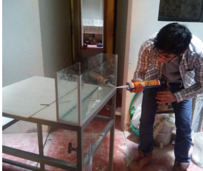
Figura 42. Sellado de tanque de almacenamiento con silicona.
