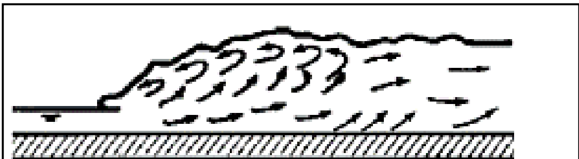
Figura 12. Resalto hidráulico Estable.
