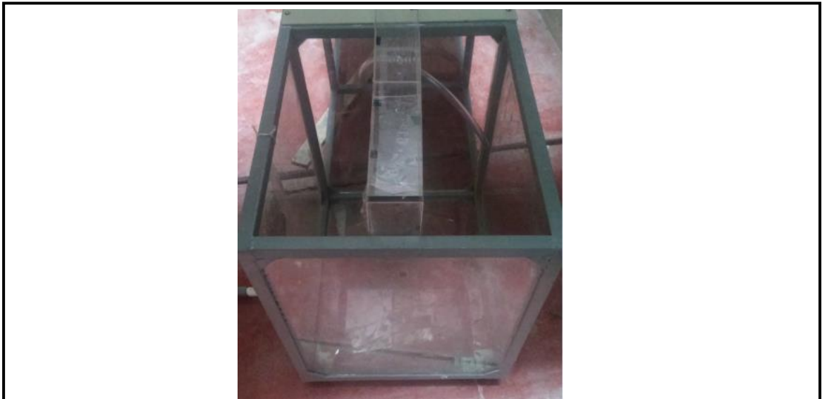
Figura 29. Tanque de almacenamiento aguas abajo.
