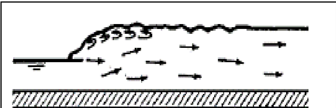
Figura 10. Resalto hidráulico Débil.
