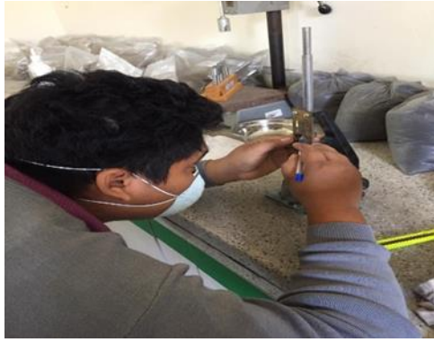
Figura 24: Lectura de las penetraciones con la aguja de Vicat.
