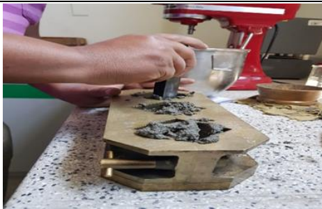
Figura 27: Moldeado de los cubos de mortero de 50 mm de lado.
