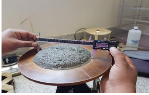
Figura 26: Mesa de flujo para determinar la fluidez del mortero.
