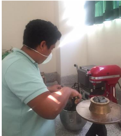
Figura 29: Preparación del mortero para posterior ensayo.
