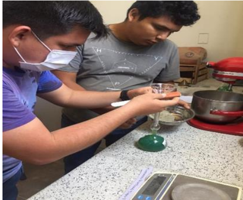
Figura 16: Deposición de los 64 g de cemento portland tipo I.
