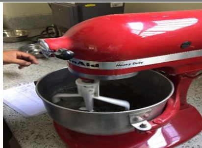
Figura 21: Preparación de pasta de cemento portland.
