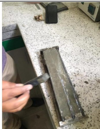
Figura 30: Moldeo de los especímenes de mortero en las barras.
