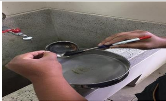
Figura 18: Depósito de los 1.000 g de cemento portland tipo I.
