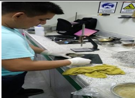
Figura 23: Colocación del espécimen en el tronco cónico.
