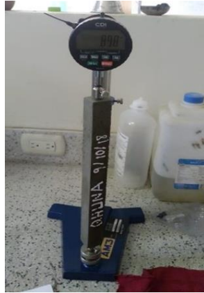
Figura 31: Lectura de los especímenes en el equipo comparador de longitud.
