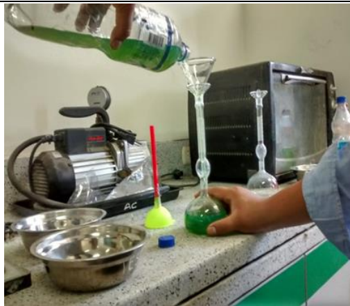
Figura 14: Llenado del Frasco Le Chatelier con kerosene.
