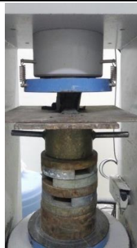
Figura 28: Determinación de la resistencia a la compresión de los cubos de mortero de 50 mm de lado.
