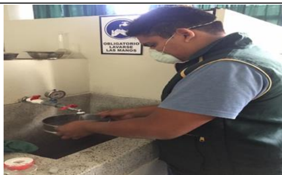
Figura 19: Lavado de la muestra bajo el rociador del aspersor.
