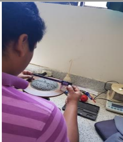
Figura 32: Fluidez de la muestra en la mesa de Flujo.
