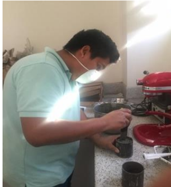
Figura 33: Llenado de los moldes en capas.
