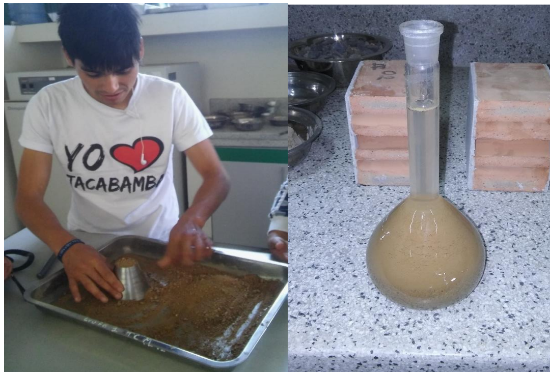
Foto 5: Peso específico del agregado fino. Norma N.T.P. 400.022 ó ASTM C-128
