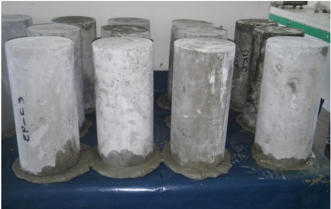
Foto 22: Aplicando mortero en ambas caras de muestras para ensayo de módulo de elasticidad del concreto.
