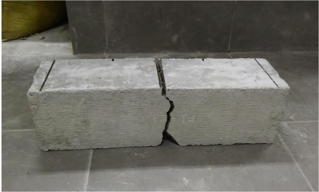
Foto 21: Modo de falla en muestras de concreto en resistencia a flexión.
