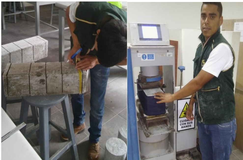
Foto 20; Rotura de muestras para ensayo de resistencia a la Flexión (NTP 339.078 o ASTM C-078)
