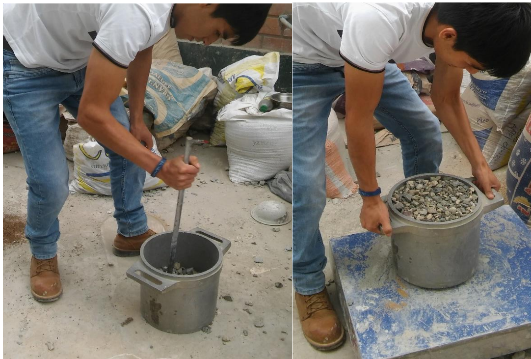
Foto 4: Peso unitario suelto y compactado del agregado grueso. Norma N.T.P. 400.017 ó ASTM C-29.
