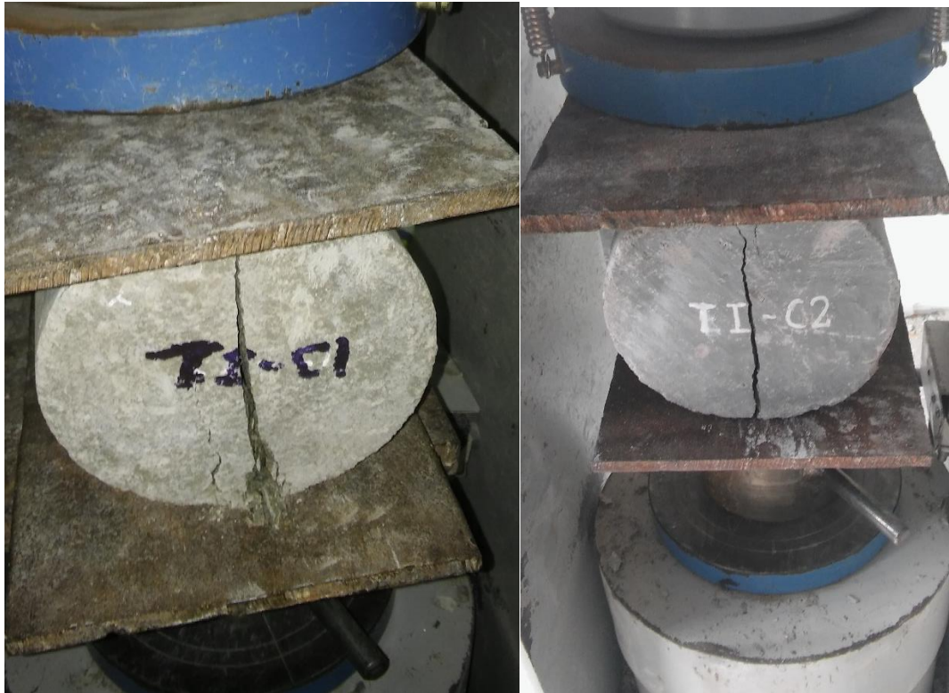
Foto 19: Modo de falla en muestras de concreto en resistencia a tracción.
