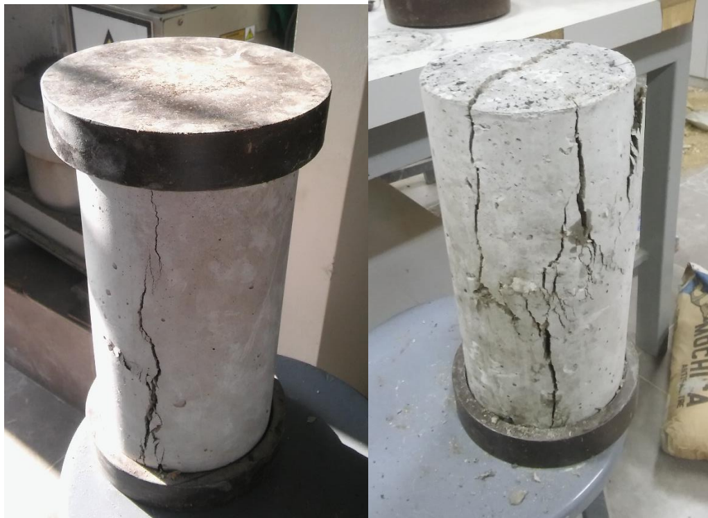
Foto 17: Modo de falla en muestras de concreto en resistencia a compresión.
