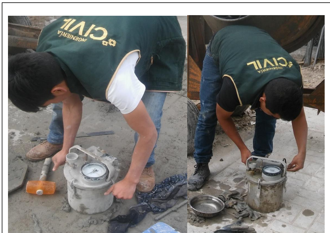
Foto 8: Contenido de aire atrapado en el concreto. NTP 334.089 o ASTM C-226
