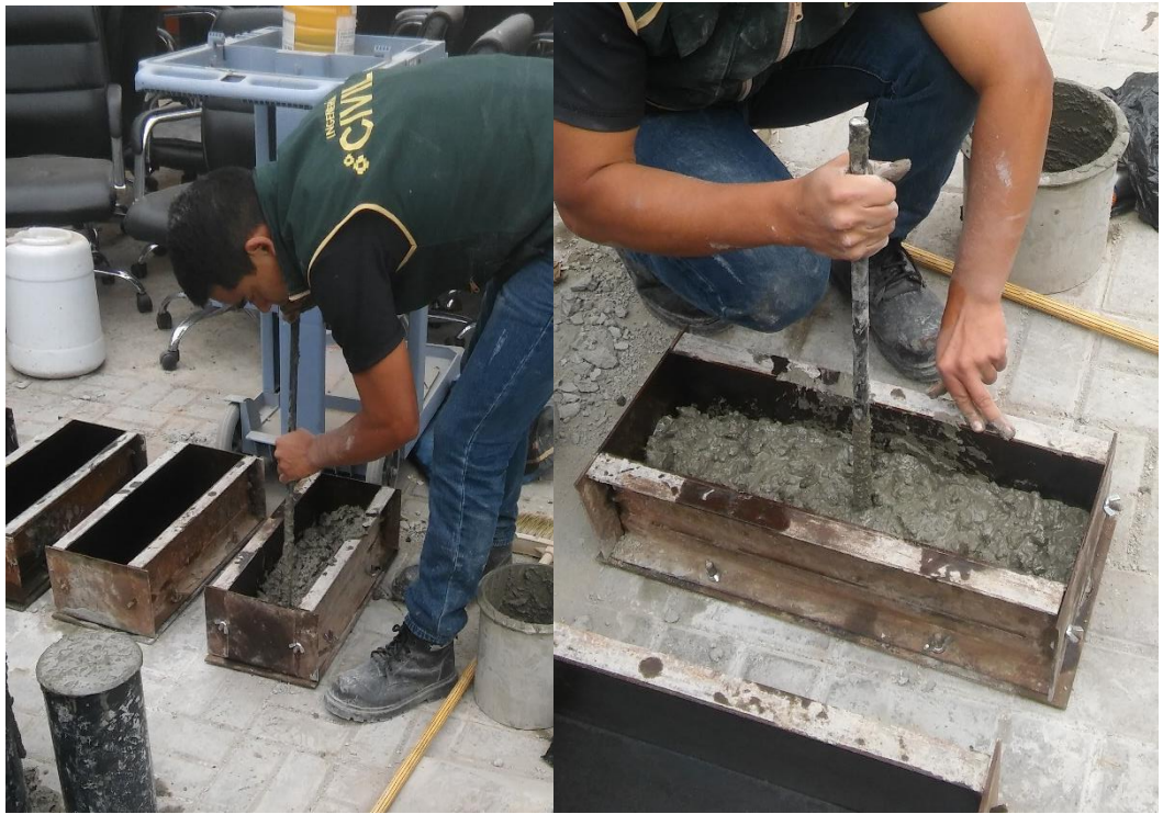
Foto 13: Vaciado de vigas, para ensayo de resistencia a flexión.
