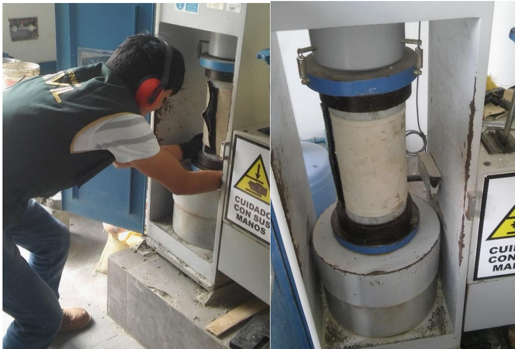
Foto 16: Rotura de muestras para ensayo de resistencia a la compresión (NTP 339.034 ó ASTM C-039)
