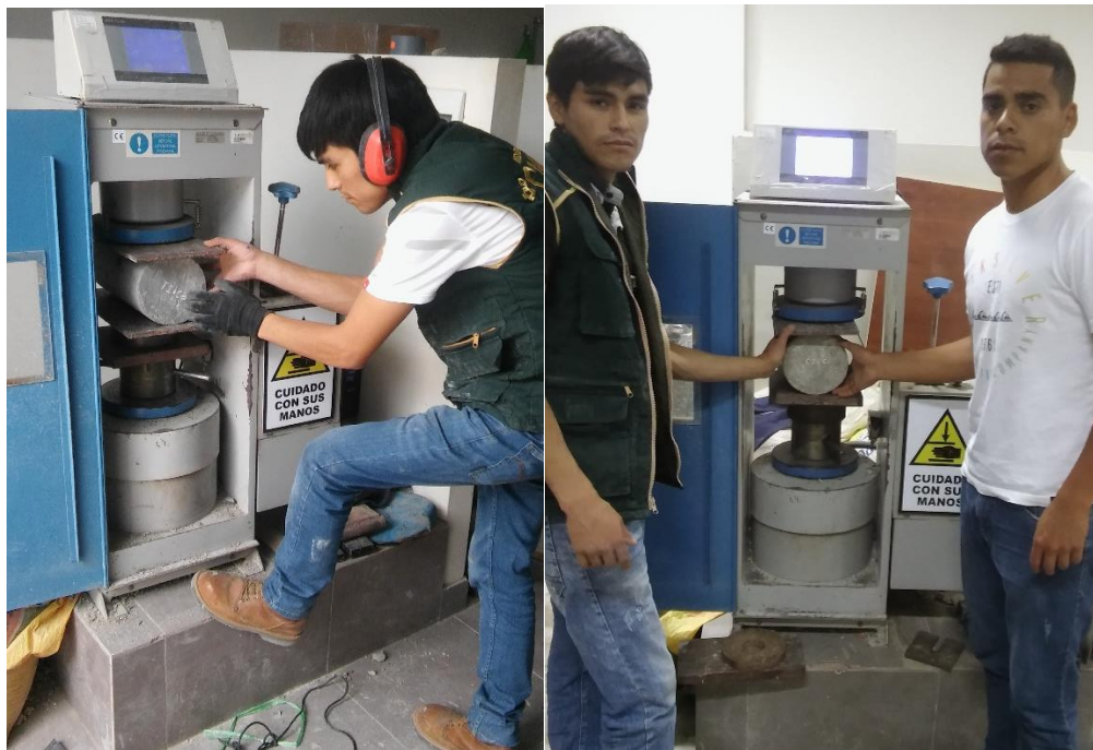
Foto 18: Rotura de muestras para ensayo de resistencia a la Tracción (NTP 339.084 ó ASTM C-348)
