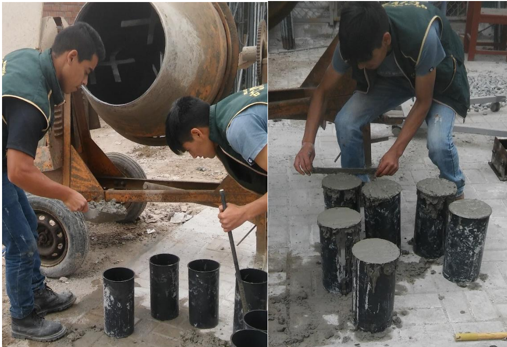
Foto 12: Vaciado de cilindros de concreto, para ensayos de compresión, tracción y elasticidad.
