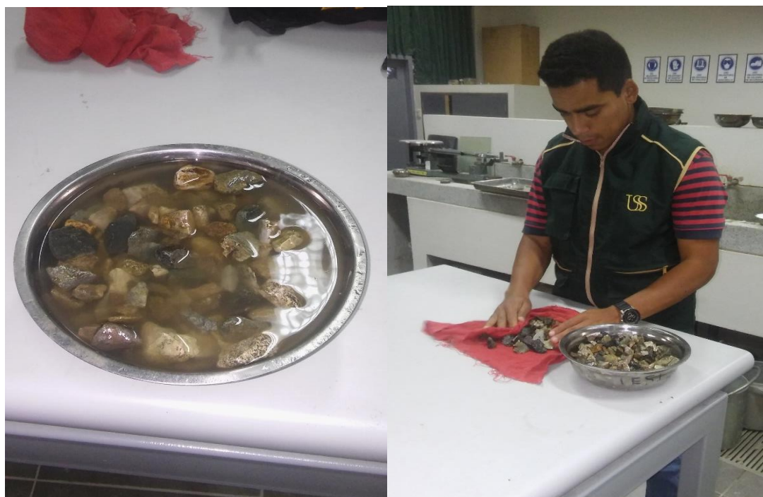
Foto 6: Peso específico del agregado grueso. Norma N.T.P. 400.021 ó ASTM C-127.
