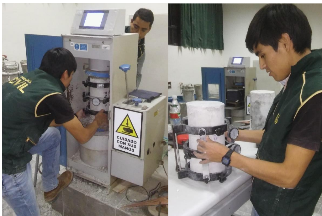
Foto 24: Ensayo de módulo de elasticidad (ASTM C-469)
