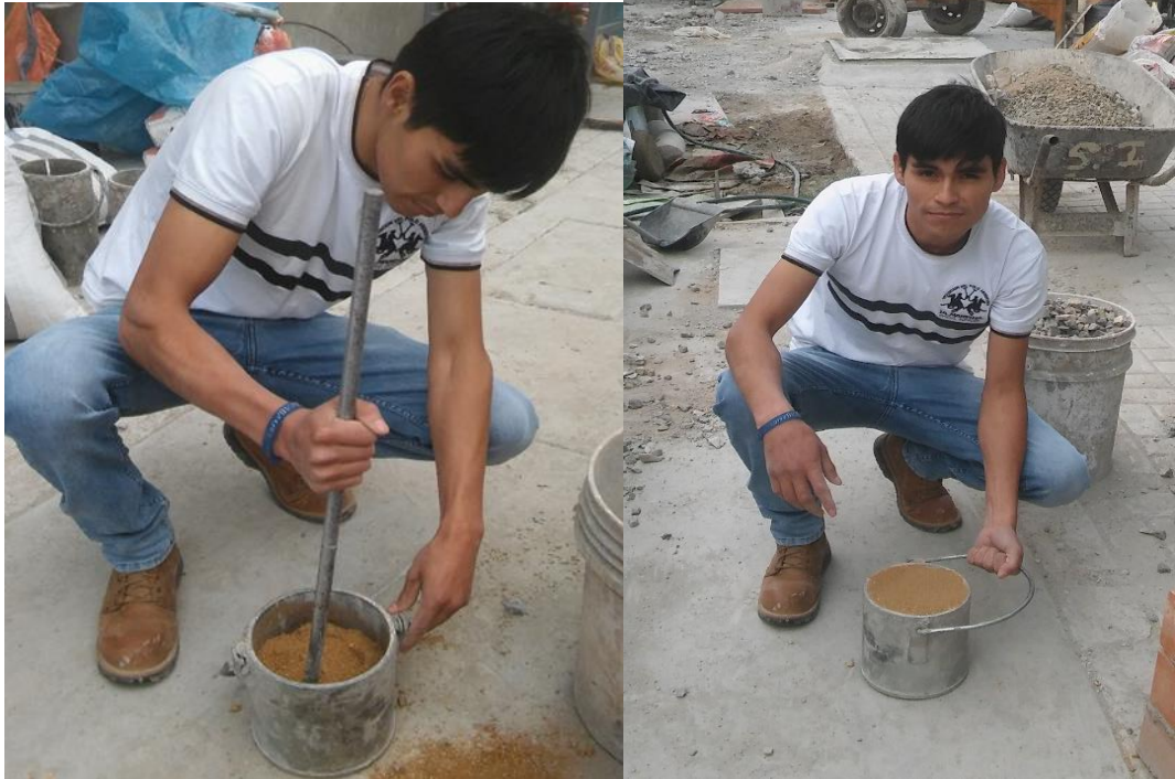
Foto 3: Peso unitario suelto y compactado del agregado fino. Norma N.T.P. 400.017 ó ASTM C-29.
