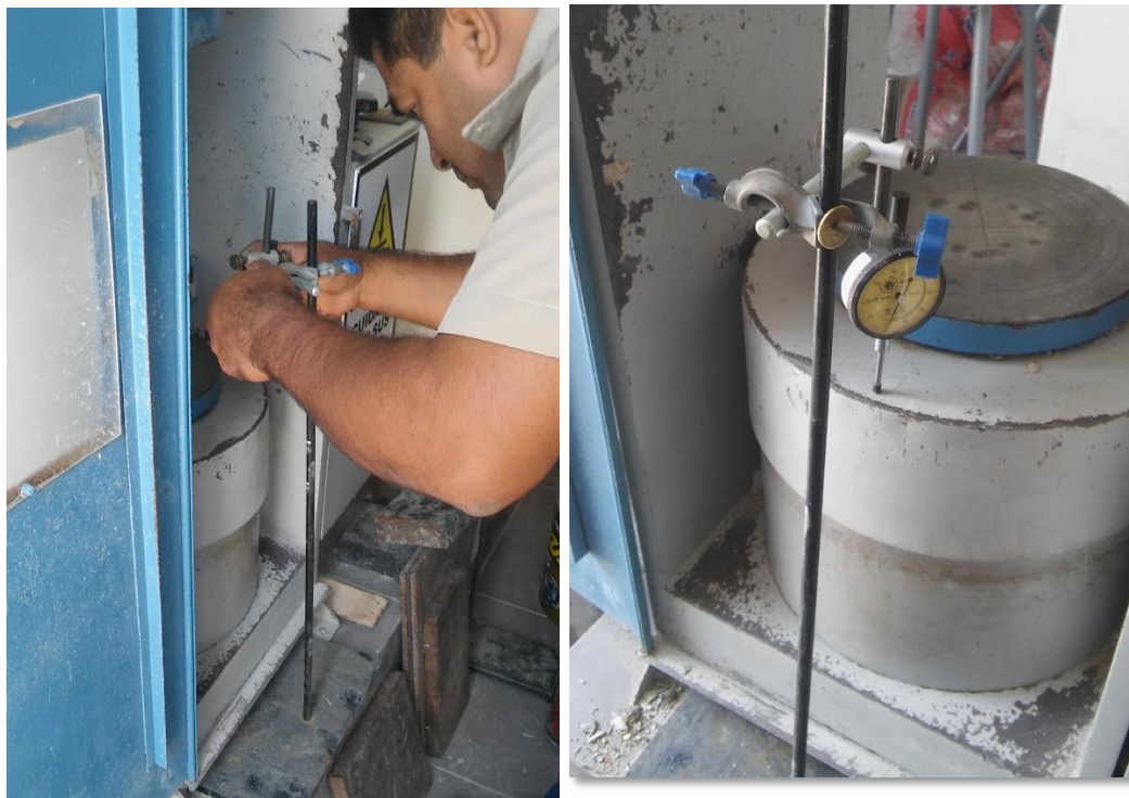
Foto 23: Calibración del equipo compresor a una velocidad de 1 mm/min, para ensayo de elasticidad del concreto (ASTM C-469).
